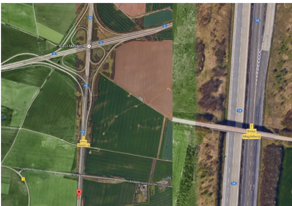
Bild 17: Beispiel einer Zählstelle im direkten Verflechtungsbereich (Fahrstreifenfaktor 22,4%)
