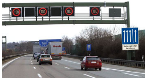
Bild 2: Beispiel einer temporären Seitenstreifenfreigabe (Foto: BAST)
