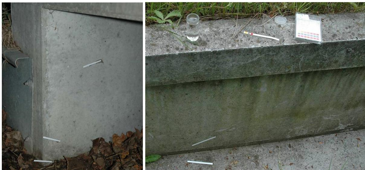
Abbildung 9: Bestimmung des pH-Wertes an verschiedenen Schutzanlageanteilen
