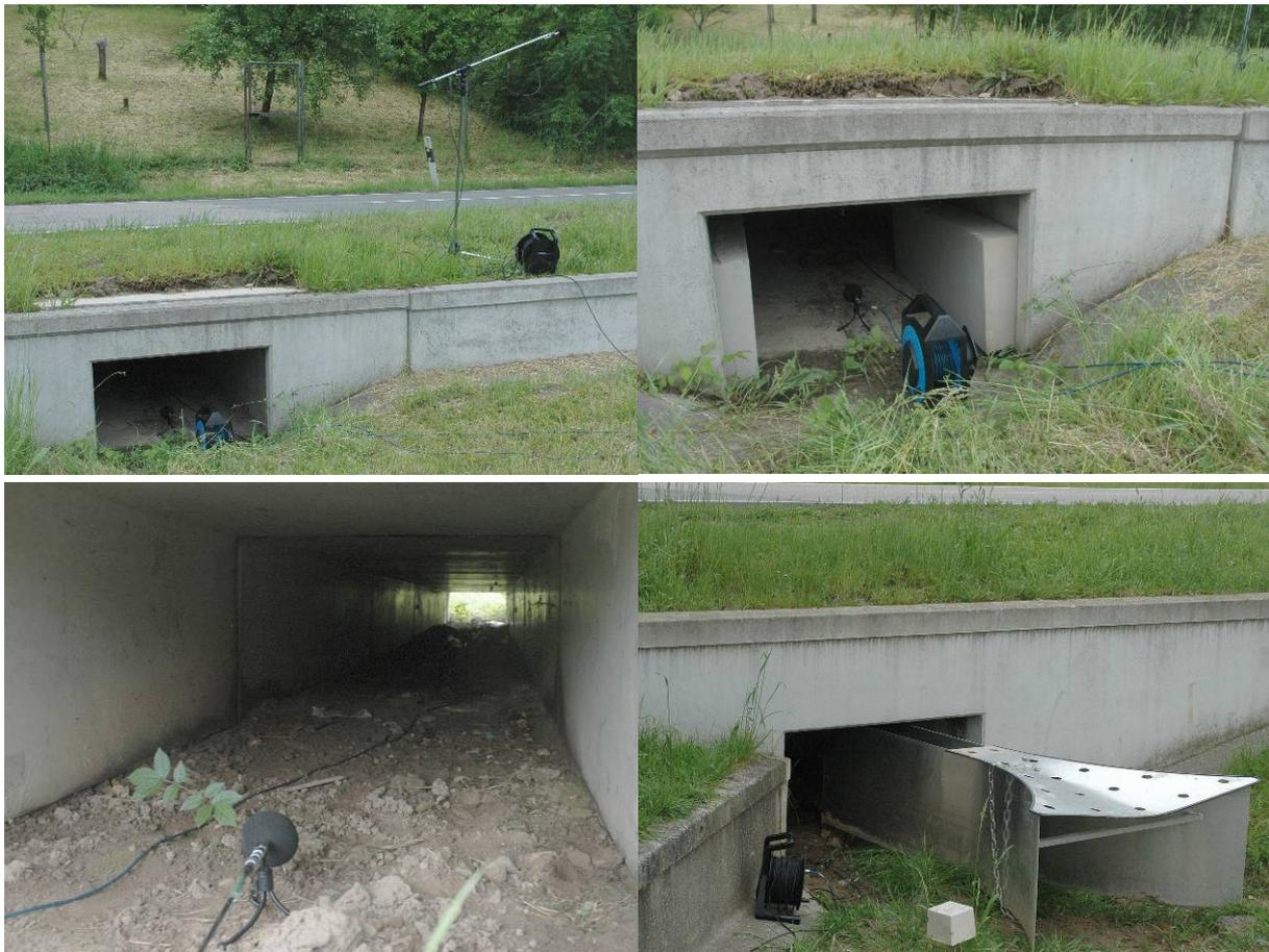
**Abbildung 13: Messungen des Schalldruckpegels in zwei Stelztunneln der Amphibienschutzanlage an der B 3 bei Karlsruhe**
