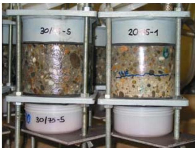
**Abbildung 10: Wasserdichte Abdichtung von Bohrprüfkernen im Labor des MPA Wiesbaden**
