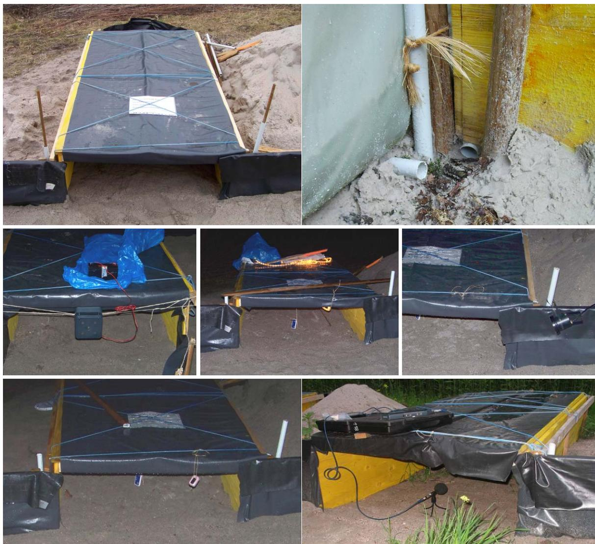
**Abbildung 21: Arenaversuchsaufbauten** (ferromagnetische Eisenstangen in Plastikrohren um den Tunneleingang herum angeordnet, Tischventilator verursacht Luftzug, Lichtschlauch beleuchtet Tunnelinnere, Lampe mit auf- und abschwelldem Licht am Tunneleingang, MPEG3-Player zur Abspielung von Verkehrsgeräuschen im Tunnel und Messung des erzeugten Schallpegels)
