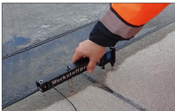
Bild 295: Plausibilität durch zusätzliche Messung mit einem Setzdehnungs-Messgerät (SDM)
