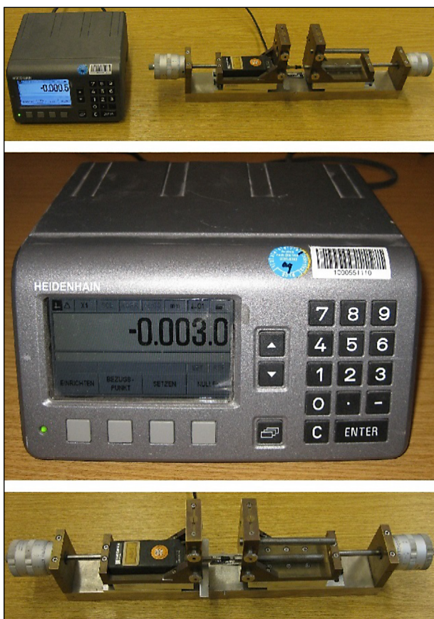
Bild 24: Vorrichtung zum Kalibrieren der induktiven Wegaufnehmer
