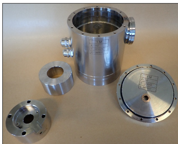
Bild 151: Alle freigelegten Komponenten des Sensorsystems 1M
