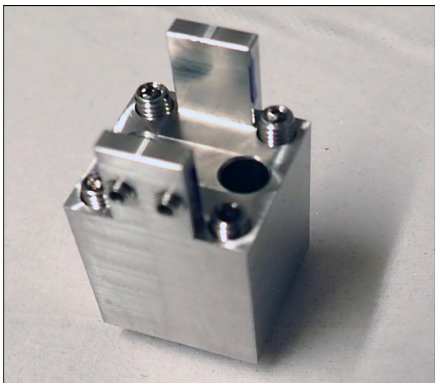
Bild 153: Optimiertes Unterteil der Einbaulehre mit vier Madenschrauben zur exakten Einstellung und Fixierung der Null-Lage
