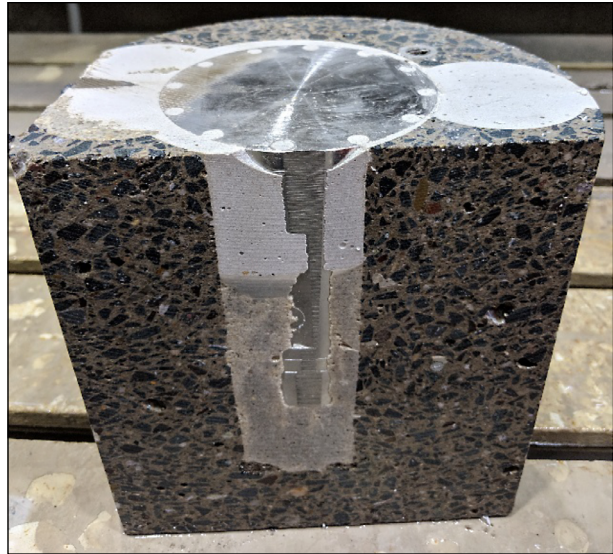
Bild 145: Sensorsystem nach seitlichen Abtragarbeiten zum Freilegen einer Sensorseite
