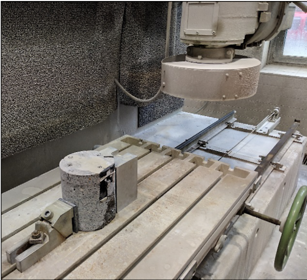
Bild 143: Ausgebautes Sensorsystem in Fräseinrichtung zum Freilegen des Deckels
