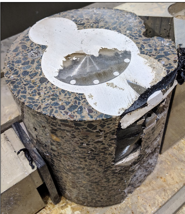
Bild 144: Sensorsystem in Einspannung mit freigelegtem Deckel
