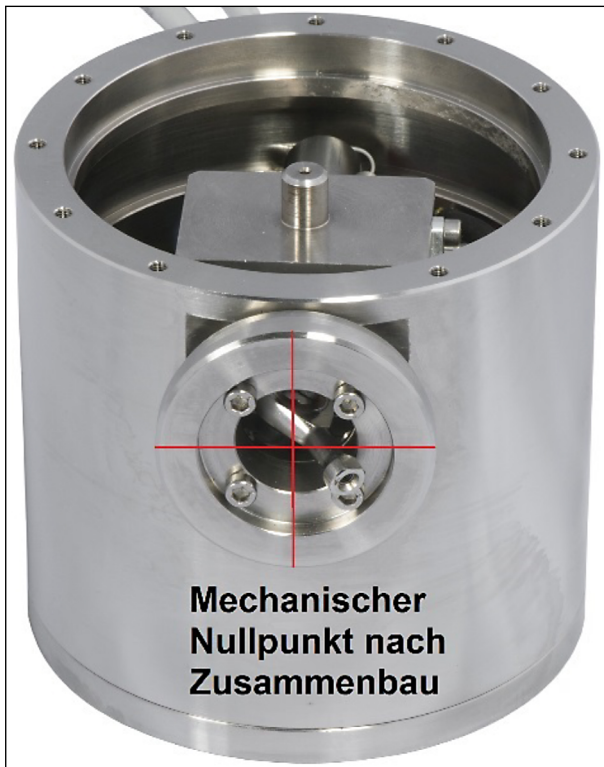
Bild 29: Mechanischer Nullpunkt im Einbauzustand (in der Mitte der Messbereiche der Y- und Z- Achse) hier dargestellt durch Schnittpunkt des Fadenkreuzes
