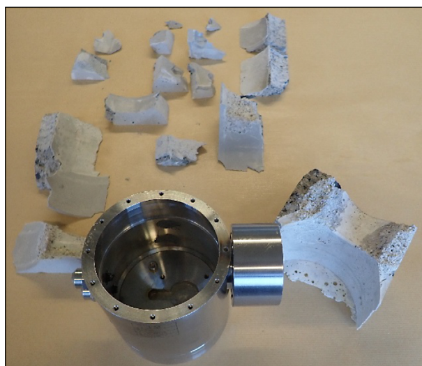
Bild 149: Freigelegtes Sensorsystem 1M mit Bruchstücken des Mörtels
