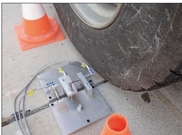
Bild 301: Externes Temporäres Kontrollsystem im Praxiseinsatz an einer Fuge
