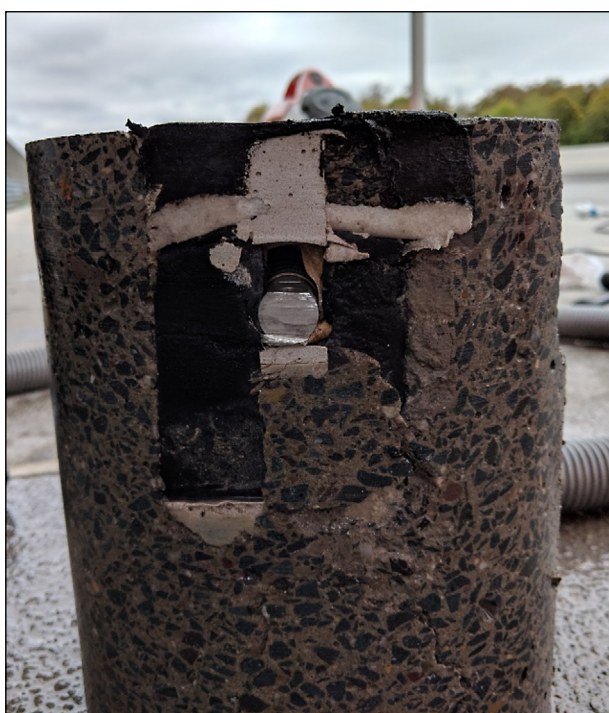
Bild 140: Ausgebautes Sensorsystem kurz nach der Entfernung aus dem Fahrbahnbelag auf der Teststrecke
