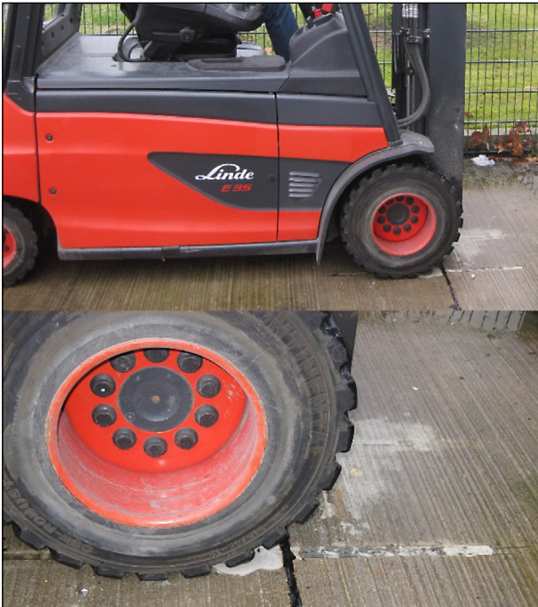
Bild 65: Überrollvorgang über verschlossenes Sensorsystem mit einem 4,5 t schweren Gabelstapler
