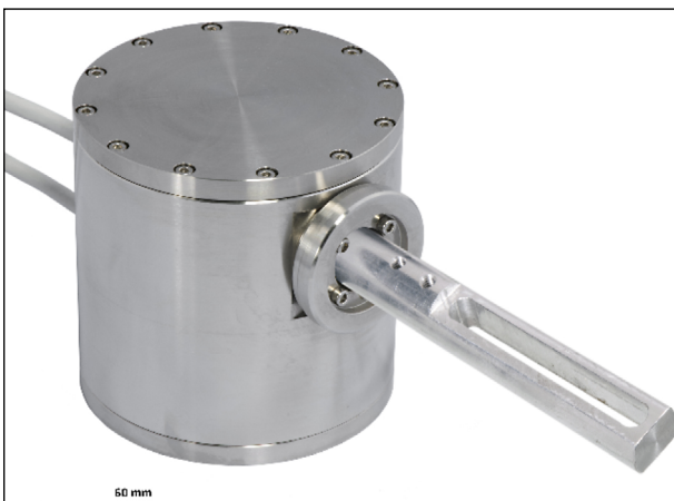
Bild 290: 3D-Sensorsystem mit Anschlussarm für die Befestigung auf der gegenüberliegenden Fugenflanke
