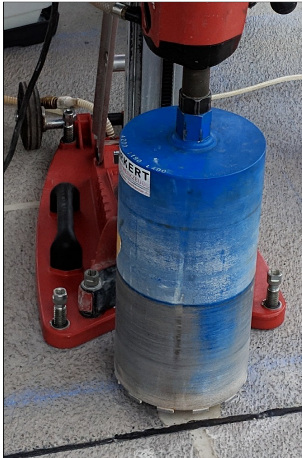
Bild 133: Verwendete Bohrkronen; Innendurchmesser: 190 mm; Außendurchmesser: 200 mm; Länge: 400 mm
