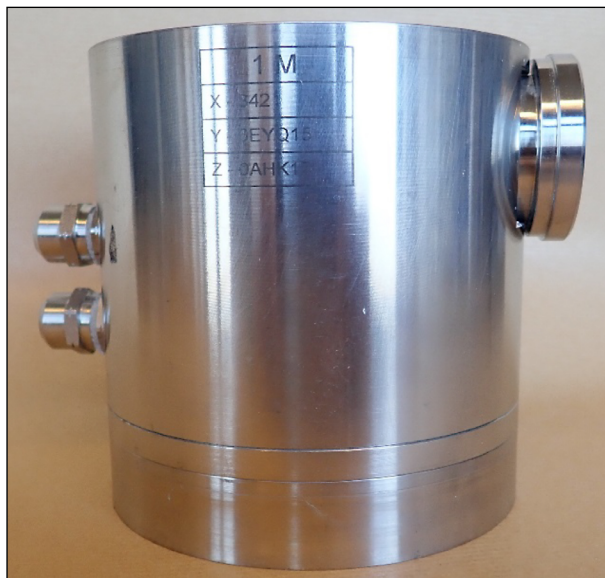
Bild 150: Freigelegtes Sensorsystem 1M
