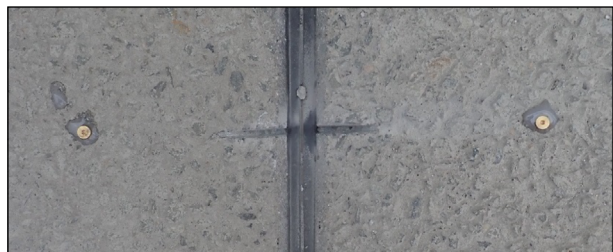
Bild 204: Messmarken für die Setzdehnungsmessung und Referenzschlitz, falls sich die Platten in Y-Richtung verschieben sollten
