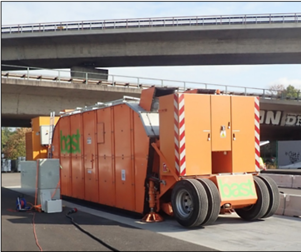
Bild 199: MLS30 in Position auf der Fertigteilbetonstrecke
