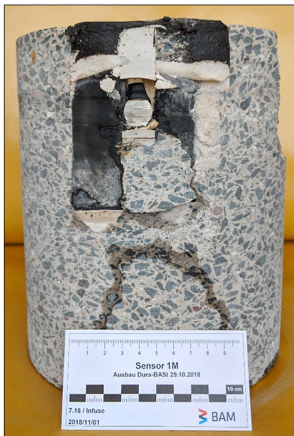
Bild 142: Ausgebautes Sensorsystem im Labor, Ansicht von der Seite
