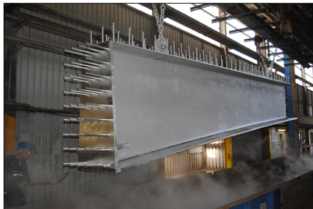
Bild 33: Äußeres Brückensegment nach dem Feuerverzinkungsprozess (IFG)
