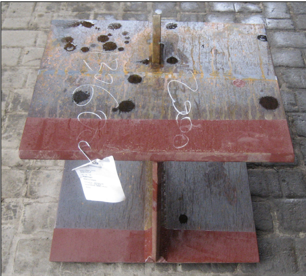
Bild 21: Arbeitsprobe für den Montageschweißstoß, Abdecklack zur gezielten Vermeidung der Zinkaufnahme im Bereich der Schweißnaht (IFG)
