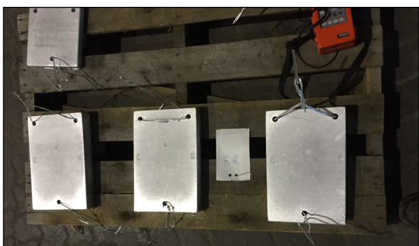
Bild 28: Ergänzende Arbeitsproben / Blechproben nach dem Feuerverzinken, hergestellt mit verschiedenen Tauchzeiten (IFG)
