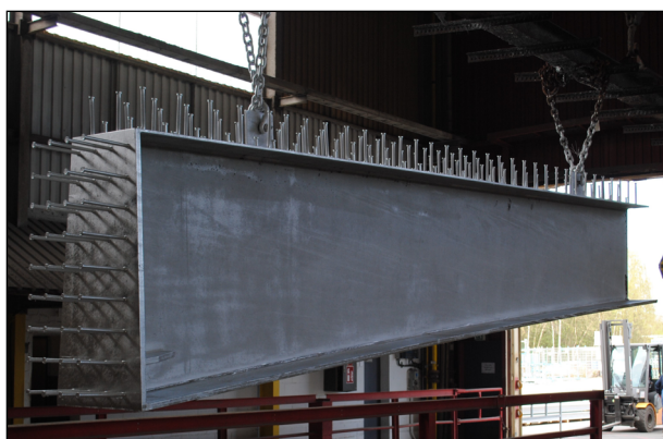
Bild 18: Angeschlagenes feuerverzinktes Brückenteil (IFG)
