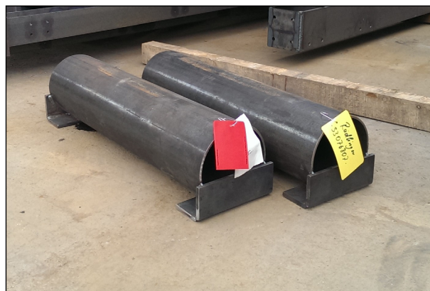
Bild 36: Vorbereitete Absetzböcke zum Ablegen der noch heißen feuerverzinkten Bauteile (IKS)
