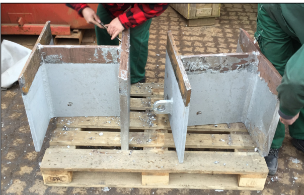
Bild 23: Arbeitsproben nach dem Feuerverzinken, Entfernen von anhaftenden Zinkrückständen im Bereich des Montageschweißstoßes (IFG)
