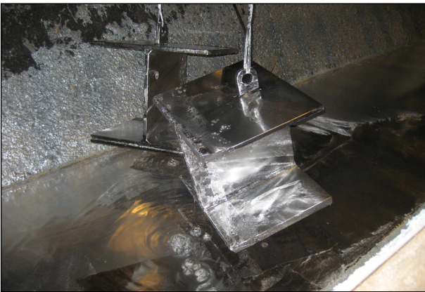
Bild 22: Feuerverzinken der Arbeitsproben (IFG)
