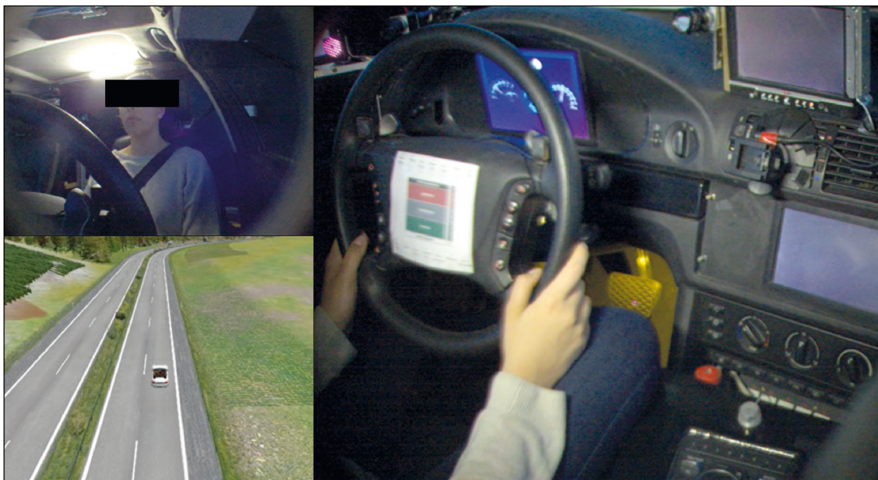
Bild 3-5: Optimale Bildschirm-Anordnung zur Mitschau für den Versuchsleiter während des Versuchs im Simulator (Quelle: WIVW GmbH)
