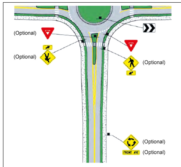
Bild 19: Beschilderung einstreifiger Kreisverkehre | Vereinigte Staaten (RODEGERDTS et al., 2010)
