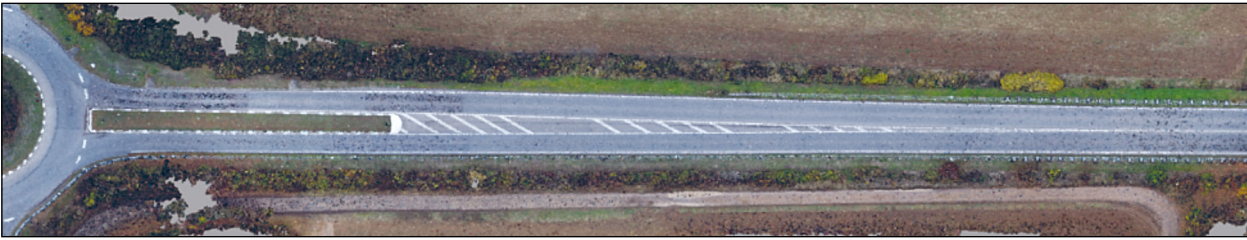
Bild 156: Zufahrt mit überlangen Fahrbahnteiler (55 m FBT + 120 m Sperrfläche)
