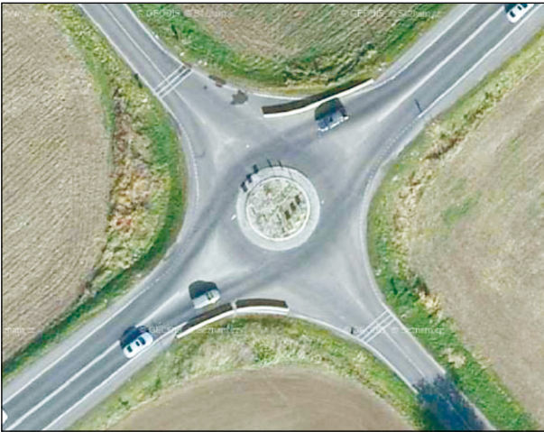
Bild 34: Beispiel für Außerortskreisverkehr mit D = 27\text{ m} | Tschechien (MAHDALOVA et al., 2013)
