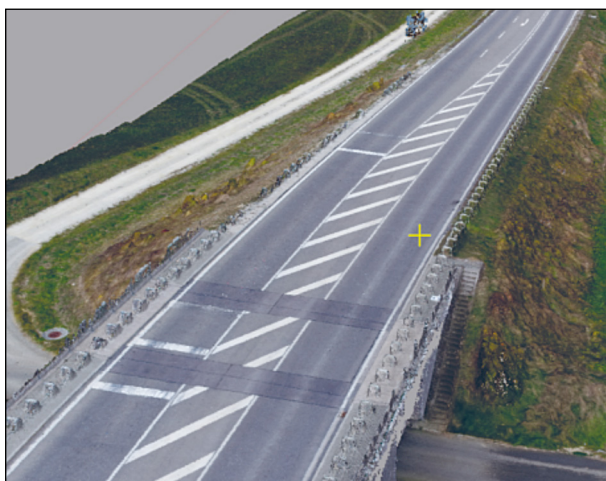
Bild 154: Anordnung von Rüttelstreifen vor einem Kreisverkehr
