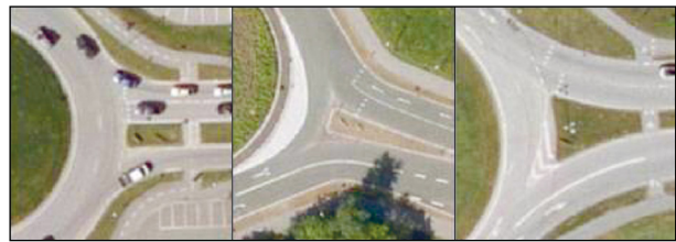
Bild 40: Beispiele für Fahrbahnteilerformen (von links nach rechts: Parallel, Dreiecksform- und angepasste Bordführung (Elefantenfuß)) | Dänemark (JENSEN, 2013)
