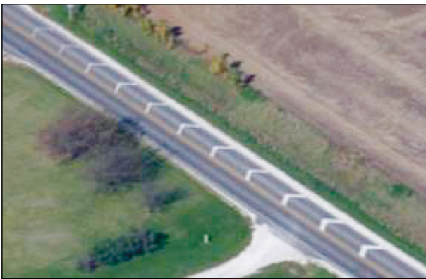
Bild 48: Beispiel für traverse pavement markings | Vereinigte Staaten (CHRYSLER et al., 2017)
