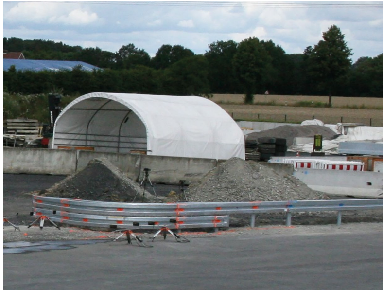
Skizze einer gekrümmten Schutzeinrichtung für Einmündungen (links) und Prototyp auf dem Testfeld (rechts)
