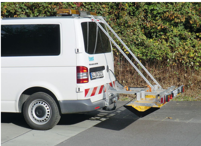
3D-Georadarsystem der BASt im Einsatz
