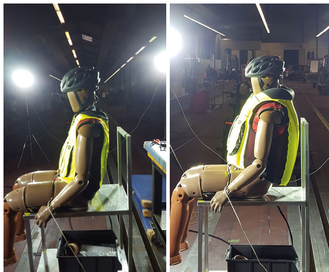
Airbagweste im Standversuch: unausgelöster und ausgelöster Zustand
