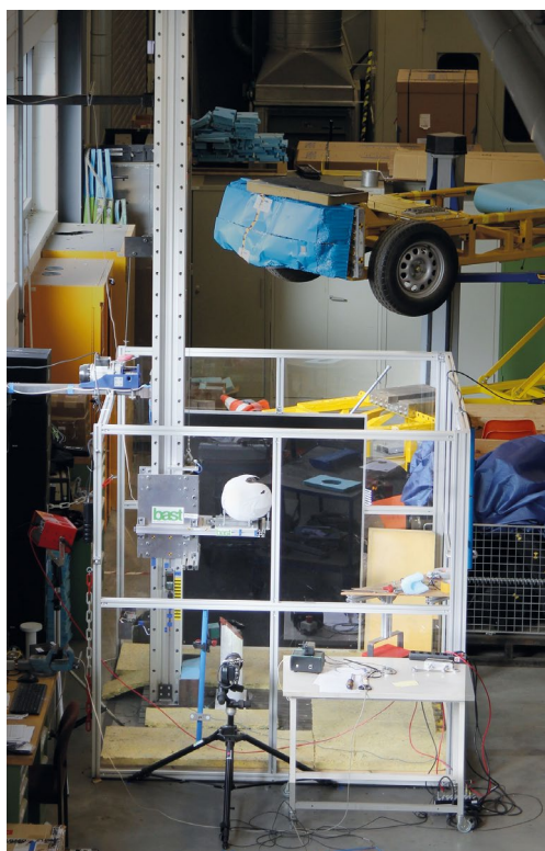
Fallturmprüfstand in der FTVA
