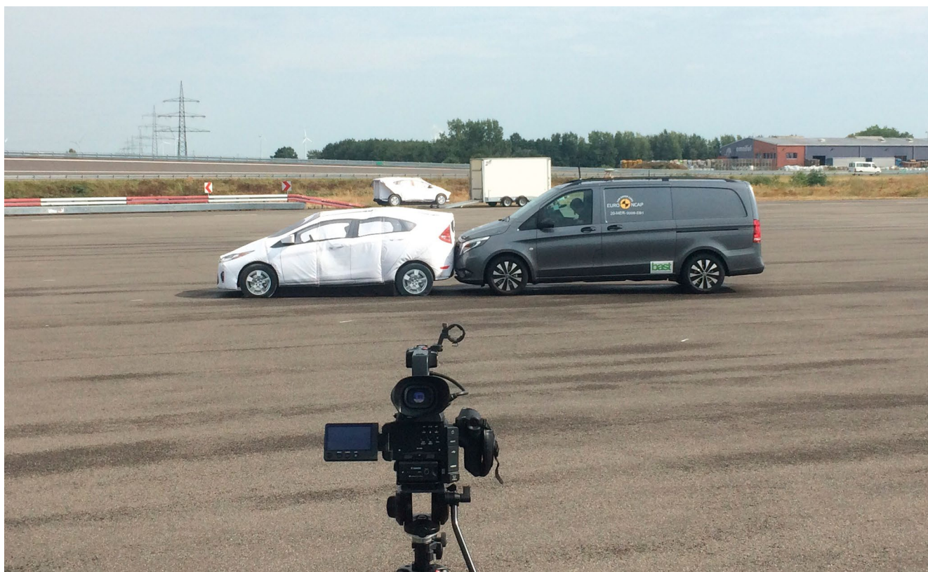
Test des Notbremsassistenten für die Vermeidung oder die Milderung des Fahrzeugheckaufpralls
