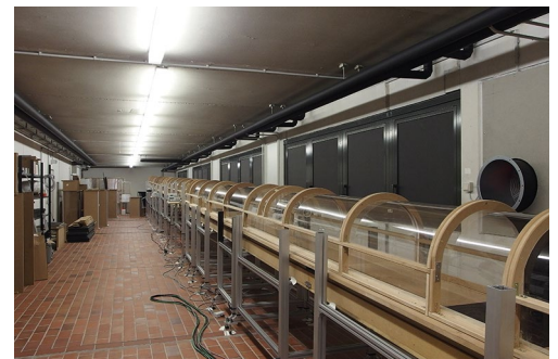
Nachstellung großmaßstäblicher Brandversuche im Modelltunnel
