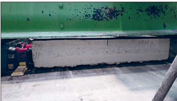
Bild 83: Anordnung des Probekörpers unterhalb des Prüfrahmens
