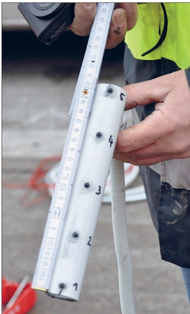
Bild 29: Verlegebeispiel Temperaturmessung, Lage der Sensoren
