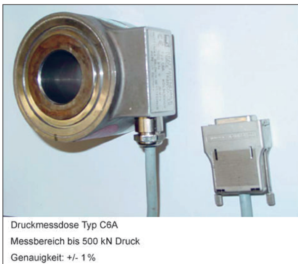
Bild 36: Druckmessdose (Quelle: TU München)
