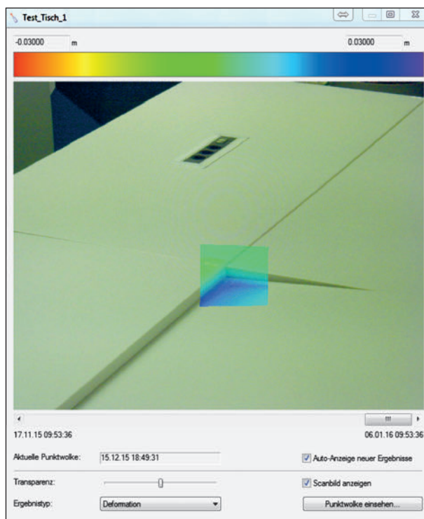
Bild 42: Screenshot der Auswertesoftware, Überlagerung eines Fotos des Scanbereiches mit einer 3D-Punktwolke
