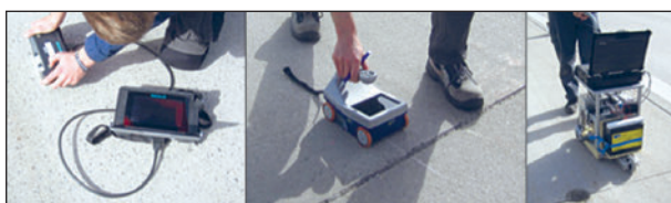
Bild 72: Scannende Prüfverfahren (v.l. Ultraschall, Radar und Impact-Echo)
