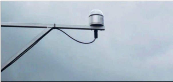
Bild 38: Messung der Globalstrahlung an der BAB A92 bei Freising-Ost (Quelle: TU München)
