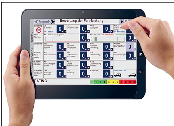
Bild 10: Die am WIVW entwickelte Tablet-Applikation S.A.F.E. zur teilautomatisierten Registrierung und Klassifikation von Fahrfehlern
