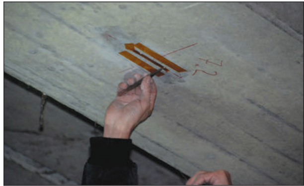
Bild 34: Stufe 6 – Anbringen der DMS und Temperatursensoren
