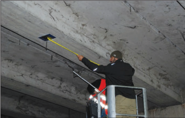
Bild 30: Stufe 2 – Einmessen der Sensorpositionen
