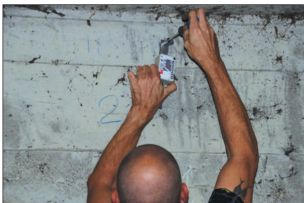
Bild 40: Abschrauben eines Sensors
