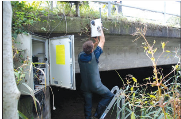
Bild 46: Abschrauben der Übertragungseinheit
