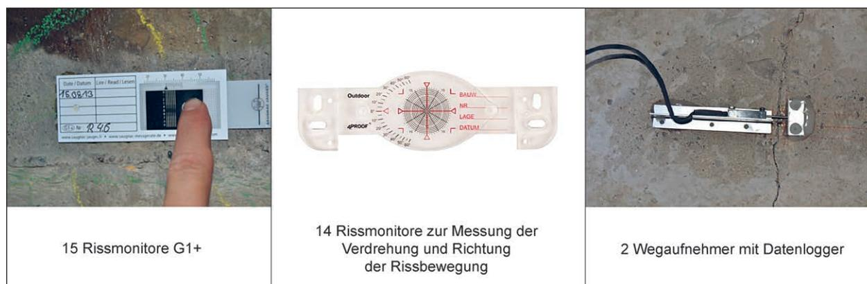
Bild 68: Übersicht über die eingesetzten Rissmonitore [185]
