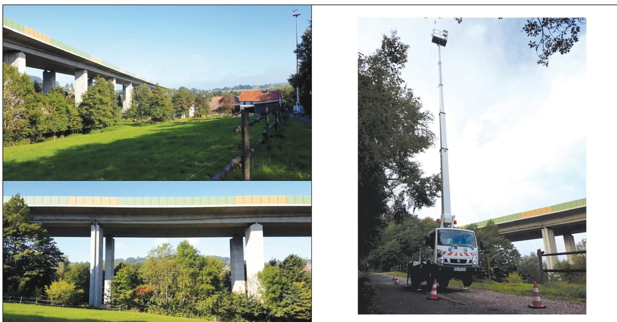
Bild 2.11: MP III (Nahbereich zur Brücke): östlich der Talbrücke, auf Straße südlich der Mottener Straße; in ca. 75 m horizontalem Abstand zur Mitte des Hauptfahrstreifens in nördlicher Fahrtrichtung; Mikrofon + Wetterstation in ca. 23,7 m Höhe über Boden (mit Arbeitsbühne); zusätzliches Mikrofon in 1,9 m über Boden (Referenzmikrofon)
