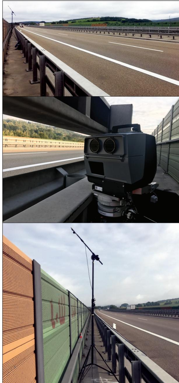
Bild 2.8: Messpunkt MP I (auf Brücke): südliche Fahrtrichtung; ca. 360 m vom südlichen Brückenende entfernt; Mikrofön in ca. 3,7 m Höhe über Boden (ca. 1,7 m über Oberkante Lsw, ca. 1,2 m über Oberkante von angedachtem Lsw-Aufsatz); Geschwindigkeitsmesssystem + Kamera
