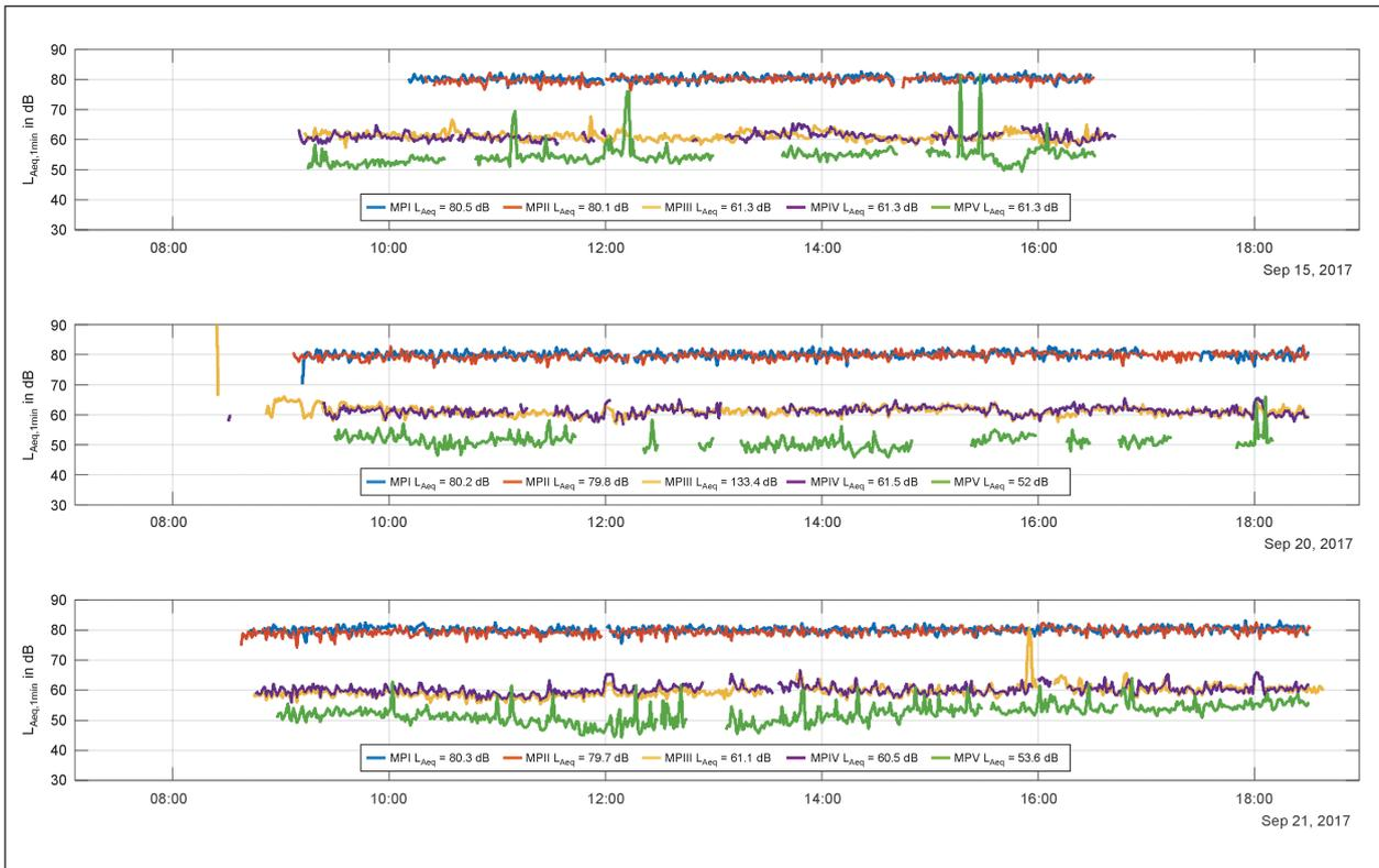
Bild 2.32: Verkehrsgläusche – MP I bis MP V,  $\Delta t = 1$  min, unbereinigt
