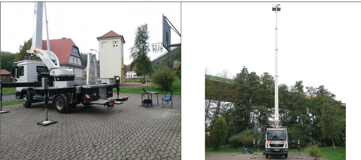
Bild 2.13: MP IV (Nahbereich zur Brücke): östlich der Talbrücke, nördlich der Mottener Straße auf Basketballplatz nahe Tennisplatz; in ca. 54 m horizontalem Abstand zur Mitte des Hauptfahrstreifens in nördlicher Fahrtrichtung; Mikrofon in ca. 29,7 m Höhe über Boden (mit Arbeitsbühne); zusätzliches Mikrofon in 1,7 m über Boden (Referenzmikrofon)
