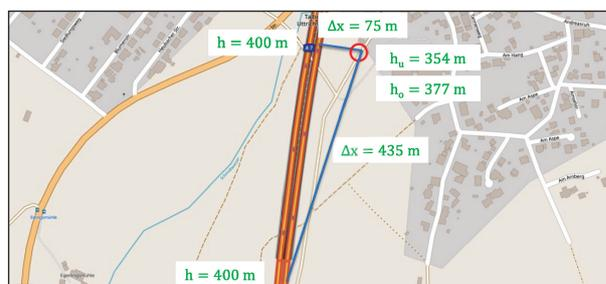
Bild 2.4: Berücksichtigte Geometrie zur abschätzenden Berechnung des Signal-Rausch-Abstands für einen Messort in Bodennähe sowie einen Messort auf Fahrbahnniveau (Kartengrundlage: © OpenStreetMap und Mitwirkende, CC-BY-SA)
