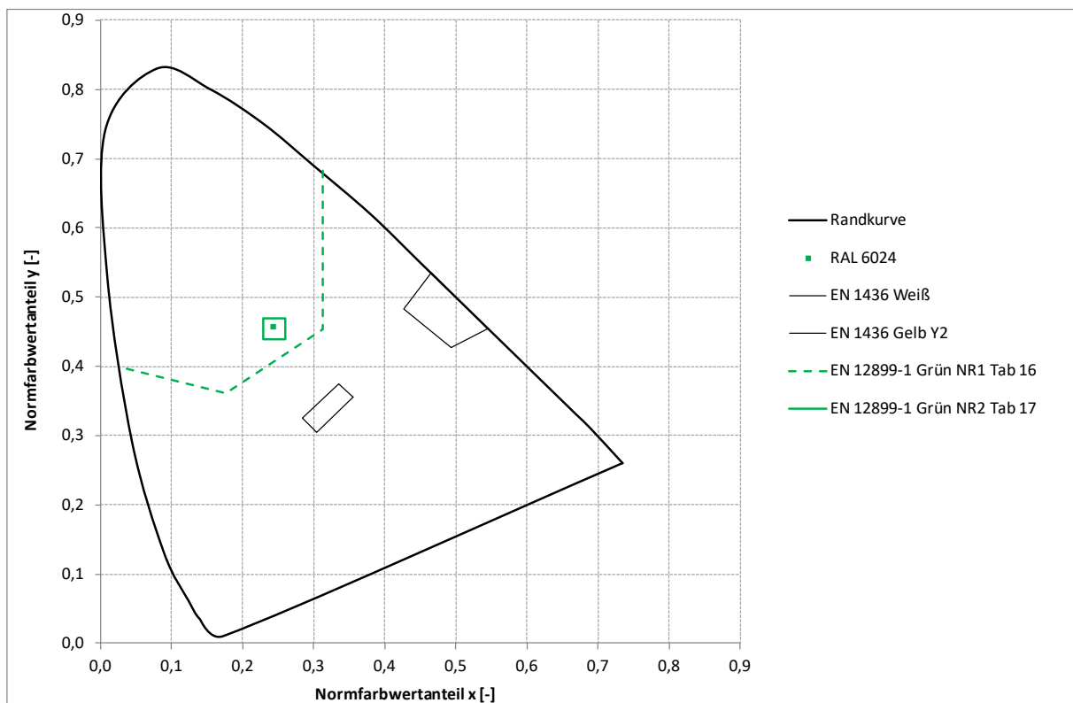
Abbildung 2-9: Farbbereiche NR1 und NR2 nach EN 12899-1 für nicht-retroreflektierende Verkehrszeichen und Tageslicht (D65, 45°/0°)
