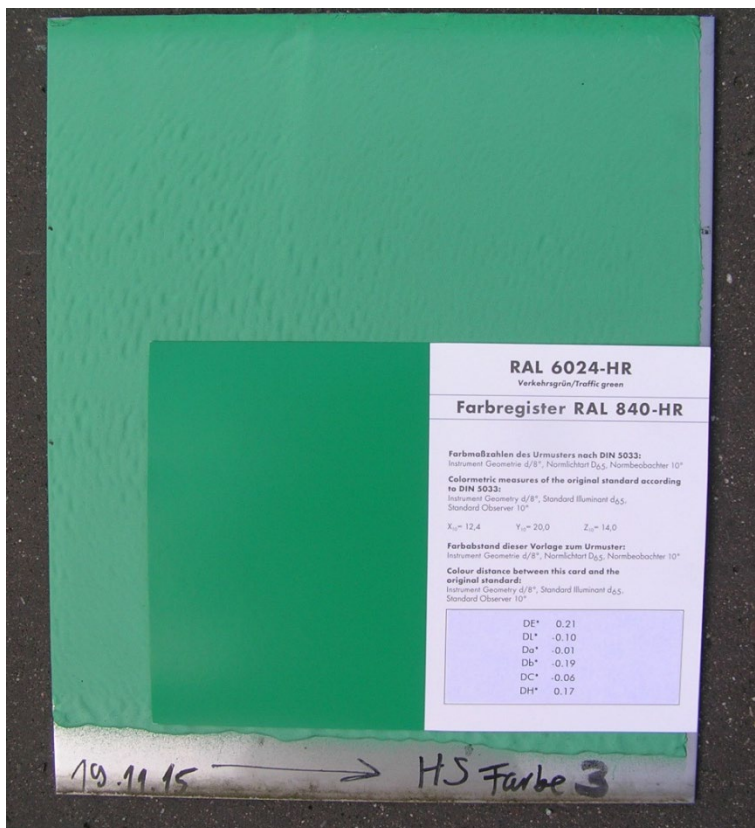
Abbildung A- 23: HS3, 15.08.16 RAL 6024-Karte und Blech
