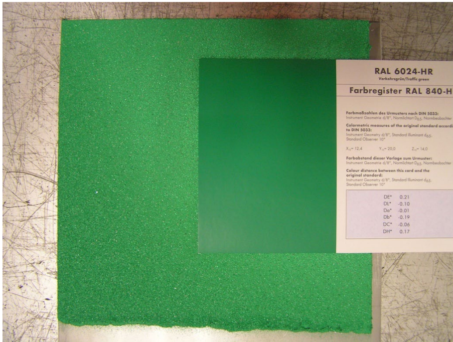
Abbildung A- 19: HS-Farbe 1, Blech und RAL-Farbkarte 6024
