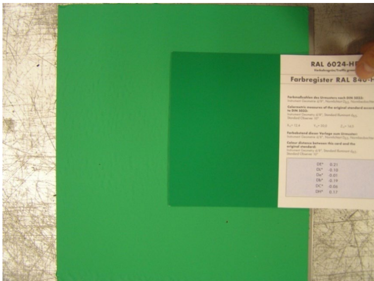
Abbildung 4-7: HS-Farbe 3 (ohne Nachstreumittel), Blech und RAL-Farbkarte 6024
