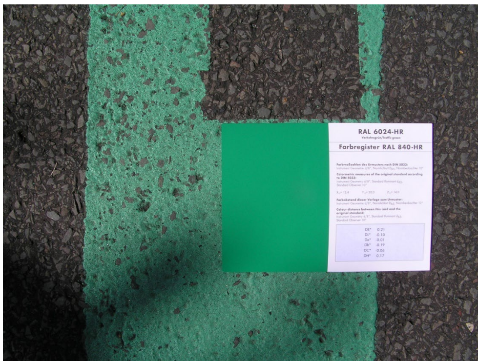
Abbildung A- 36: HS2, Feld, 15.08.2016, Vergleich mit RAL 6024-Karte
