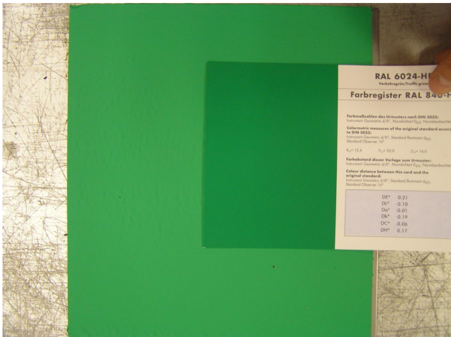
Abbildung A- 18: HS-Farbe 3 (ohne Nachstreumittel), Blech und RAL-Farbkarte 6024
