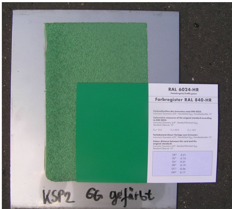
Abbildung A- 25: KSP2, 15.08.16 RAL 6024-Karte und Blech
