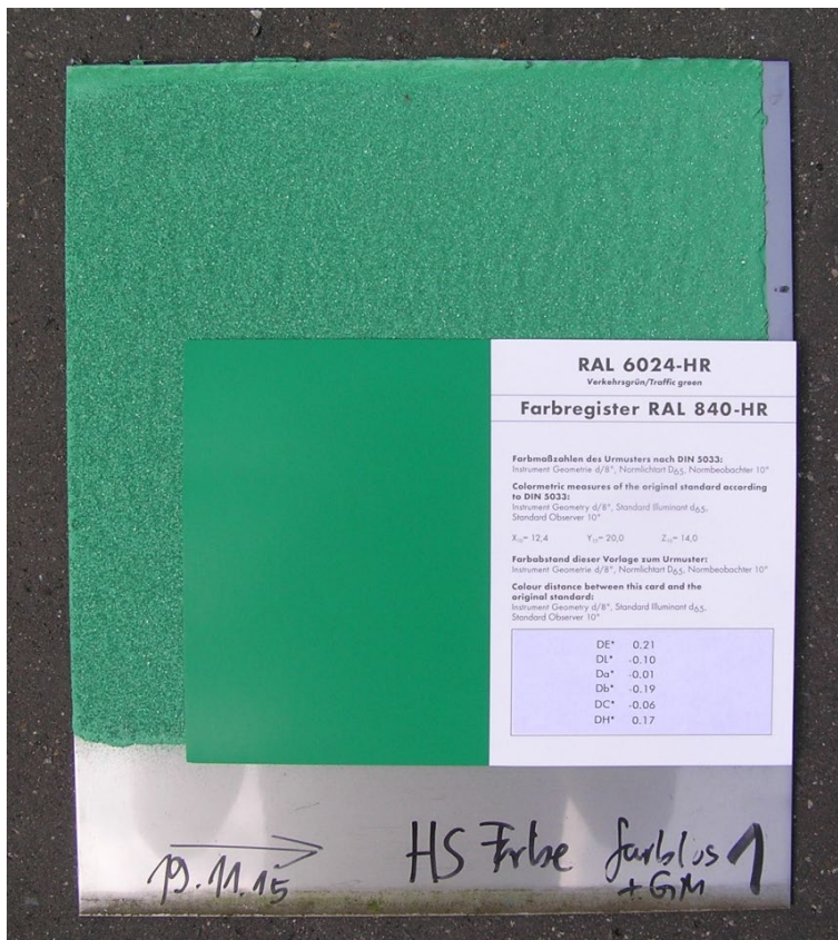
Abbildung A- 21: HS1, 15.08.16 RAL 6024-Karte und Blech
