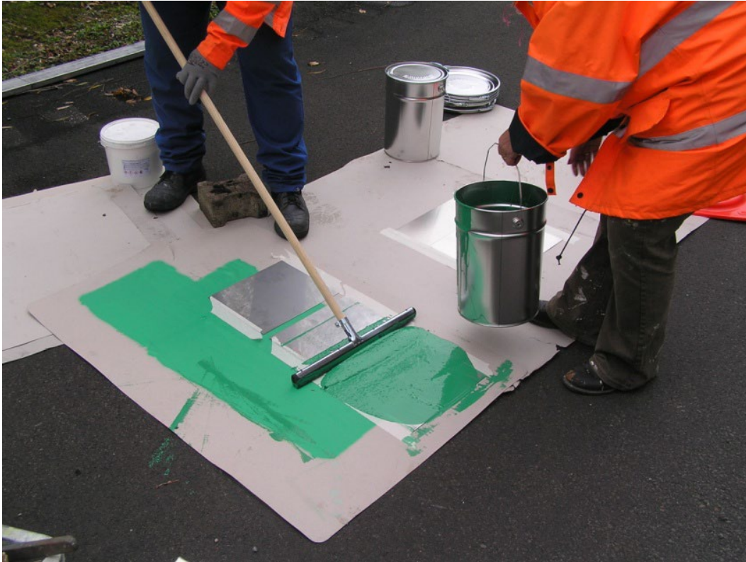
Abbildung A- 5: Anfertigung von Prüfblechen bei der Kaltplastik (frühzeitige Aushärtung, später verworfen)
