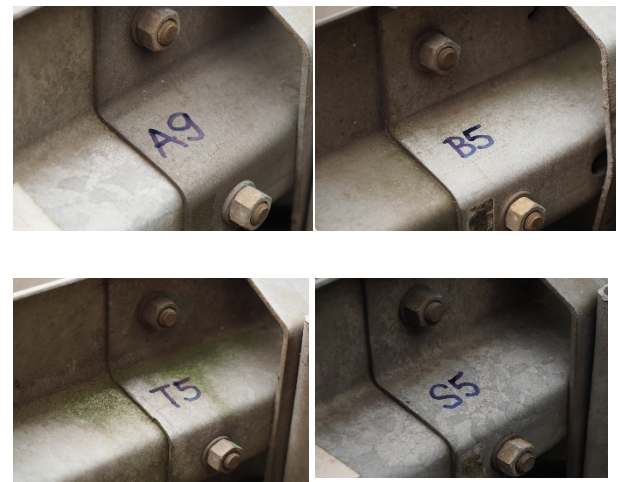
Bild 4: Kanten und Schraubverbindungen 19,5 Jahren Freibewitterung, Buchstaben siehe Tabelle 1, Ziffern bedeuten Nummern des Holmes
