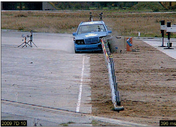
Bild 4-146: Anprallvorgang – Ansicht von vorne t = 396 ms; Quelle DEKRA
