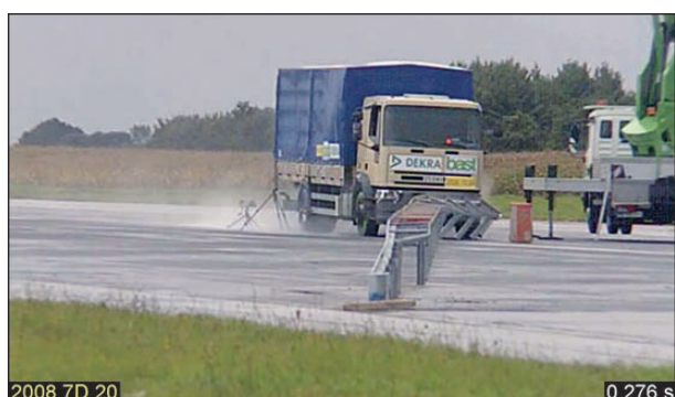
Bild 4-23: Anprallvorgang – Ansicht von vorne t = 0,276 s; Quelle: DEKRA
