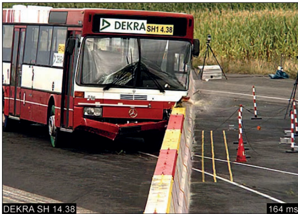
Bild 4-121: Anprallvorgang – Ansicht von vorne t = 164 ms; Quelle: DEKRA
