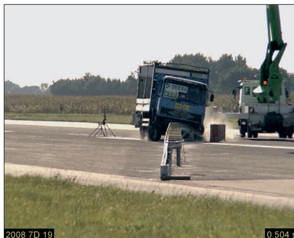
Bild 4-4: Anprallvorgang – Ansicht von vorne t = 0,504 s; Quelle: DEKRA
