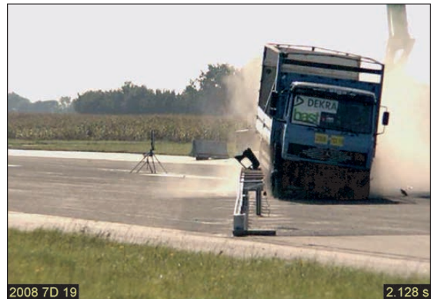
Bild 4-8: Anprallvorgang – Ansicht von vorne t = 2,128 s; Quelle: DEKRA
