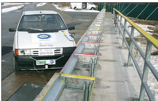
Bild 4-49: Fahrzeug am Anprallpunkt vor der Prüfung entgegen der Anfahrrichtung
