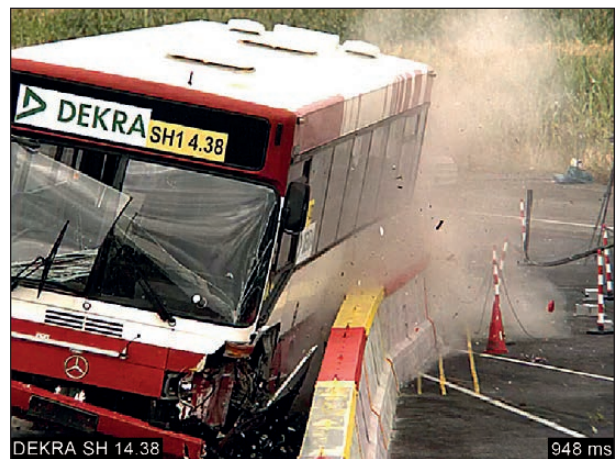
Bild 4-125: Anprallvorgang – Ansicht von vorne t = 948 ms; Quelle: DEKRA
