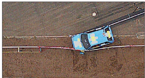
Bild 4-211: Anprallvorgang – Ansicht von oben t = 88 ms; Quelle: DEKRA
