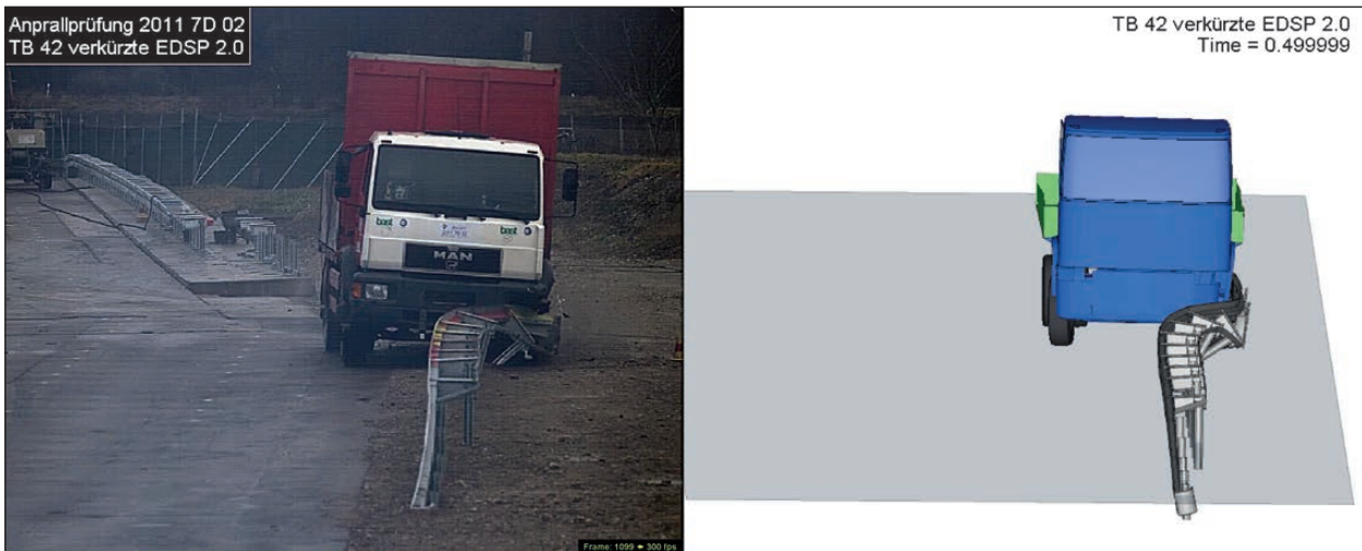
Bild 2-5: Reale und simulierte Anprallprüfung im Vergleich (TB 42 mit einem 10t-Lkw an eine EDSP 2.0 in verkürzter Aufbauhöhe)
