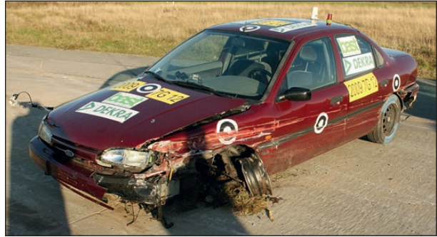
Bild 4-227: Schäden auf der Fahrerseite nach der Prüfung
