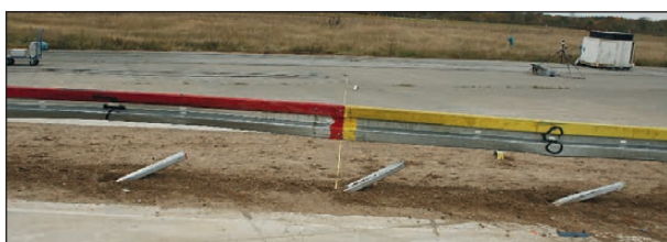
Bild 4-152: Beschädigungen innerhalb der Kontaktstrecke
