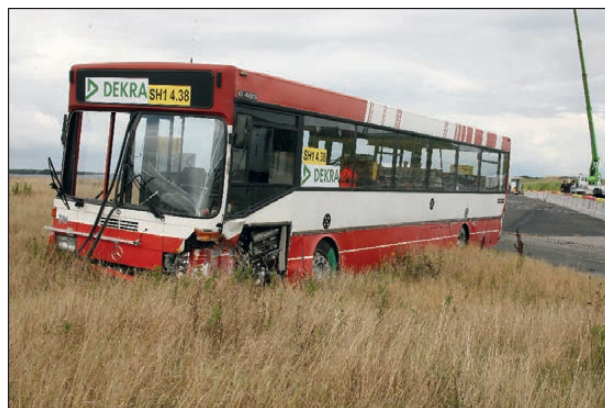
Bild 4-130: Schäden am Fahrzeug (Front) nach der Prüfung; Fahrzeug in Endstellung
