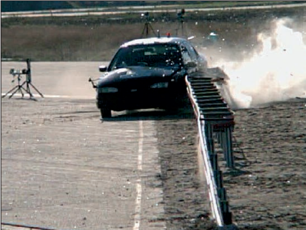
Bild 4-224: Anprallvorgang – Ansicht von vorne t = 524 ms; Quelle: DEKRA
