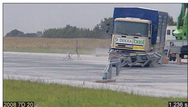
Bild 4-25: Anprallvorgang – Ansicht von vorne t = 1,236 s; Quelle: DEKRA
