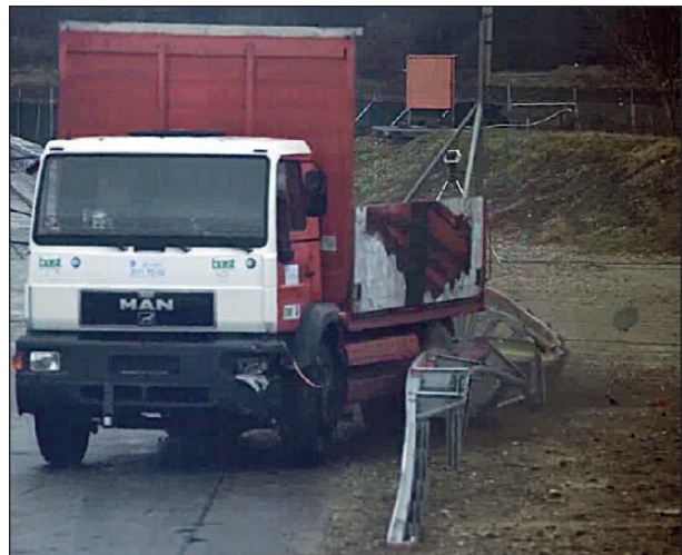
Bild 4-175: Anprallvorgang – Ansicht von vorne 6; Quelle: TÜV Süd
