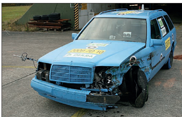
Bild 4-153: Schäden am Versuchsfahrzeug im Frontbereich nach Primär- und Sekundärprall
