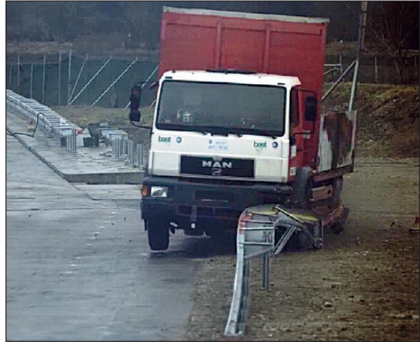
Bild 4-173: Anprallvorgang – Ansicht von vorne 4; Quelle: TÜV Süd
