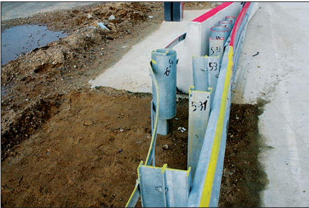
Bild 4-94: Kontaktstrecke, leichte Neigung des IPE-Pfostens 5-32 mit verformtem Holm; Blick in Anfahrriichtung
