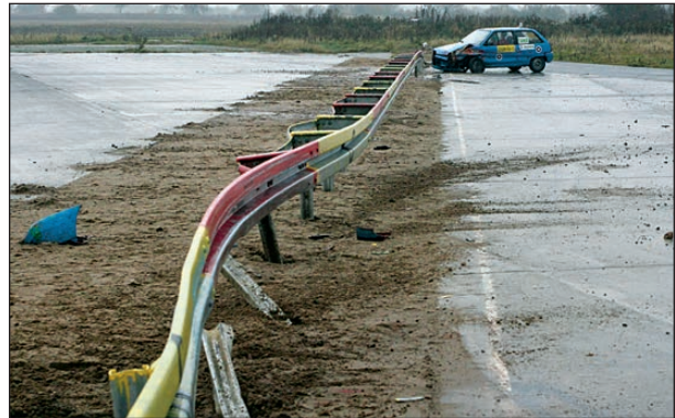
Bild 4-217: Durchbiegung der Schutzeinrichtung; Quelle: DEKRA
