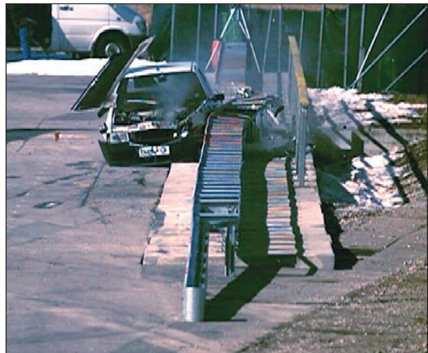
Bild 4-55: Anprallvorgang – Ansicht von vorne 5; Quelle: TÜV Süd
