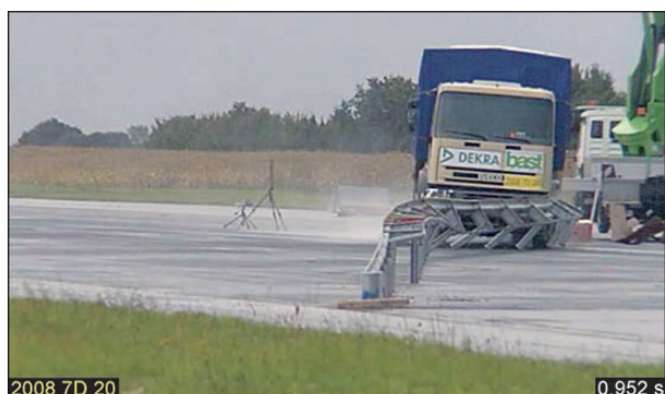
Bild 4-24: Anprallvorgang – Ansicht von vorne t = 0,952 s; Quelle: DEKRA
