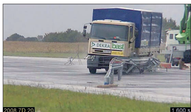
Bild 4-26: Anprallvorgang – Ansicht von vorne t = 1,600 s; Quelle: DEKRA
