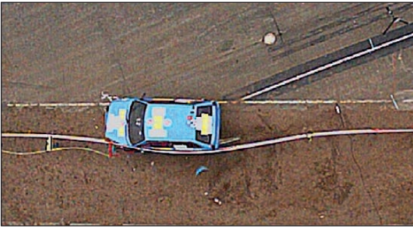
Bild 4-213: Anprallvorgang – Ansicht von oben t = 228 ms; Quelle: DEKRA
