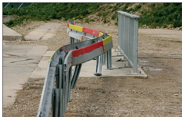
Bild 4-194: Durchbiegung der Schutzeinrichtung
