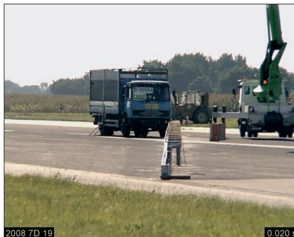
Bild 4-2: Anprallvorgang – Ansicht von vorne t = 0,020 s; Quelle: DEKRA
