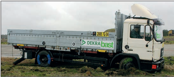
Bild 4-105: Schäden am Fahrzeug nach der Prüfung einschließlich leichtem Sekundärprall (Beifahrerseite)
