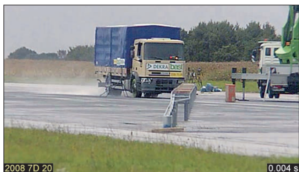
Bild 4-22: Anprallvorgang – Ansicht von vorne t = 0,004 s; Quelle: DEKRA
