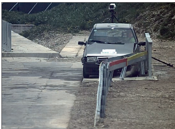
Bild 4-189: Anprallvorgang – Ansicht von vorne 3; Quelle: TÜV Süd
