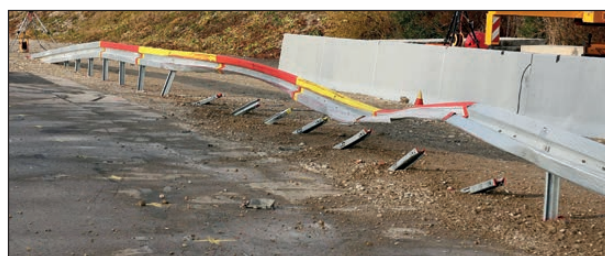
Bild 4-164: Durchbiegung der Schutzeinrichtung; Blick entgegen der Anfahrrichtung
