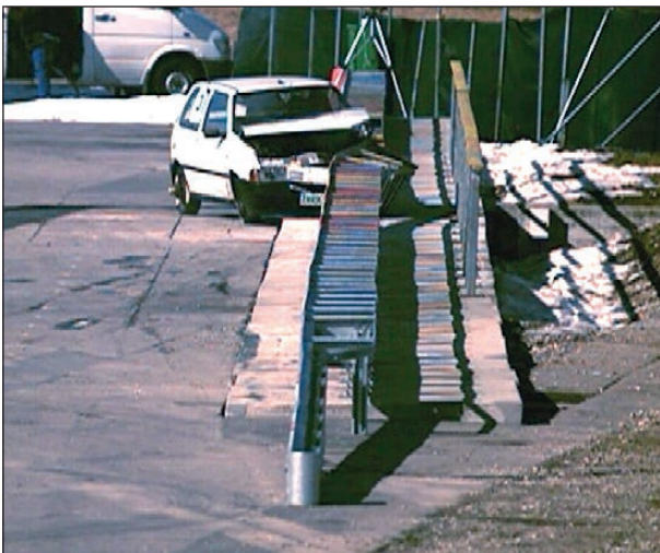
Bild 4-52: Anprallvorgang – Ansicht von vorne 2; Quelle: TÜV Süd
