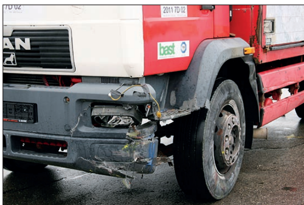
Bild 4-177: Detailansicht Schäden an Stoßstange und Scheinwerfer (Front Fahrerseite)
