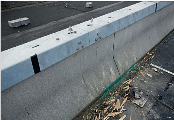
Bild 4-137: BSW O im New Jersey Profil nach dem Belastungstest; Quelle: DEKRA
