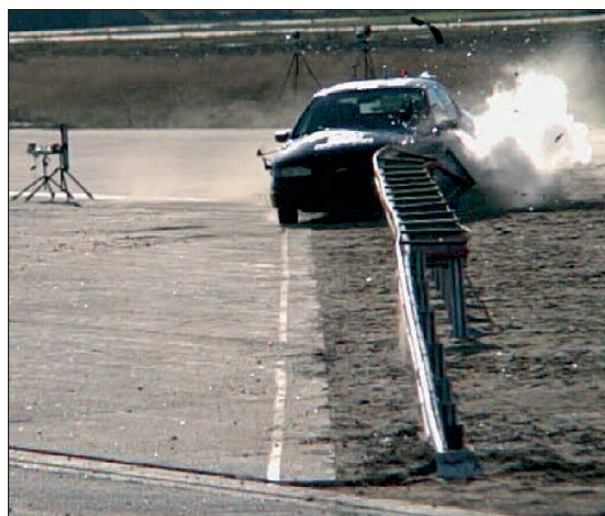
Bild 4-223: Anprallvorgang – Ansicht von vorne t = 368 ms; Quelle: DEKRA
