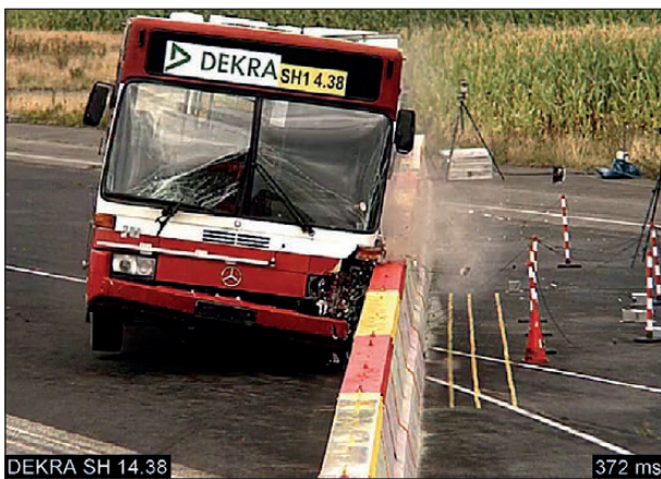
Bild 4-122: Anprallvorgang – Ansicht von vorne t = 372 ms; Quelle: DEKRA
