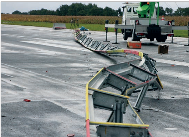
Bild 4-29: Durchbiegung der Schutzeinrichtung; Blick entgegen der Anfahrriichtung
