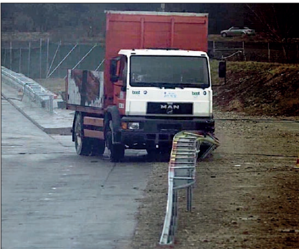
Bild 4-171: Anprallvorgang – Ansicht von vorne 2; Quelle: TÜV Süd
