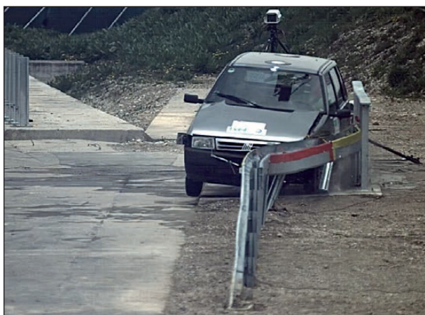
Bild 4-190: Anprallvorgang – Ansicht von vorne 4; Quelle: TÜV Süd
