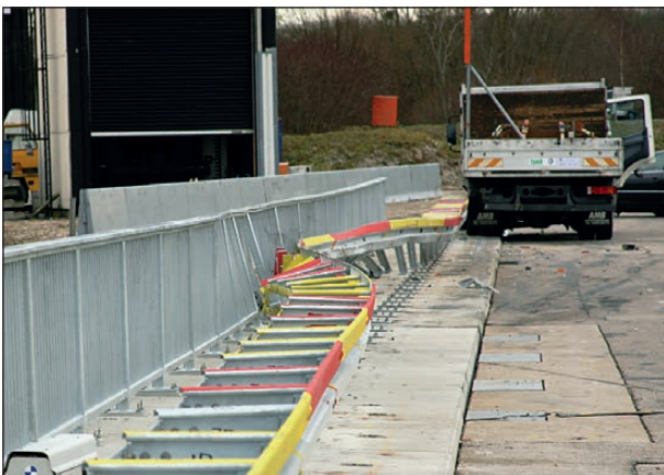
Bild 4-83: Endstellung Prüffahrzeug nach Versuch; Blick in Anfahrriichtung
