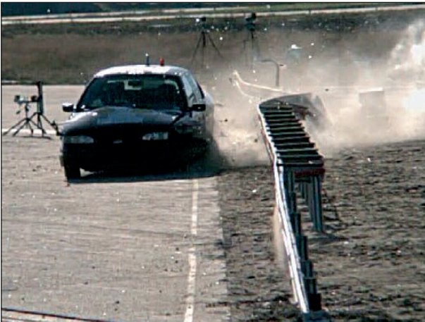
Bild 4-225: Anprallvorgang – Ansicht von vorne t = 724 ms; Quelle: DEKRA
