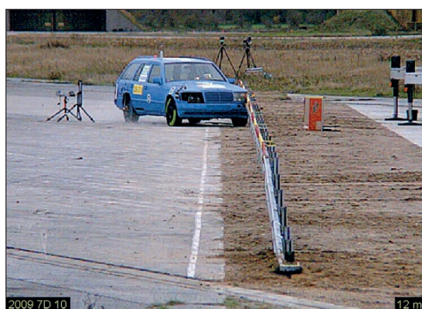
Bild 4-144: Anprallvorgang – Ansicht von vorne t = 12 ms; Quelle: DEKRA
