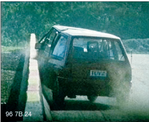
Bild 4-138: TB 11 an BSW O New Jersey (Versuch 1996 7B 24) gemäß ELLMERS – Ansicht von hinten
