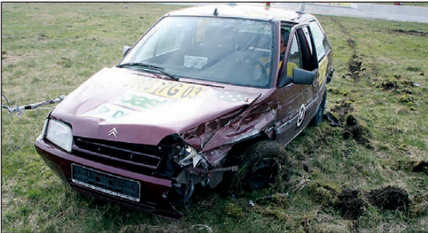
Bild 4-95: Schäden am Fahrzeug nach der Prüfung
