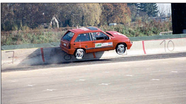
Bild 4-139: TB 11 an BSW O New Jersey (Versuch 1996 7B 24) gemäß ELLMERS – seitliche Ansicht
