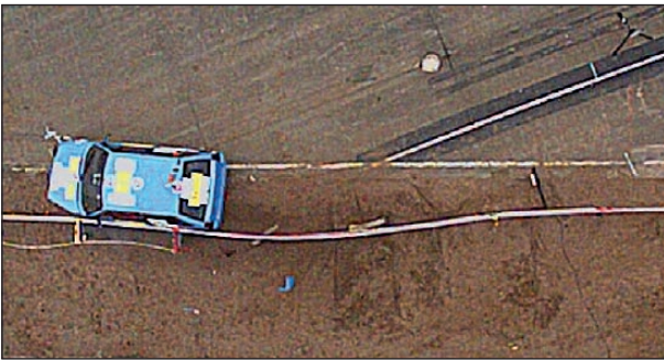
Bild 4-214: Anprallvorgang – Ansicht von oben t = 348 ms; Quelle: DEKRA
