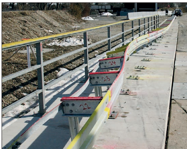
Bild 4-57: Durchbiegung der Schutzeinrichtung
