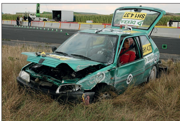
Bild 4-118: Schäden am Fahrzeug nach der Prüfung, Fahrzeug in Endstellung
