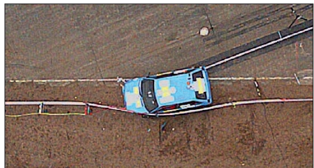
Bild 4-212: Anprallvorgang – Ansicht von oben t = 148 ms; Quelle: DEKRA
