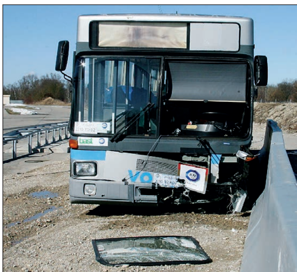
Bild 4-69: Schäden am Fahrzeug nach der Prüfung im Frontbereich
