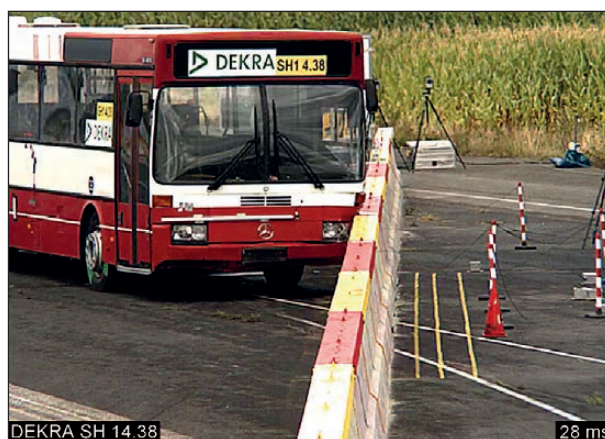
Bild 4-120: Anprallvorgang – Ansicht von vorne t = 28 ms; Quelle: DEKRA
