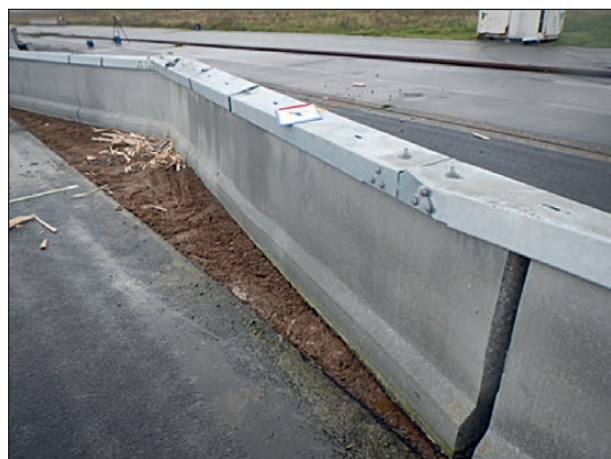
Bild 4-140: Softbaer auf Schotter nach dem Belastungstest; Quelle: DEKRA
