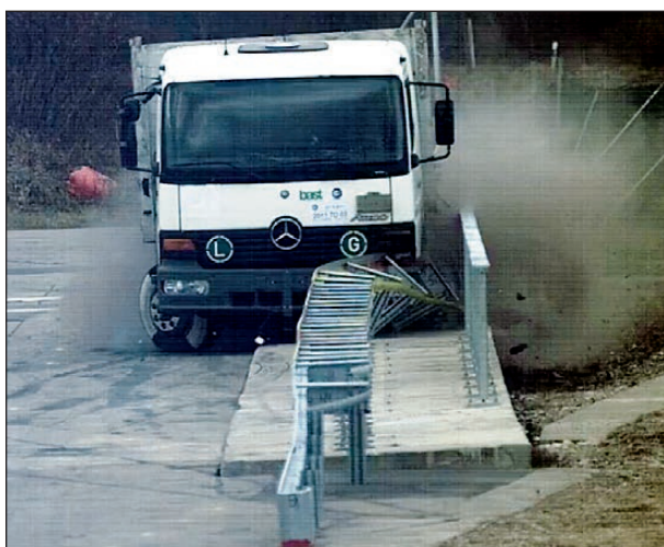
Bild 4-77: Anprallvorgang – Ansicht von vorne 4; Quelle: TÜV Süd
