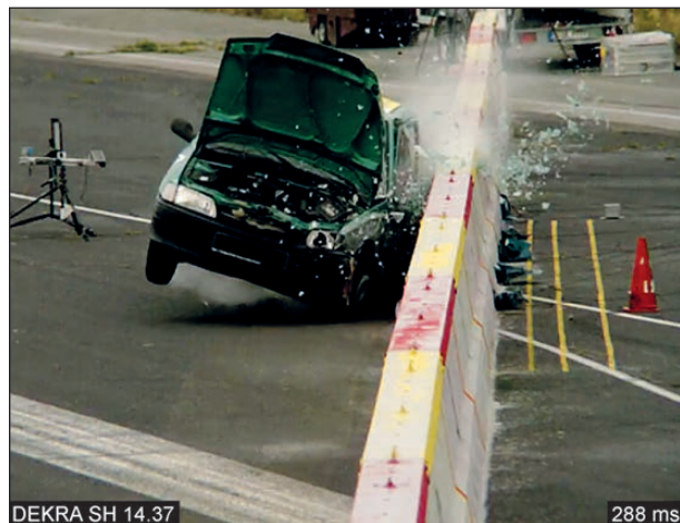
Bild 4-116: Anprallvorgang – Ansicht von vorne t = 288 ms; Quelle: DEKRA
