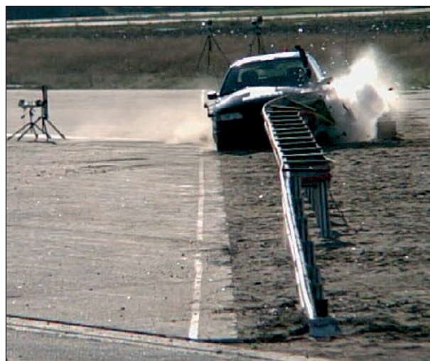
Bild 4-222: Anprallvorgang – Ansicht von vorne t = 264 ms; Quelle: DEKRA
