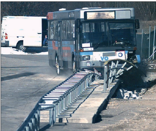
Bild 4-63: Anprallvorgang – Ansicht von vorne 3; Quelle: TÜV Süd
