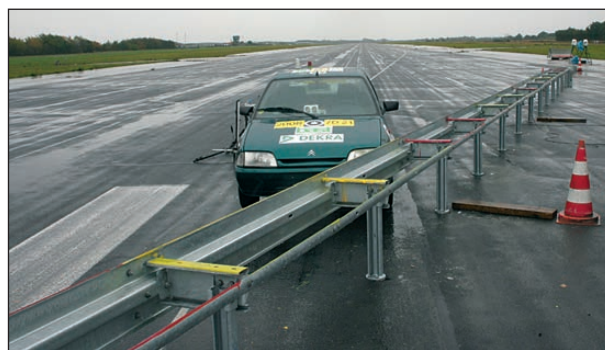
Bild 4-17: Fahrzeug am Anprallpunkt; Blick entgegen der Anfahrtrichtung auf die Systemrückseite
