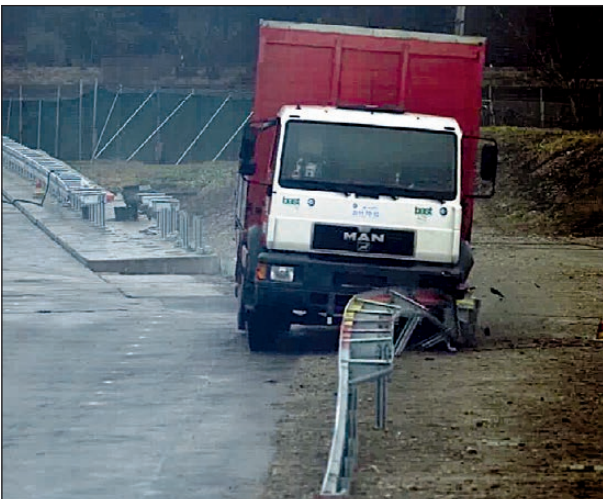
Bild 4-172: Anprallvorgang – Ansicht von vorne 3; Quelle: TÜV Süd
