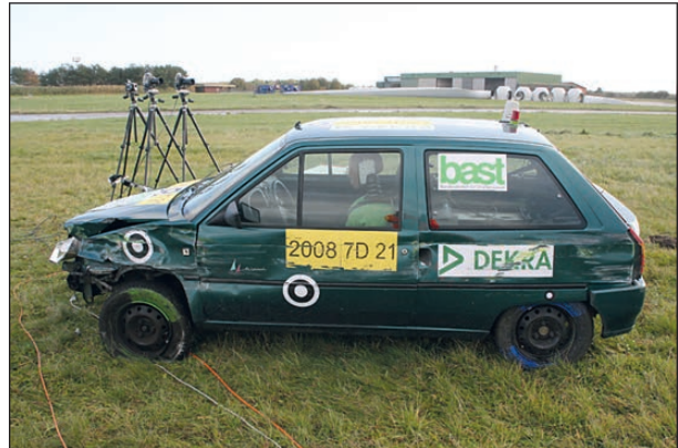
Bild 4-21: Schäden am Versuchsfahrzeug nach dem Versuch
