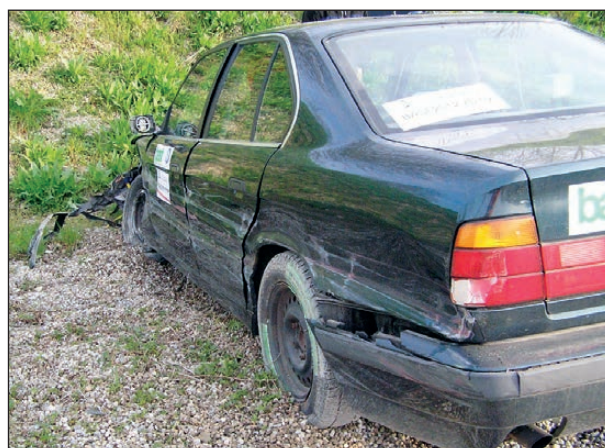
Bild 4-205: Schäden am Fahrzeug nach der Prüfung
