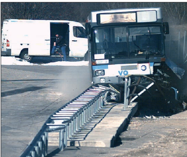
Bild 4-64: Anprallvorgang – Ansicht von vorne 4; Quelle: TÜV Süd
