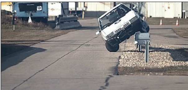
Bild 4-243: Anprallvorgang – Ansicht von vorne 4
