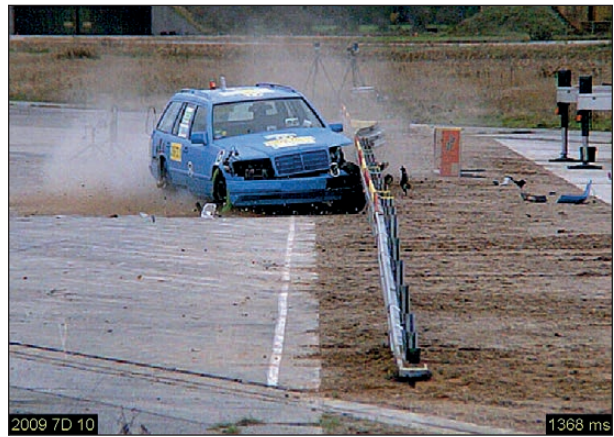
Bild 4-149: Sekundärprall – Ansicht von vorne t = 1.368 ms; Quelle DEKRA
