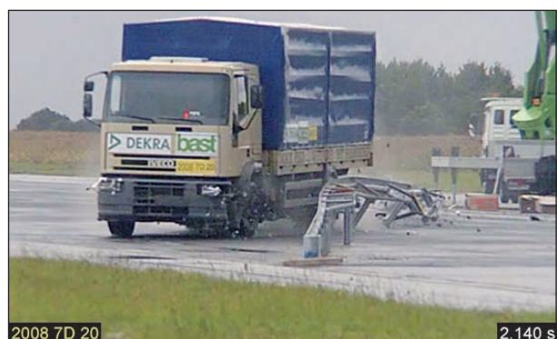
Bild 4-28: Anprallvorgang – Ansicht von vorne t = 2,140 s; Quelle: DEKRA
