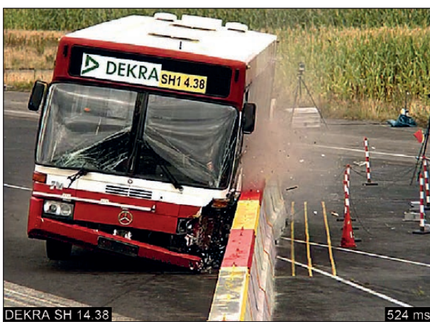
Bild 4-123: Anprallvorgang – Ansicht von vorne t = 524 ms; Quelle: DEKRA
