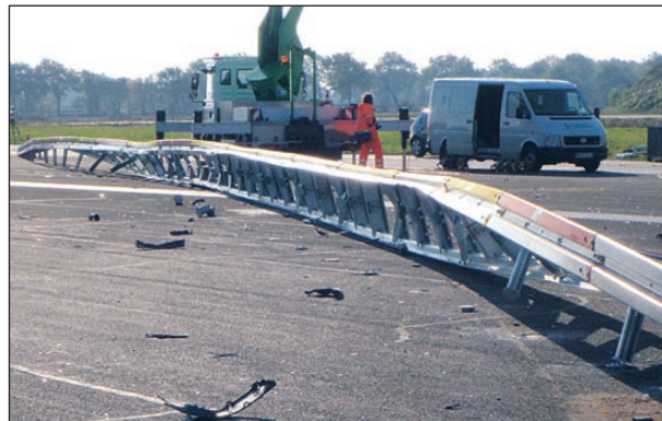
Bild 4-43: DDSP 4.0+ nach Anprall – Ansicht gegen Anprallrichtung; Quelle: DEKRA
