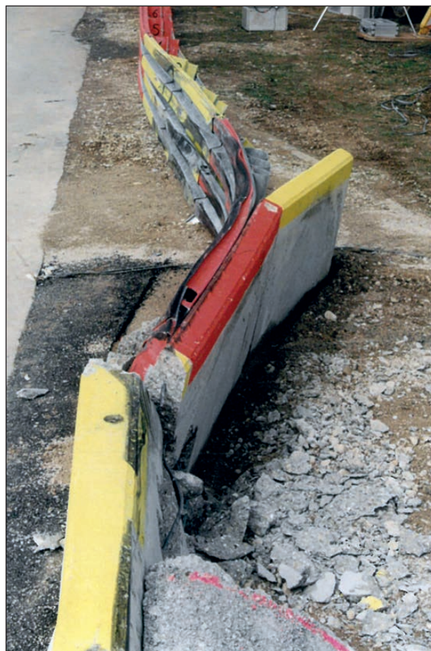
Bild 2-7: Übergangskonstruktion nach Prüfung TB 42 (Orientierungsversuch)
