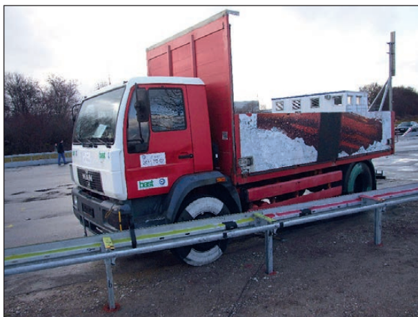
Bild 4-169: Fahrzeug am Anprallpunkt in Anfahrriichtung vor der Prüfung; lateraler Blick auf die Systemrückseite; Quelle: TÜV Süd
