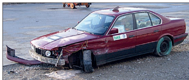
Bild 4-163: Schäden am Fahrzeug nach der Prüfung; Quelle: TÜV Süd
