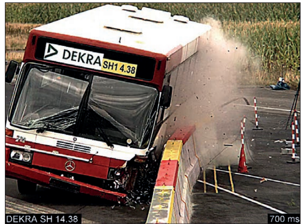
Bild 4-124: Anprallvorgang – Ansicht von vorne t = 700 ms; Quelle: DEKRA
