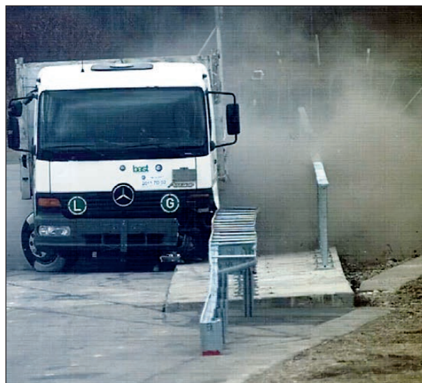
Bild 4-79: Anprallvorgang – Ansicht von vorne 6; Quelle: TÜV Süd
