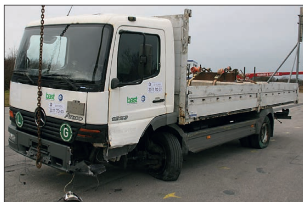
Bild 4-80: Schäden am Fahrzeug nach der Prüfung auf der Fahrerseite
