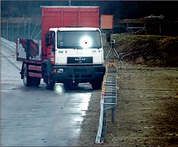
Bild 4-170: Anprallvorgang – Ansicht von vorne 1; Quelle: TÜV Süd
