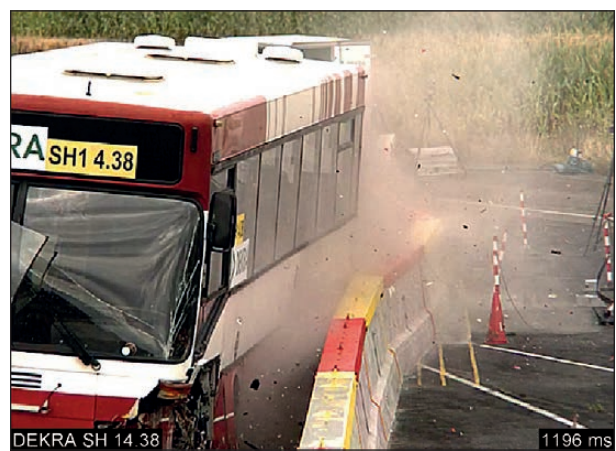
Bild 4-126: Anprallvorgang – Ansicht von vorne t = 1.196 ms; Quelle: DEKRA
