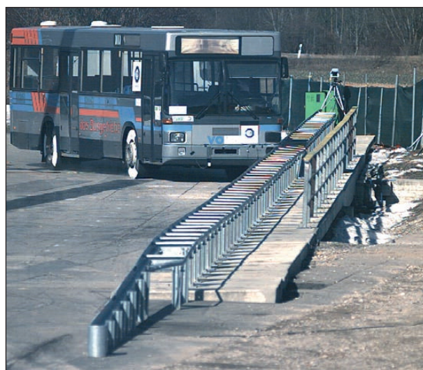
Bild 4-61: Anprallvorgang – Ansicht von vorne 1; Quelle: TÜV Süd
