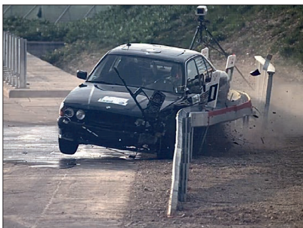
Bild 4-201: Anprallvorgang – Ansicht von vorne 5; Quelle: TÜV Süd
