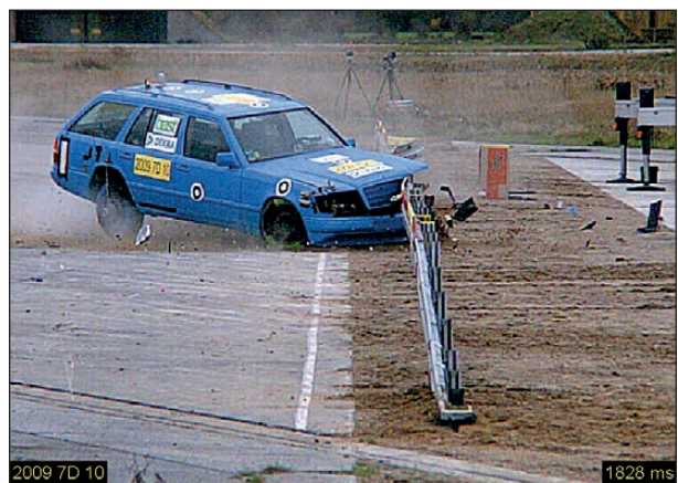
Bild 4-150: Sekundärprall – Ansicht von vorne t = 1.828 ms; Quelle DEKRA
