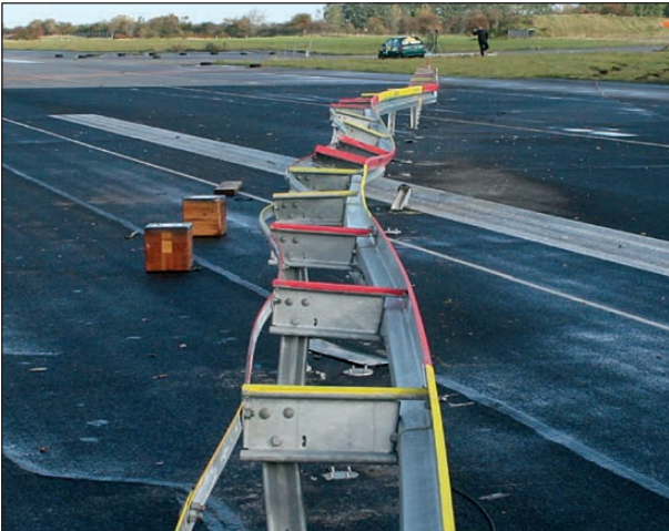
Bild 4-19: Durchbiegung der Schutzeinrichtung; Blick in Anfahr- richtung
