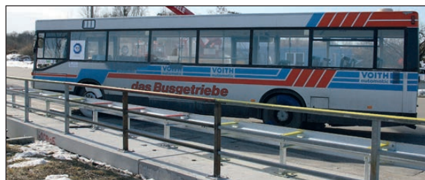
Bild 4-60: Fahrzeug am Anprallpunkt vor der Prüfung; Blick in Anfahrriichtung auf die Systemrückseite
