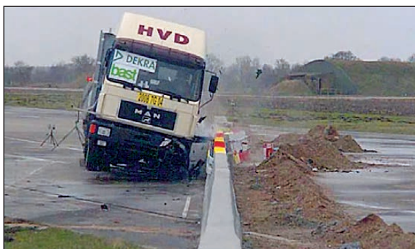
Bild 4-100: Anprallvorgang – Ansicht von vorne 5; Quelle: DEKRA
