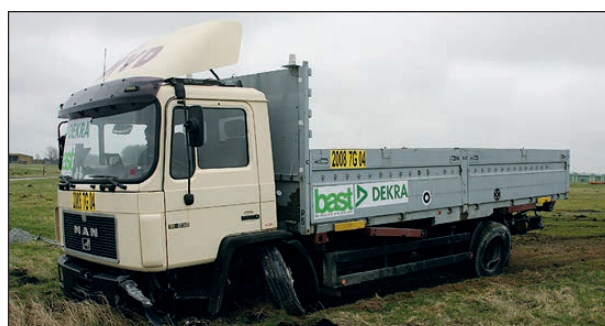
Bild 4-104: Schäden am Fahrzeug nach der Prüfung einschließlich leichtem Sekundäranprall (Fahrerseite)
