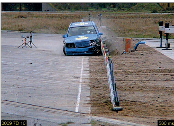
Bild 4-147: Anprallvorgang – Ansicht von vorne t = 580 ms; Quelle DEKRA
