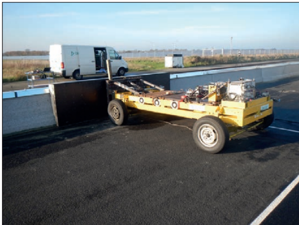
Bild 4-135: Stellprobe Stoßwagenversuch an BSW O mit unterschiedlichen Bauformen und aufgebrachter Sanierungslösung; Quelle: DEKRA
