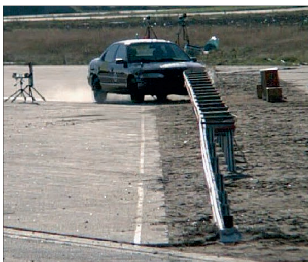
Bild 4-220: Anprallvorgang – Ansicht von vorne t = 72 ms; Quelle: DEKRA
