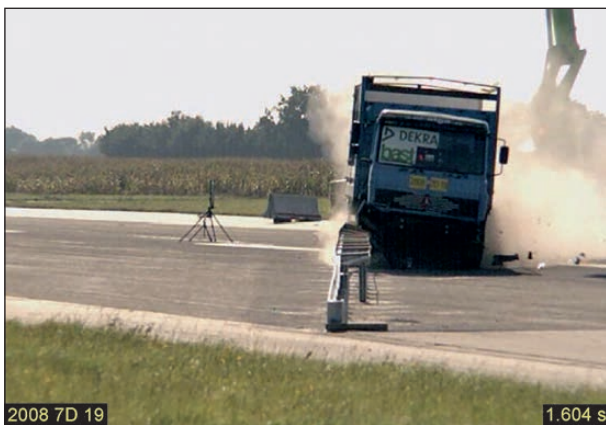
Bild 4-7: Anprallvorgang – Ansicht von vorne t = 1,604 s; Quelle: DEKRA
