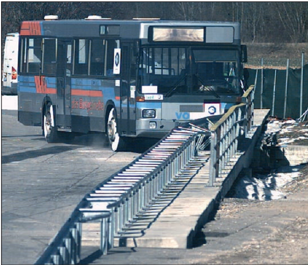
Bild 4-62: Anprallvorgang – Ansicht von vorne 2; Quelle: TÜV Süd
