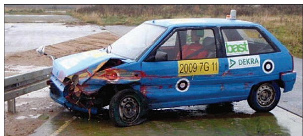
Bild 4-218: Schäden am Fahrzeug nach der Prüfung und Sekundärprall; Quelle: DEKRA
