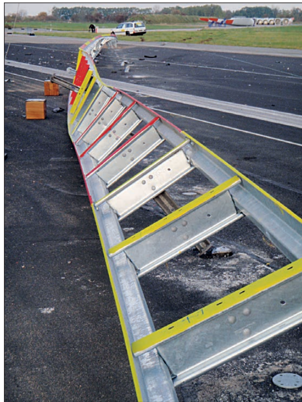
Bild 4-40: Übersicht über die Situation nach der Prüfung und Fahrzeug in Endstellung; Blick in Anfahrrichtung; Quelle: DEKRA
