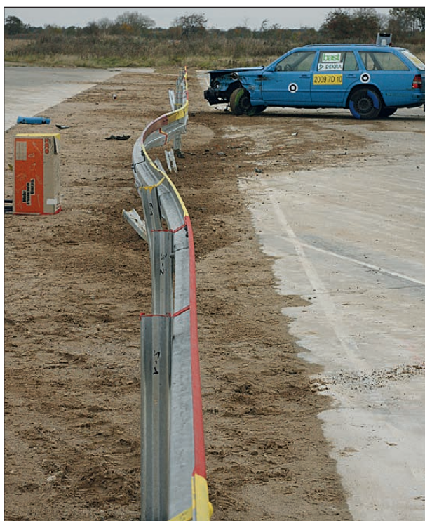
Bild 4-151: Durchbiegung der Schutzeinrichtung
