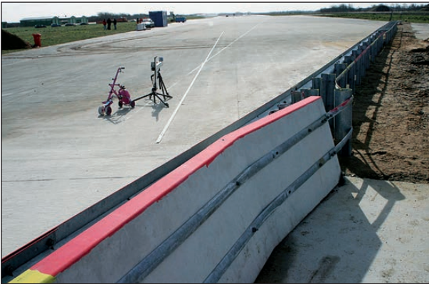
Bild 4-86: Betonfertigteil (Verziehungselement); Ansicht entgegen Anprallrichtung
