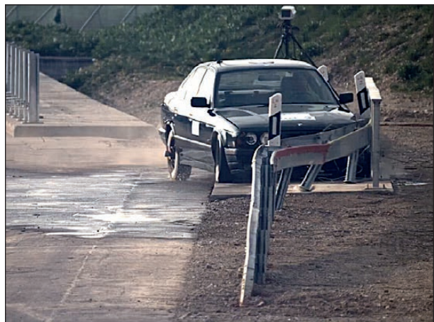
Bild 4-199: Anprallvorgang – Ansicht von vorne 3; Quelle: TÜV Süd
