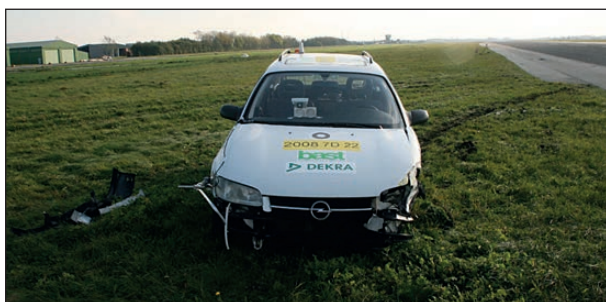
Bild 4-42: Schäden an der Fahrzeugfront des Versuchsfahrzeug
