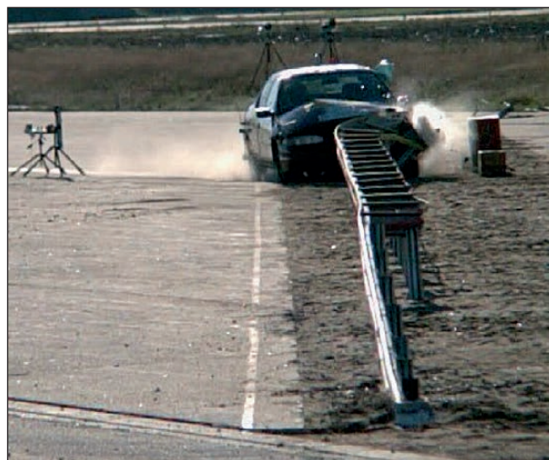
Bild 4-221: Anprallvorgang – Ansicht von vorne t = 180 ms; Quelle: DEKRA
