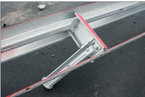
Bild 4-31: Verschraubung der Pfostensicherung am Abstandhalter nach dem Versuch
