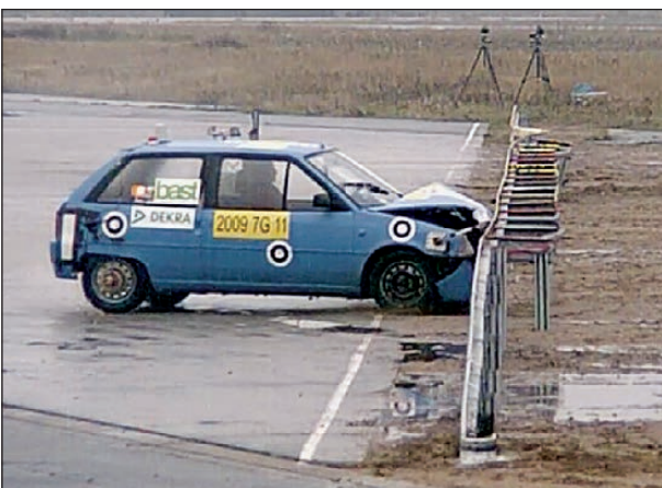
Bild 4-216: Sekundärprall – Ansicht von vorne t = 1.912 ms; Quelle: DEKRA
