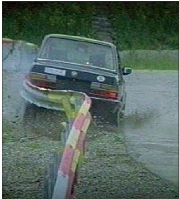
Bild 4-166: Anprall ESP 2.0 (Ansicht von hinten); Quelle: TÜV Süd
