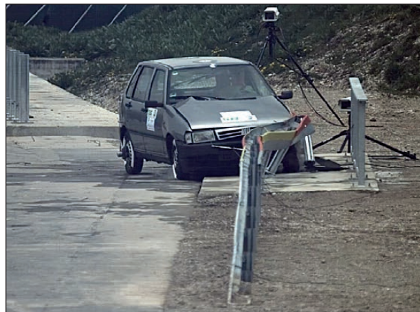
Bild 4-188: Anprallvorgang – Ansicht von vorne 2; Quelle: TÜV Süd
