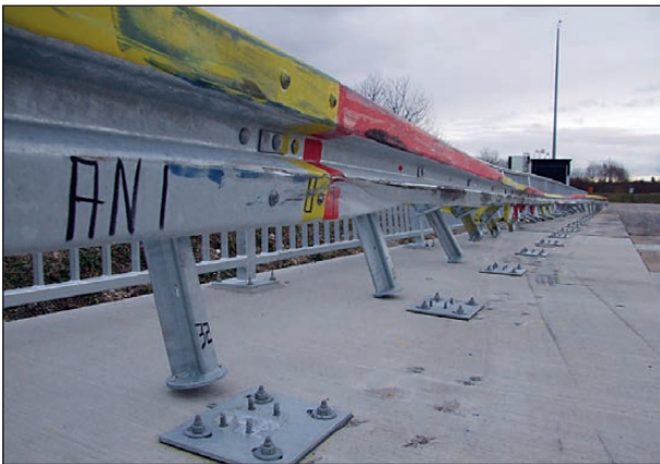
Bild 4-82: Kontaktbereich in Anprallrichtung; Quelle: TÜV Süd
