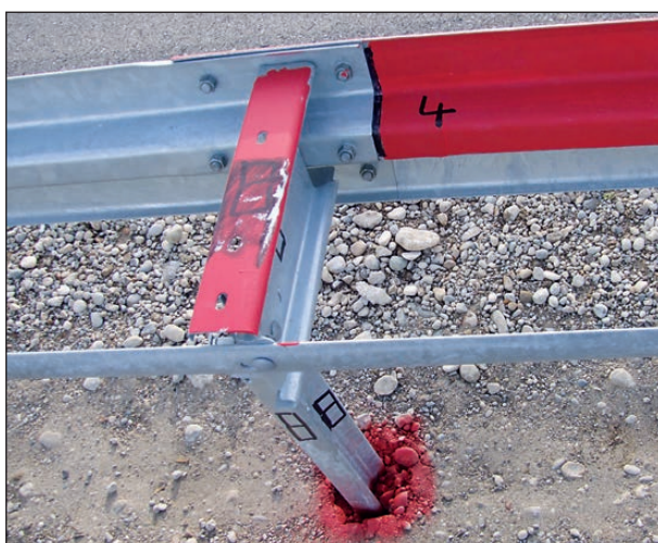
Bild 4-249: Detailansicht der Reifenspuren auf dem Distanzstück 8
