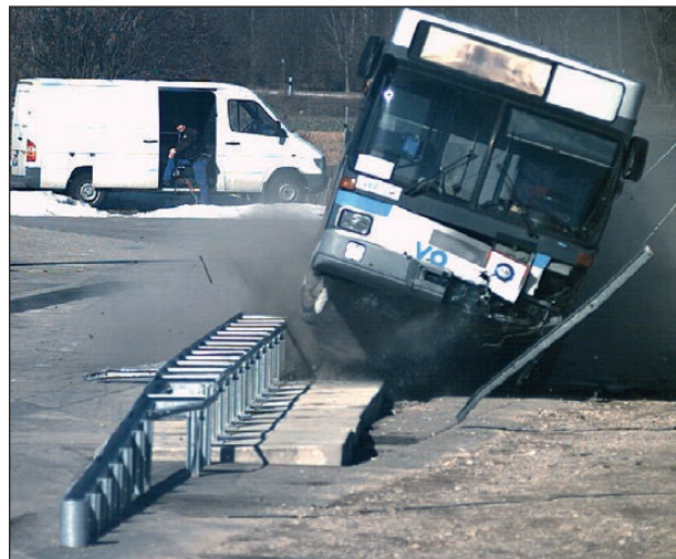
Bild 4-66: Anprallvorgang – Ansicht von vorne 6; Quelle: TÜV Süd
