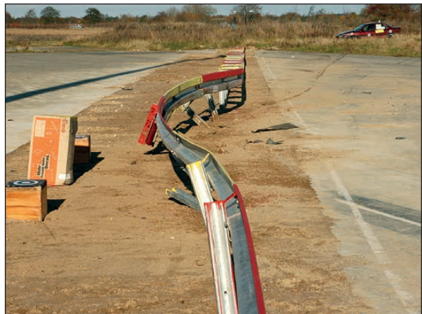
Bild 4-228: Durchbiegung der Schutzeinrichtung und Fahrzeug in Endstellung
