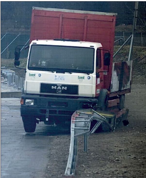
Bild 4-180: Anprall kurzEDSP 2.0 (Ansicht von vorn); Quelle: TÜV Süd
