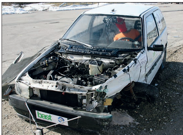
Bild 4-59: Schäden am Fahrzeug nach der Prüfung (Fahrerseite und Front)
