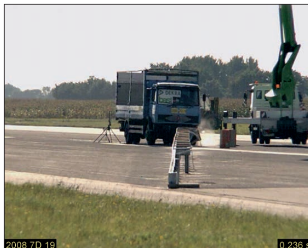
Bild 4-3: Anprallvorgang – Ansicht von vorne t = 0,236 s; Quelle: DEKRA
