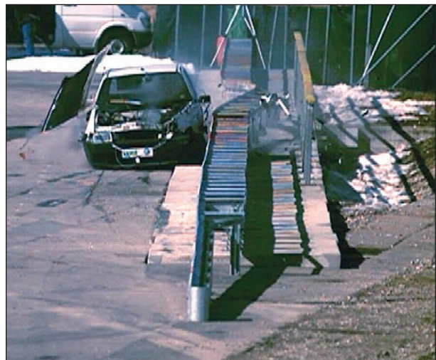
Bild 4-56: Anprallvorgang – Ansicht von vorne 6; Quelle: TÜV Süd
