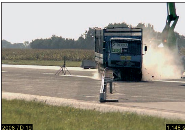
Bild 4-6: Anprallvorgang – Ansicht von vorne t = 1,148 s; Quelle: DEKRA
