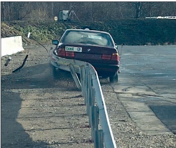
Bild 4-165: Anprall kurzESP 2.0 (Ansicht von hinten); Quelle: TÜV Süd
