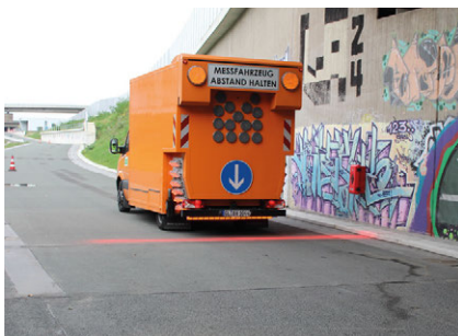
Messfahrzeug MEFA der BAST bei einem Einsatz auf der Referenzstrecke für Längsebenheit des duraBAST
