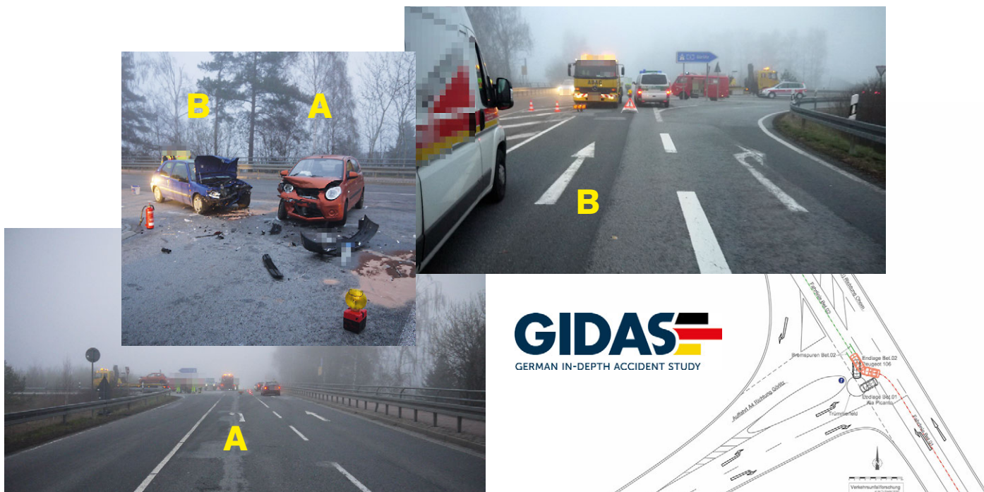
Beispielfall aus GIDAS, der vertieft untersucht wurde zum Thema Verkehrsunfälle zwischen 2 Pkw an Kreuzungen – Fahrzeug A: Abbieger und Fahrzeug B: Vorfahrtsberechtigter
