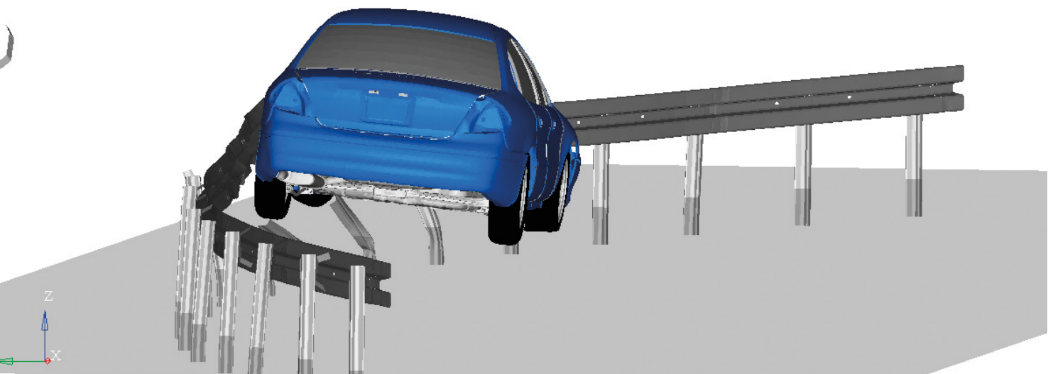
Anprall gegen Schutzplanke in einer Kurve
