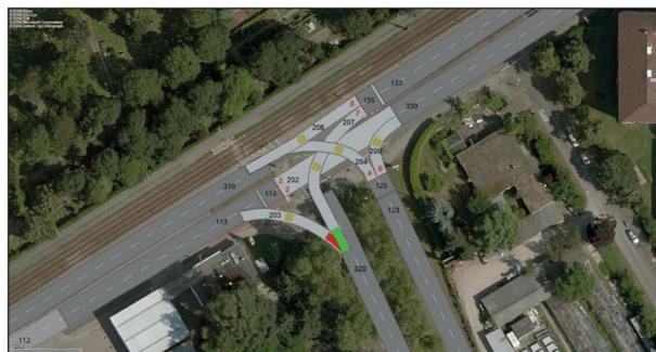
Bild 4-1: Screenshot aus VISSIM zur Veranschaulichung des Modellaufbaus der Knotenpunkte mit Lichtsignalanlage
