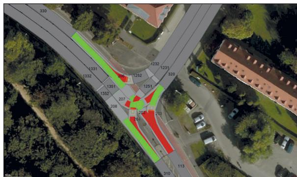
Bild 4-22: Screenshot aus VISSIM zur Veranschaulichung des Modellaufbaus der Knotenpunkte ohne Lichtsignalanlage
