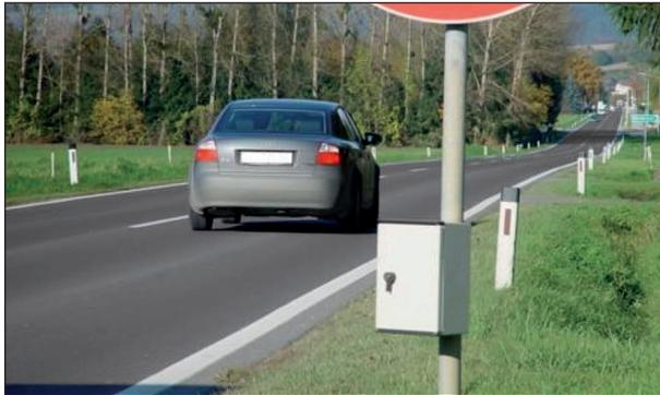
Bild 3-7: Befestigung des Seitenradars an einem Schilderpfosten (Quelle: SIERZEGA (2012))
