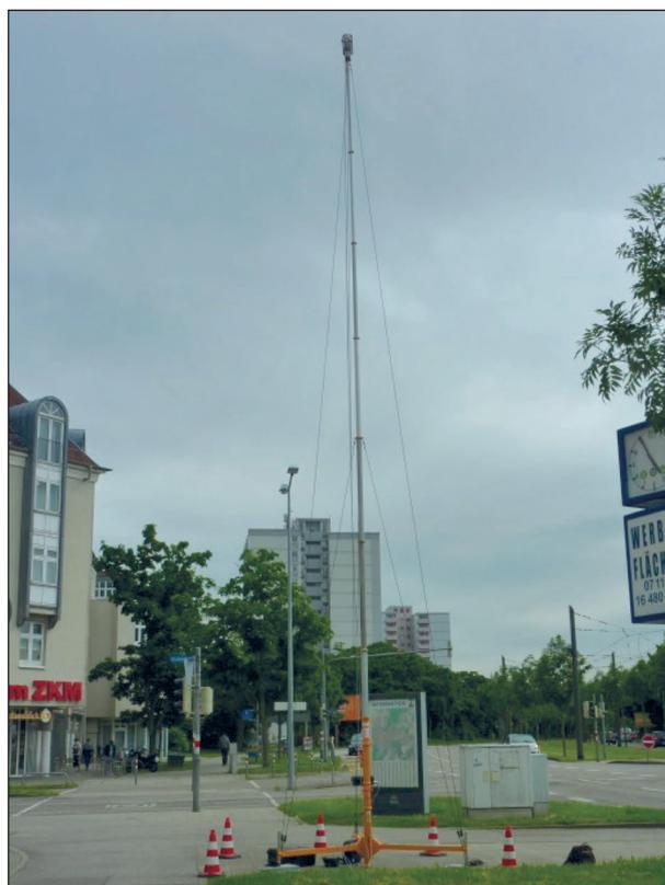
Bild 3-3: Hochstativ, auf 12 m Höhe vollständig ausgefahren
