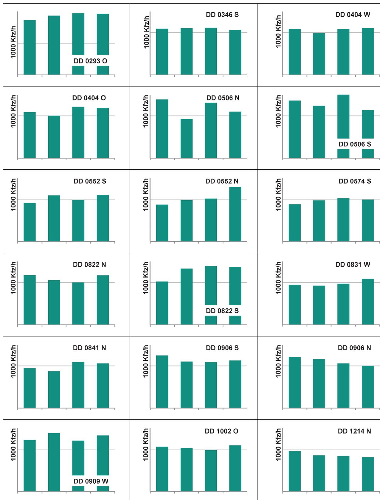
Bild 6-2: Kompakte Darstellung der Spitzenstundengänglinien einzelner Pegelzählstellen in 15-Minuten-Intervallen (x-Achse: 15-Minuten-Intervalle, y-Achse: Verkehrsstärke in Kfz/h, Markierung bei 1.000 Kfz/h)
