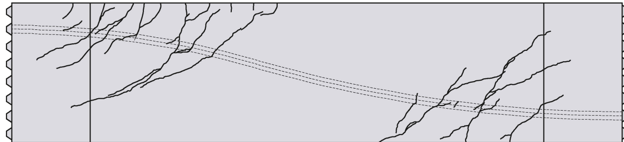
A 72: Rissbild, Laststufe 75% V_{\max}
