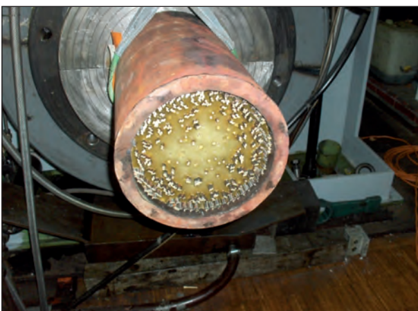
Bild 4.43: Seilkopf dritter Bauteilversuch mit Kunststoffverguss
