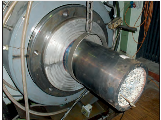
Bild 4.17: Die Verankerung bei der Krafteinleitung
