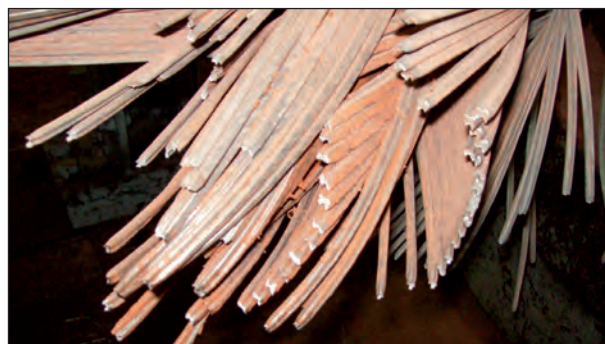
Bild 4.41: Bruchflächen der einzelnen Drähte
