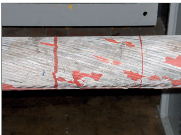
Bild 4.55: Zwei weitere Drahtbrüche, genaue Lage unbekannt
