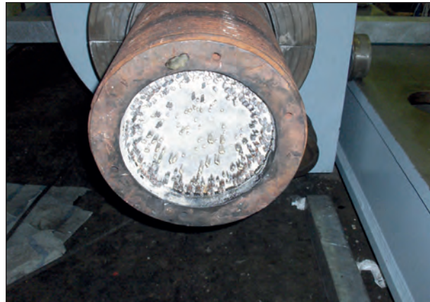
Bild 4.44: Seilkopf dritter Bauteilversuch mit Kunststoffverguss
