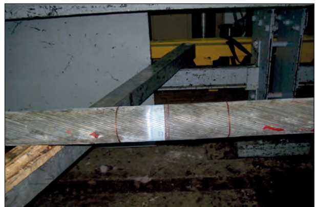
Bild 4.75: Eingebaute Probe mit Blick auf die Vorschädigung
