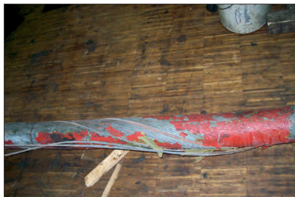
Bild 4.82: Drahtverbund nach dem Bruchlastversuch
