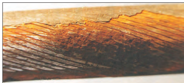
Bild 3.54: Detailaufnahme eines Korrosionsschadens
