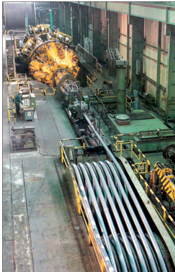
Bild 2.5: Herstellung eines Seiles mit Durchmesser von 167 mm [11]
