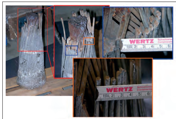
Bild 6.10: Metallografische Untersuchungen an einzelnen Bruchflächen
