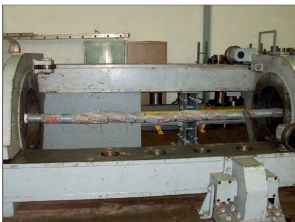
Bild 4.63: 4. Bauteilprobe nach dem Bruchlastversuch
