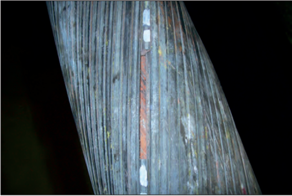
Bild 4.77: Drahtbruchstelle aus dem Ermüdungsversuch
