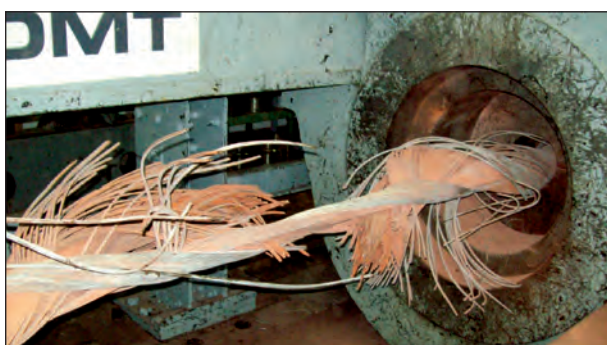
Bild 4.40: Detailansicht der Bauteilprobe nach dem Bruchversuch
