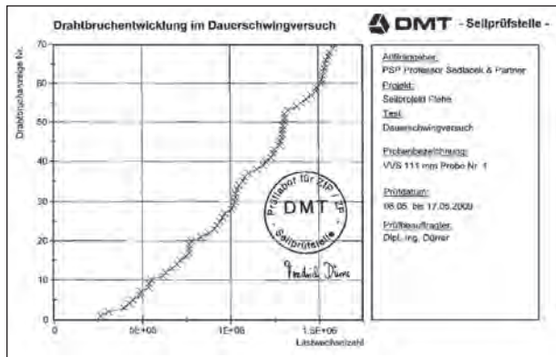
Bild 4.23: Entwicklung der Drahtbrüche mit zugehörigen Lastwechseln
