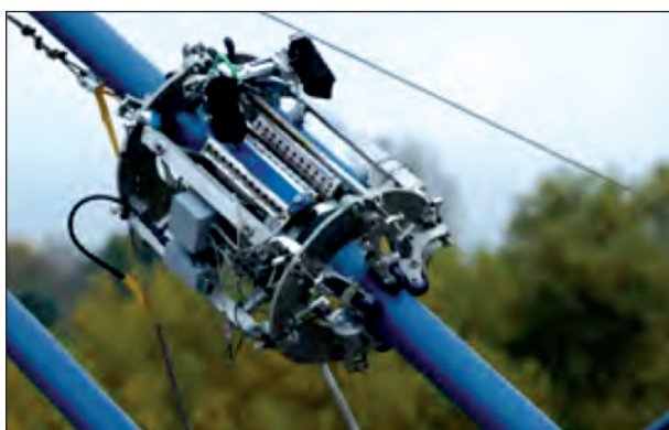
Bild 8.3: Magnetinduktives Seilprüfgerät (Bild: www.alpintechnik.de )
