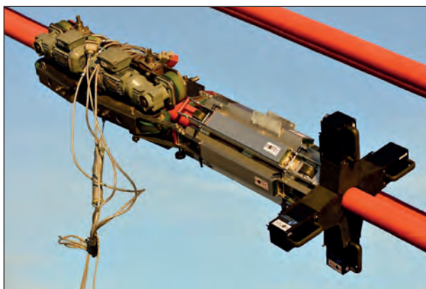
Bild 8.4: Zerstörungsfreie Seilprüfung bestehend aus Selbstfahrer, magnetinduktivem Seilprüfgerät und visuellem Seilprüfgerät (Bild: Fa. Rotec, Stuttgart)
