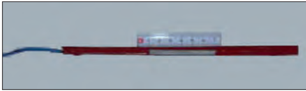
Bild 5.11: Einzelner Draht als Probekörper
