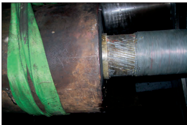
Bild 4.80: Setzung im Seilkopf
