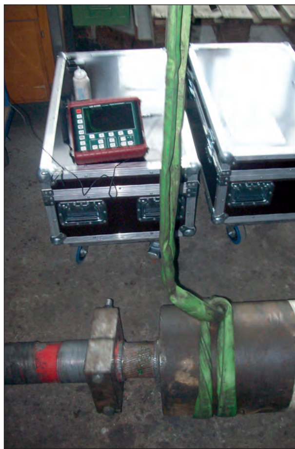
Bild 4.83: Ultraschalluntersuchung am ausgebauten Versuchskörper
