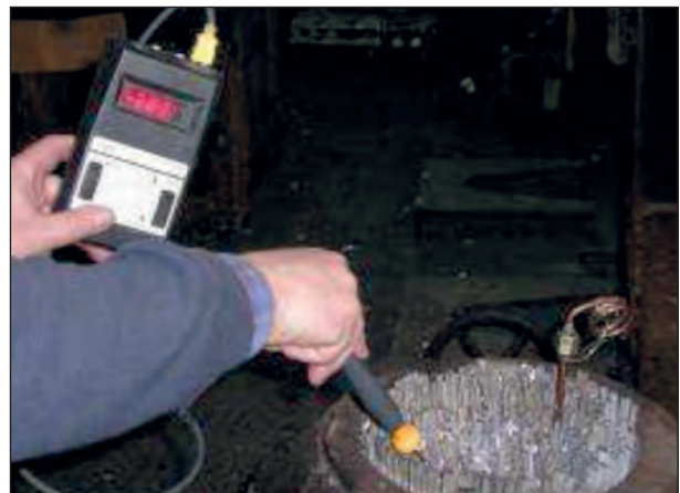
Bild 4.10: Überprüfung des Seilvergusses
