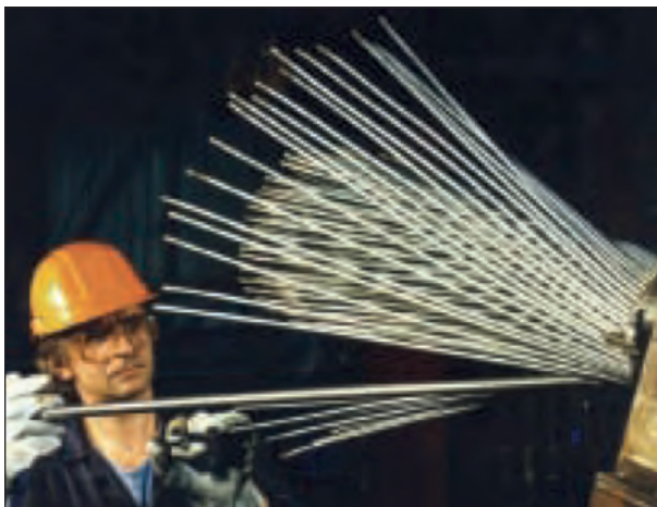
Bild 4.6: Aufbiegen einiger Drähte mit einem Rohr
