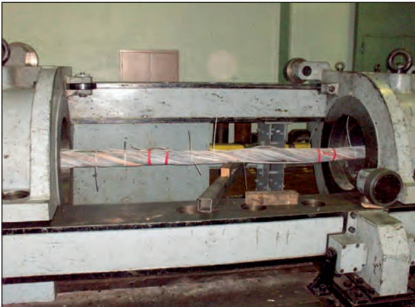
Bild 4.30: Versuchseinrichtung zur Ermittlung der Restbruchkraft
