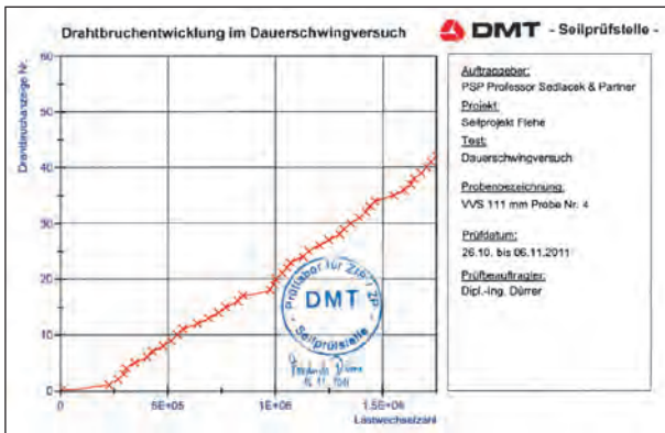
Bild 4.60: Drahtbruchentwicklung bei dem 4. Versuch
