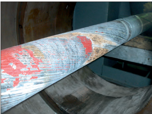
Bild 4.42: Probe dritter Bauteilversuch mit natürlicher Korrosion
