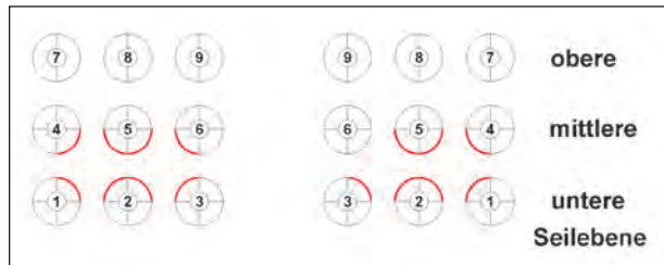
Bild 3.20: Bereiche mit starker Korrosion
