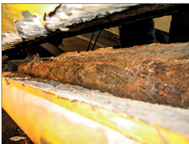
Bild 3.12: Zustand der Seile nach dem Spreizen
