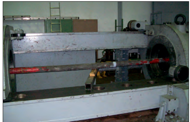
Bild 4.74: Eingebaute Probe für den Bruchlastversuch
