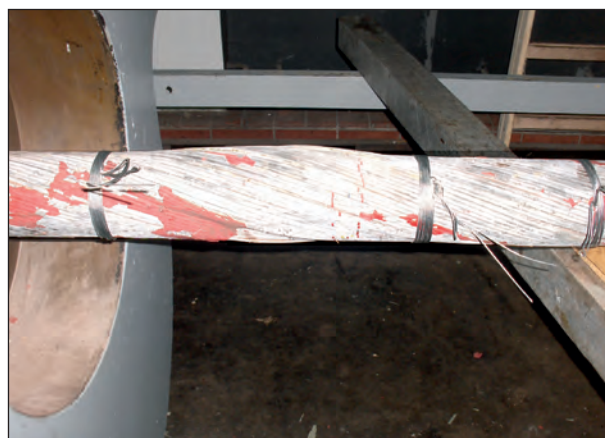
Bild 4.58: Abbändelung zur Sicherung des Verbundes erforderlich
