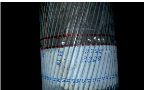
Bild 4.68: Bereich mit künstlichen Narben (Stelle mit 1,5 mm und 4er Gruppe mit 0,5 mm Tiefe)
