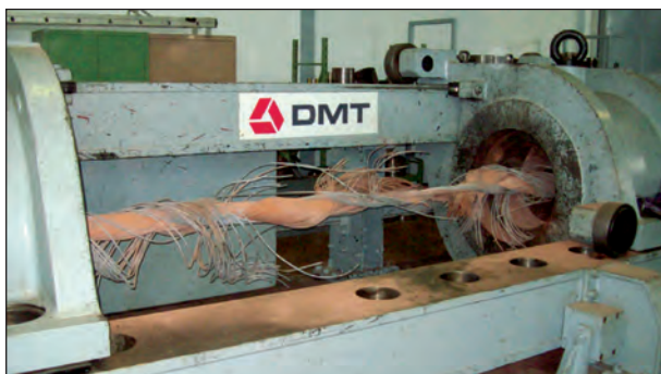
Bild 4.39: Bauteilprobe nach dem Zerreißversuch
