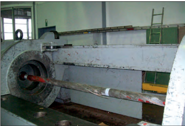
Bild 4.78: Seil nach dem Bruchlastversuch
