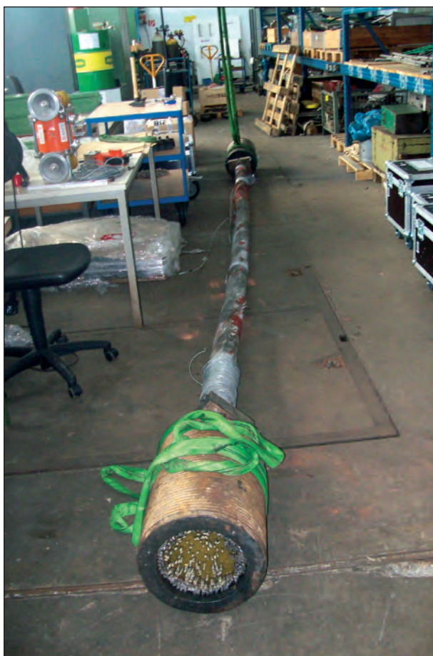
Bild 4.81: Ausgebauete Probe des 5. Bauteilversuchs
