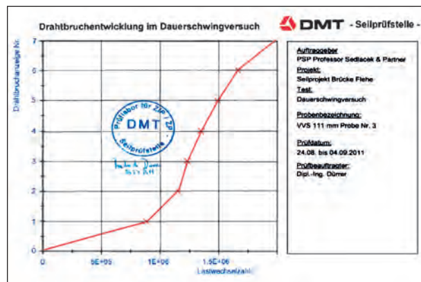
Bild 4.45: Drahtbruchentwicklung bei dem dritten Bauteilversuch
