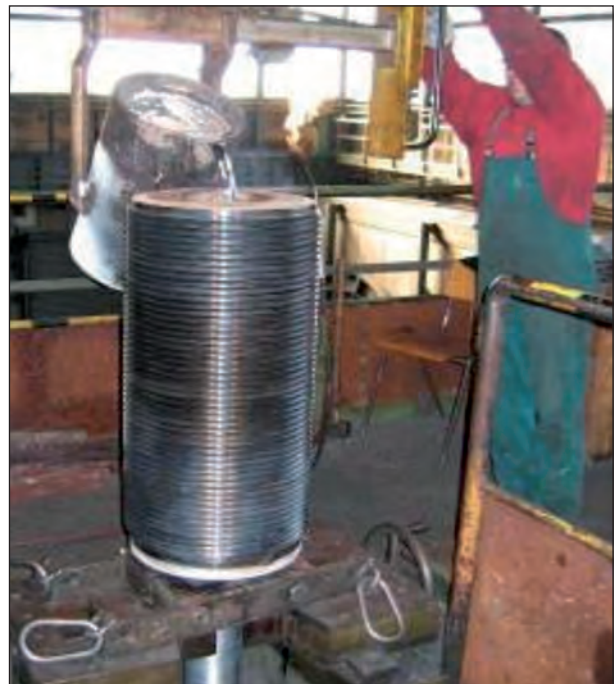
Bild 4.9: Einfüllen des Vergussmaterials im ausgerichteten Zustand
