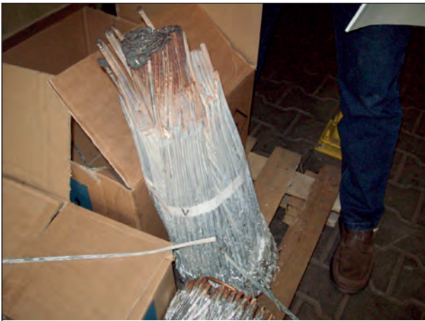
Bild 6.8: Ausgelöstes Seilende aus dem ‚dynamischen‘ Seilkopf
