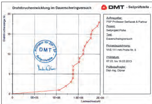
Bild 4.72: Drahtbruchentwicklung beim 5. Versuch abhängig von den Lastwechselzahlen
