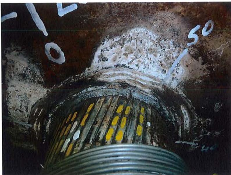
**Bild 12** Seilkopf Loslager, äußere Drahtlage, Draht 50 bis Draht 58
