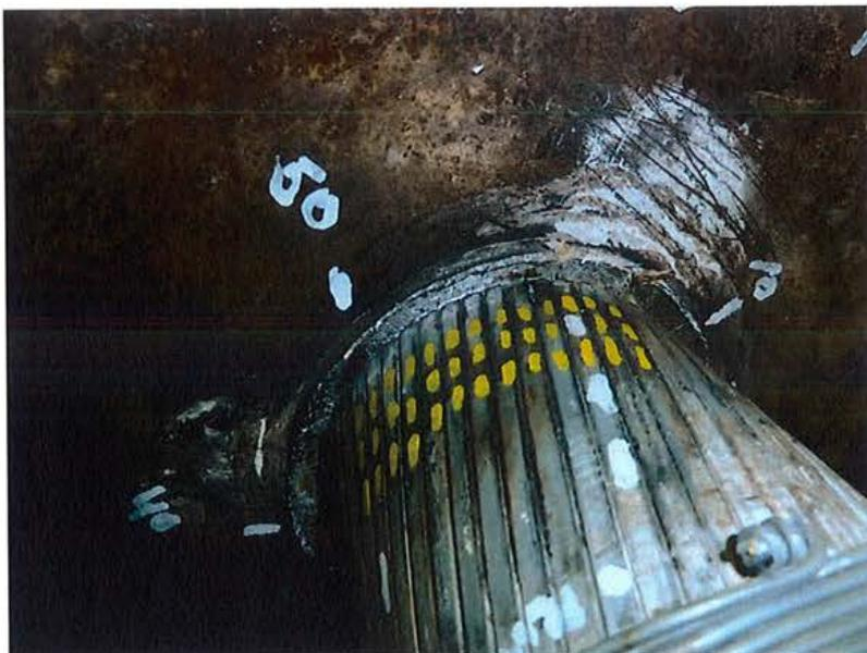
**Bild 6**    Seilkopf Festlager, äußere Drahtlage, Draht 50 bis Draht 58
