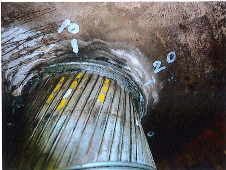
**Bild 2**    Seilkopf Festlager, äußere Drahtlage, Draht 10 bis Draht 20
