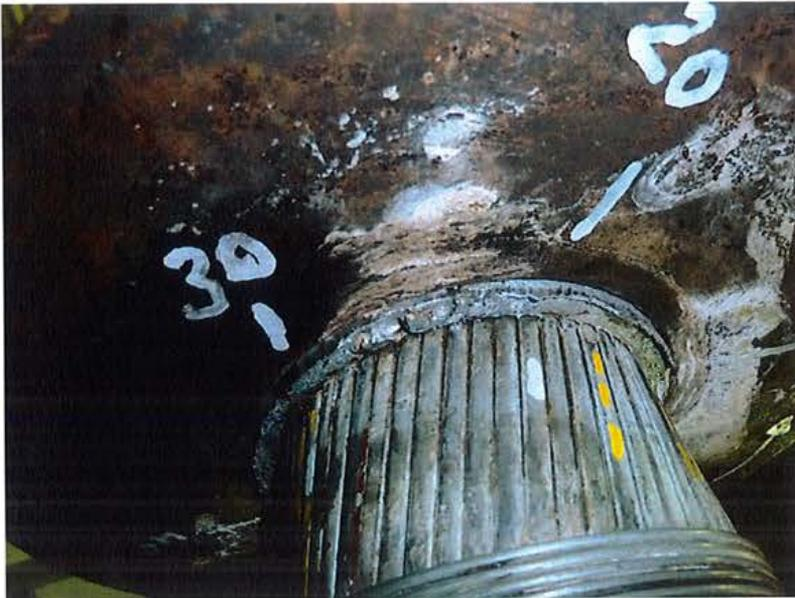
**Bild 9**    Seilkopf Loslager, äußere Drahtlage, Draht 20 bis Draht 30
