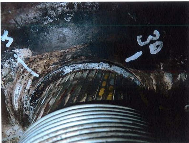
**Bild 10**    Seilkopf Loslager, äußere Drahtlage, Draht 30 bis Draht 40
