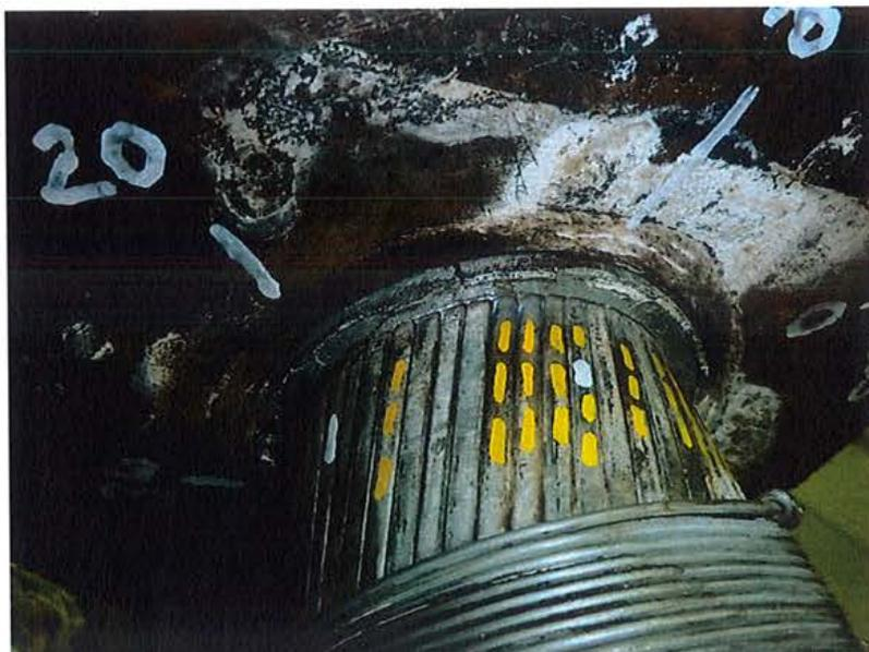
**Bild 8**    Seilkopf Loslager, äußere Drahtlage, Draht 10 bis Draht 20
