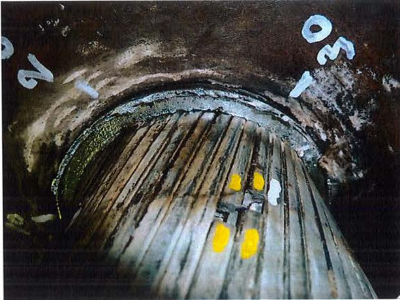
**Bild 3**    Seilkopf Festlager, äußere Drahtlage, Draht 20 bis Draht 30
