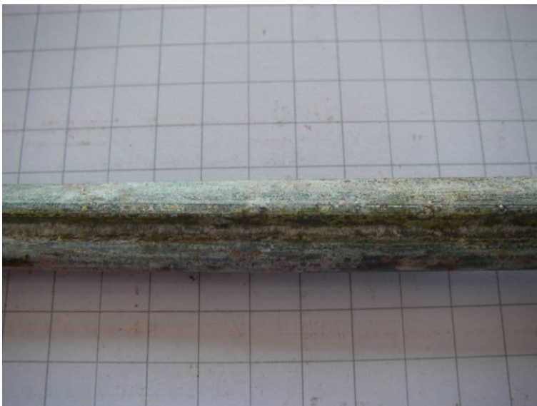
Bild 5 Einzeldraht aus Seilprobe 1 mit mäßigem Angriff auf die Verzinkung
