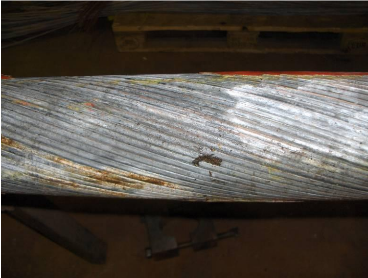
Bild 4 Seilprobe 1: schwache bis geringe Korrosion an einigen Außendrähten sowie mäßiger Angriff auf die Verzinkung
