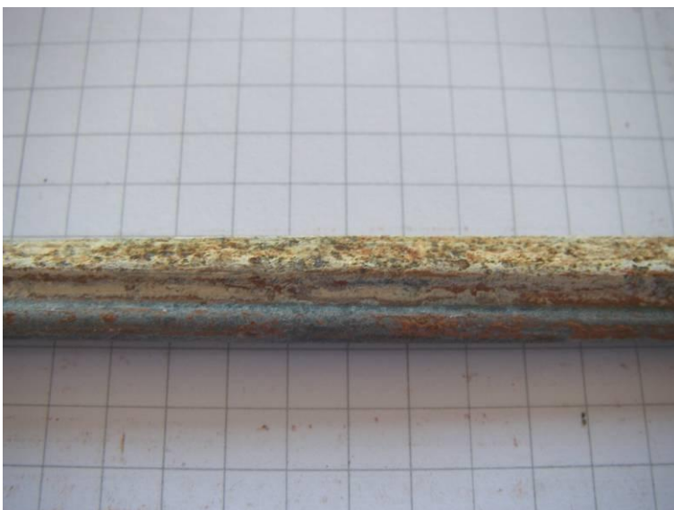
Bild 7 geringe Korrosion auf einem Außendraht von Seilprobe 1
