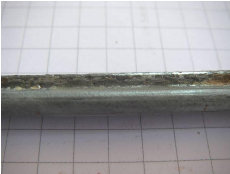
Bild 16 gereinigter Drahtabschnitt aus Bild 15; Verzinkung ist teilweise bis über den Rand der Außenfläche verbraucht
