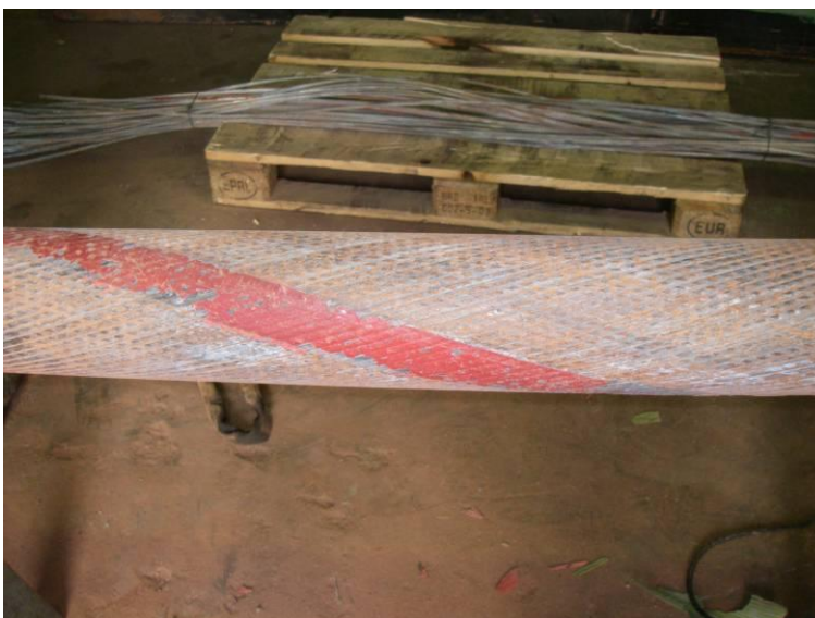
Bild 19 Blick auf 9. Drahtlage von Seilprobe 1
