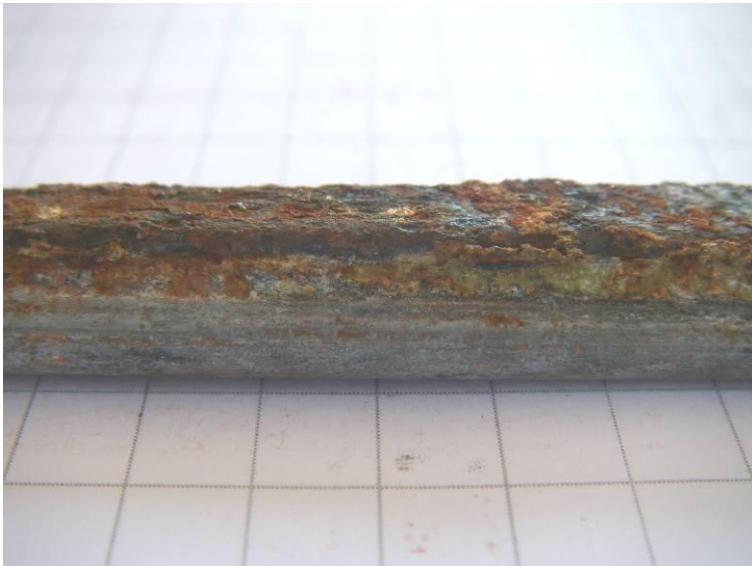
Bild 15 starke Korrosion auf der Drahtaußenfläche sowie am Rand (Seilprobe 4)
