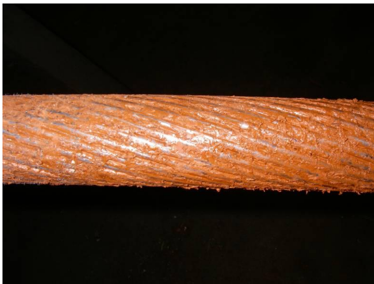
Bild 29 4. Drahtlage von Seilprobe 5
