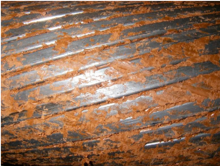
Bild 24 7. Drahtlage von Seilprobe 1
