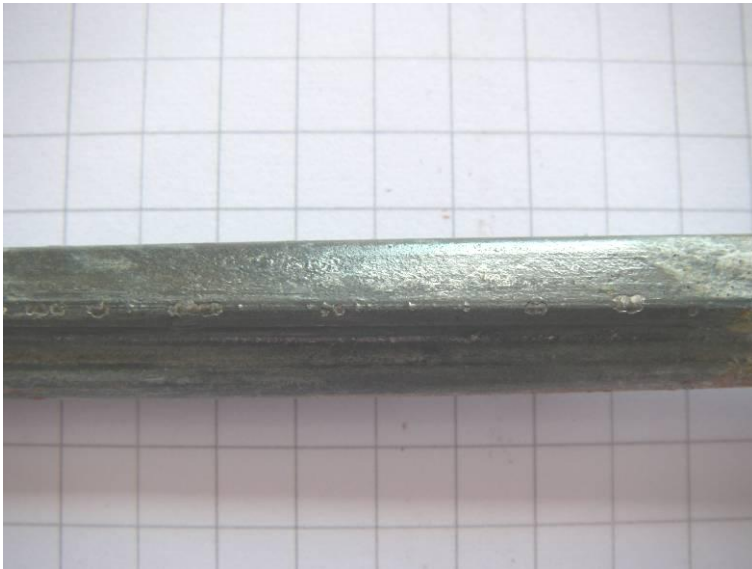
Bild 6 gereinigter Drahtabschnitt im Vergleich zu Bild 5; Verzinkung teilweise am Rand verbraucht
