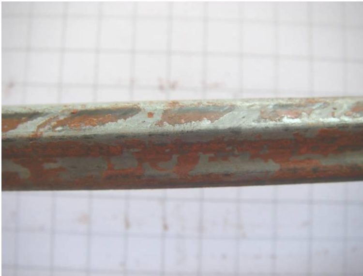
Bild 20 Z-Profildraht der 9. Drahtlage mit sehr schwachen Druckstellen in der Verzinkung
