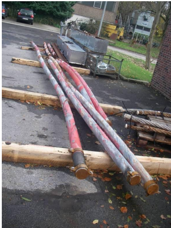
Bild 2 Seilproben im Anlieferungszustand
