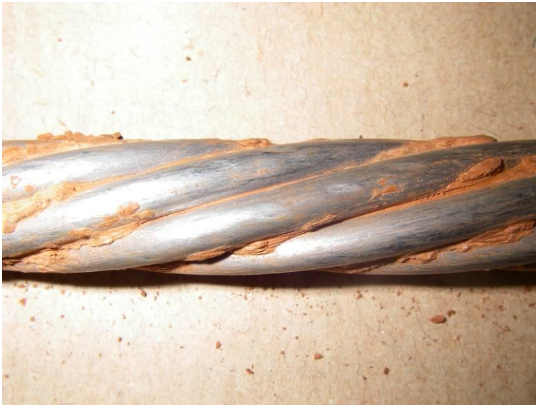
Bild 36 Seilabschnitt aus Bild 35 mit Drahtbürste gereinigt
