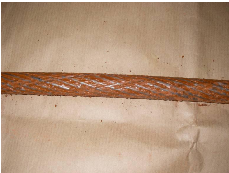
Bild 33 2. Drahtlage von Seilprobe 2
