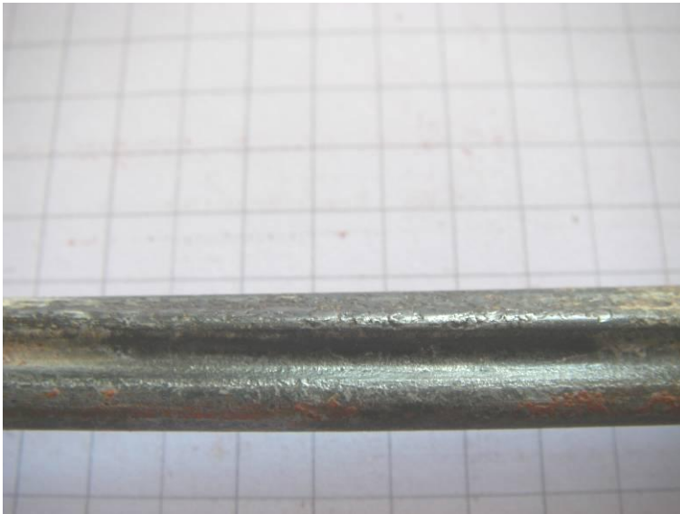
Bild 8 gereinigter Drahtabschnitt aus Bild 7; teilweise ist die Verzinkung an der Oberfläche bzw. am Rand verbraucht
