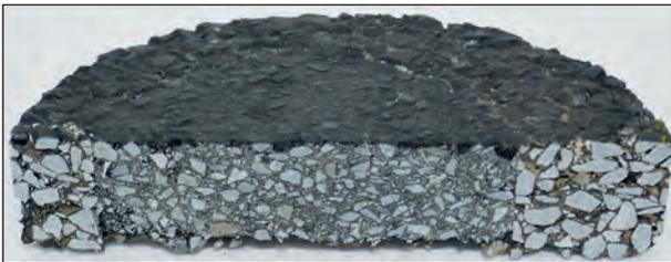
Bild 4-24: Entnommene Bohrkernscheibe an Position H1 (KMG)
