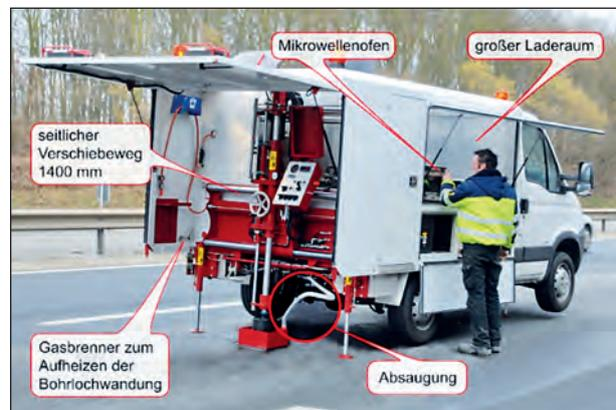
Bild 2-7: Probenahmefahrzeug mit integriertem Bohrergerät und Mikrowellenofen [14] © Labor Hart
