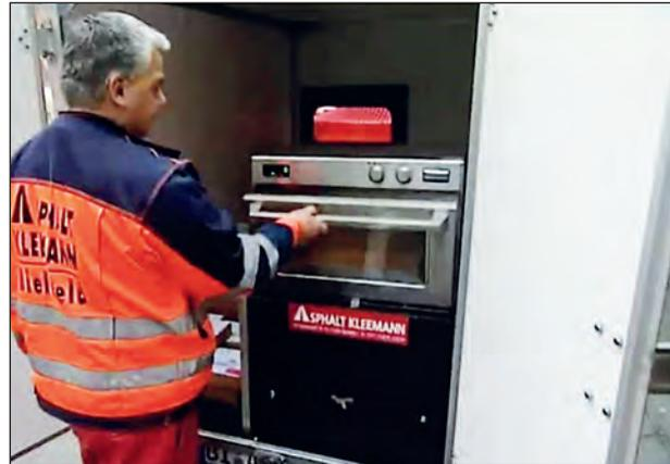
Bild 2-6: Transportable Mikrowelle zum Erhitzen der Asphaltportion [12] © Kleemann
