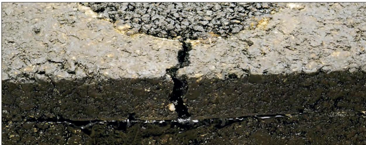
Bild 3-3: Schädigung des Asphaltkörpers im Bereich der Deckschichtplatte nach einem Vorversuch mit höherer Oberspannung
