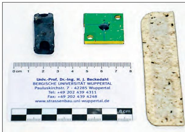
Bild 5-3: RFID-Transponder nach dem Ausbau aus den Marshall-Probekörpern (Typ 1 links, Typ 2 Mitte, Typ 3 rechts)
