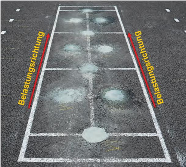
Bild 4-3: Versuchsfeld nach dem Einbau der Verschlussvarianten
