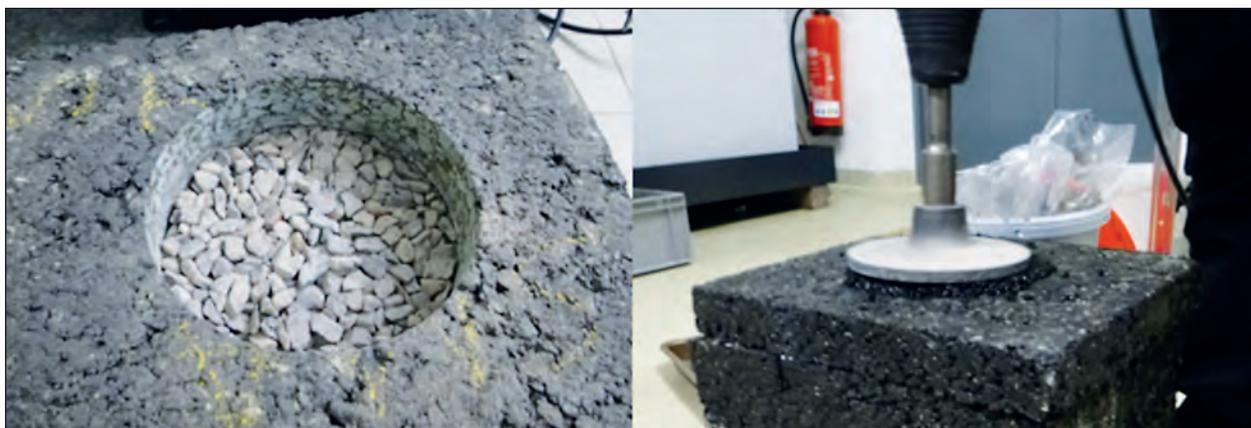
Bild 3-4: links: verdichtete Gesteinskörnung 8/11; rechts: Verdichtung von KMG-R mit einem elektrischen Bohrhammer mit Stampferplatte
