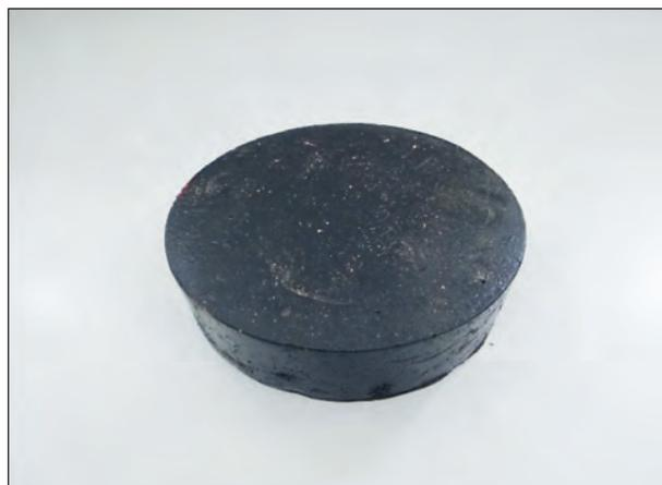
Bild 2-4: Bitumen-Bohrstopfen
