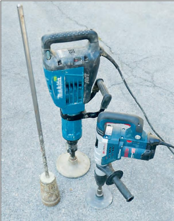
Bild 2-5: Handstamper  $\varnothing$  100 mm (links), Schlaghammer mit Verdichtungsplatte  $\varnothing$  200 mm (Mitte) und  $\varnothing$ 140 mm (rechts)
