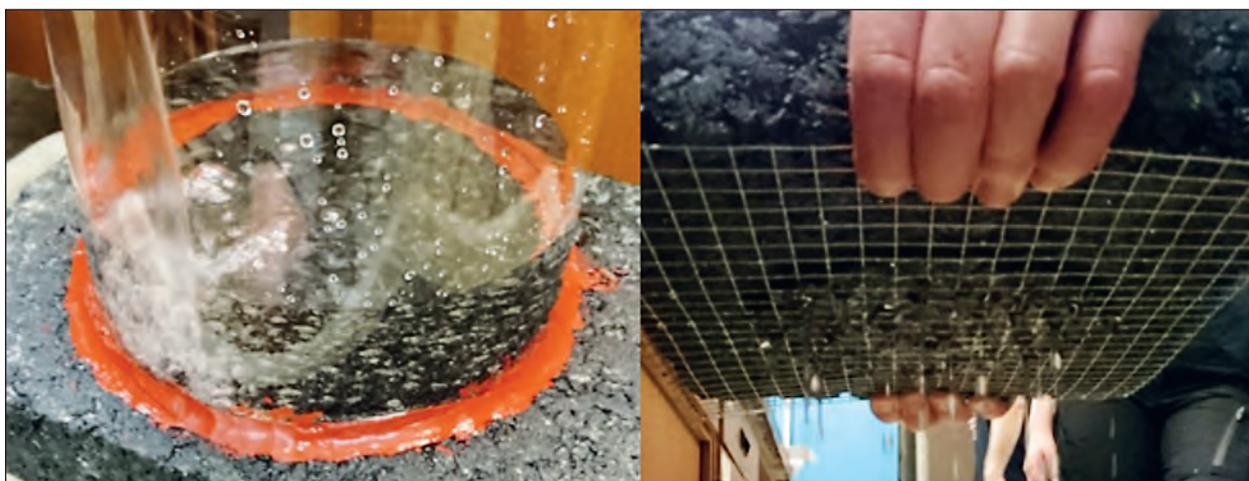
Bild 3-2: Dichtigkeitsprüfung mit Kaltmischgut; links: Versuchsaufbau, rechts: durchlaufendes Wasser während der Prüfung
