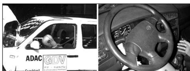
**Bild 5-19:** Leichter Lenkradkontakt; Airbag löste nicht aus
