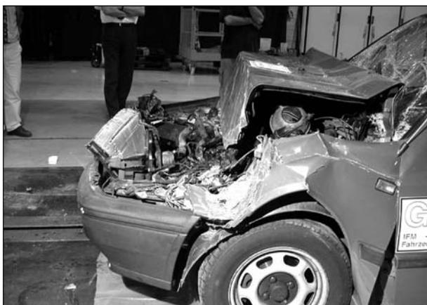
**Bild 5-15:** Noch gute Funktion des Airbagsystems bei starrem Unterfahrschutz (Höhe nach 70/221/EWG 550 mm)
