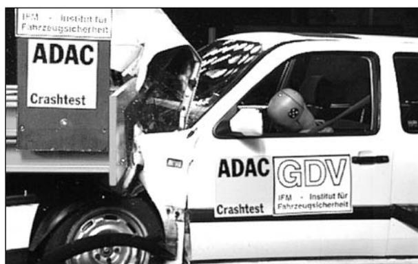
**Bild 5-18:** Keine Auslösung des Airbags bei 40 km/h und 40 % Überdeckung
