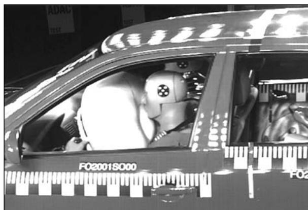
**Bild 5-8:** Beginn der Vorverlagerung des Dummies ca. 15 ms nach der Zündung des Airbags
