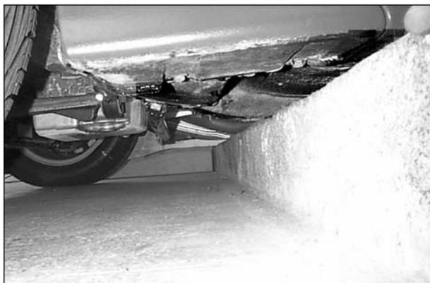
**Bild 5-1:** Aufsetzen auf Schweller
