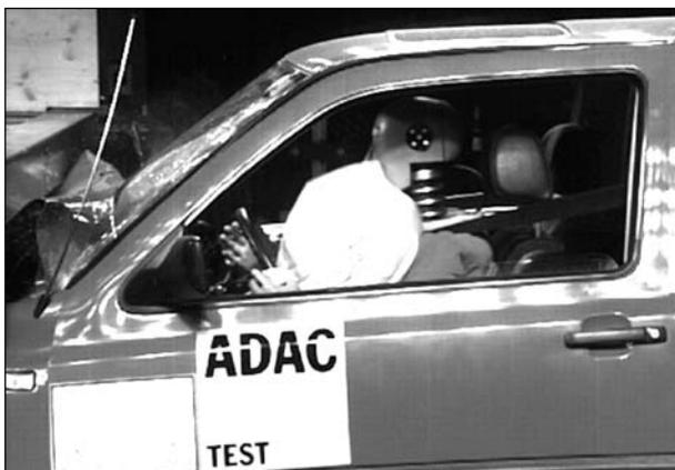
**Bild 5-14:** Verspätete Auslösung des Airbags
