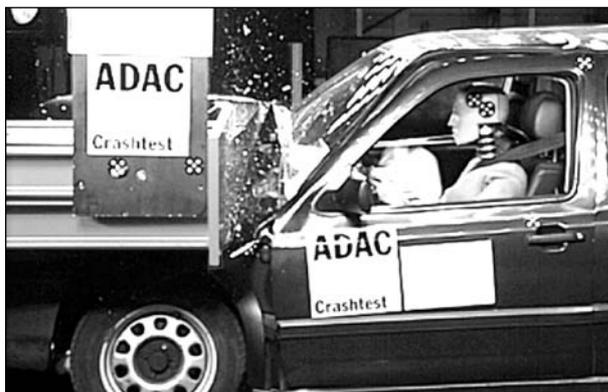
**Bild 5-23:** Airbagauslösung nach 80 ms (40 % Überdeckung, 50 km/h)
