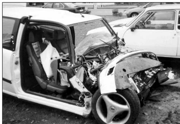
Bild 4-8: Lkw-Unterfahung mit Airbag-Auslösung
