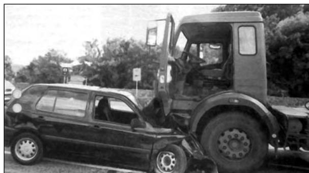
Bild 4-7: Lkw-Unterfahung ohne Airbag-Auslösung
