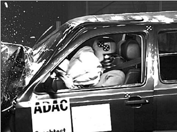
**Bild 5-25:** Dummy wird vom Airbag angeschossen
