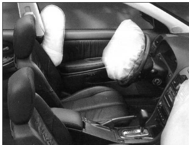
Bild 3-1: Integrierter Kopfschutz im Thoraxairbag von Nissan
