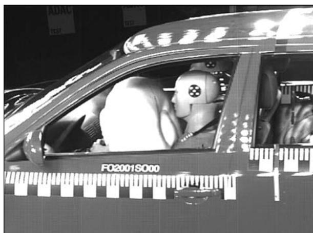
**Bild 5-5:** Vollständige Airbagentfaltung nach ca. 20–30 ms
