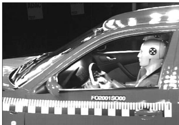
**Bild 5-7:** Airbag wird gezündet, Dummy bewegt sich nicht
