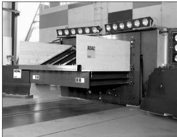
Bild 5-10: Idealisiertes Lkw-Heckunterfahrerschutzsystem (Abmessungen nach 70/221/EWG)
