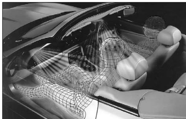
**Bild 6-5:** Radarsensoren im Fahrzeug, um die Insassenpositionen zu erkennen, Presseinformation Jaguar
