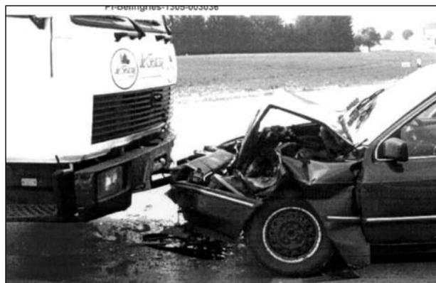
**Bild 5-16:** Kollision mit ca. 40 % Überdeckung und schweren Verletzungen des Beifahrers
