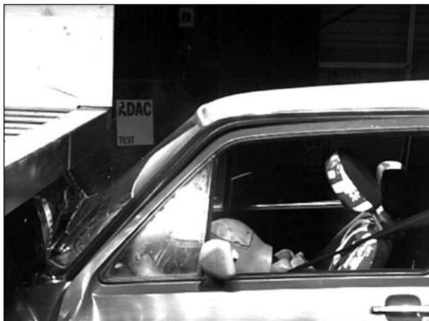
Bild 5-12: Lenkradkontakt im Vortest (Golf II)
