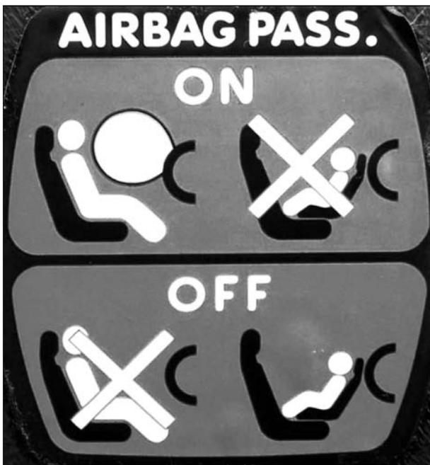
Bild 3-6: Missverständliches Airbag-Label für das Abschalten des Beifahrerairbags
