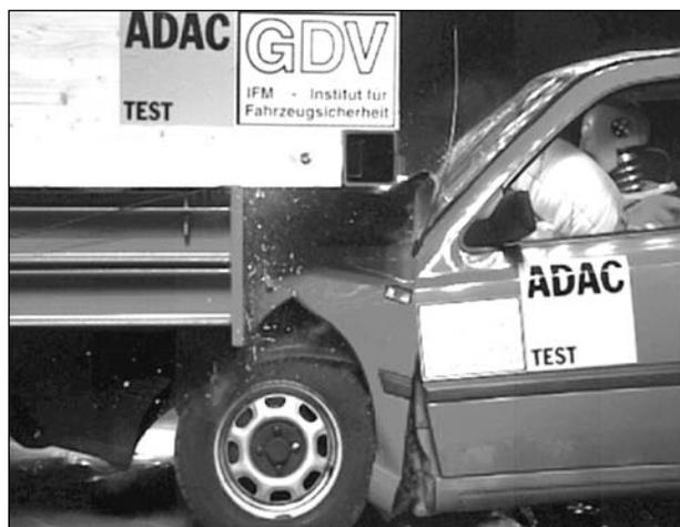
Bild 5-11: Airbagschutz trotz Unterfahung
