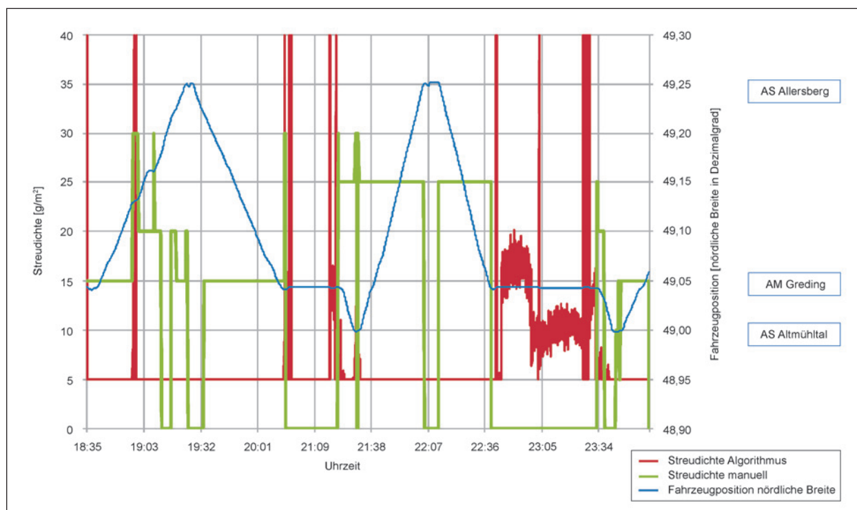
Bild 10-19: Gegenüberstellung der manuell eingestellten Streudichten mit den durch den Algorithmus errechneten Streudichten bei einer Einsatzfahrt der AM Greding am 17.02.2018
