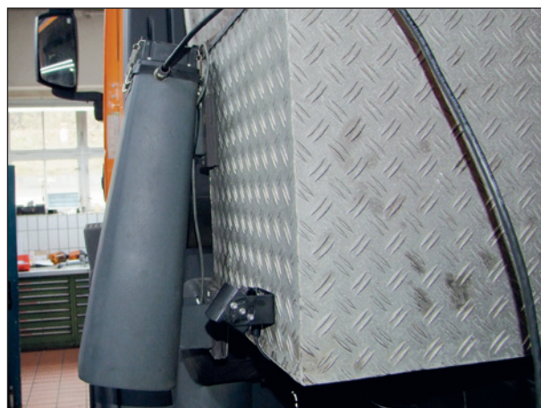
Bild 5-8: MARWIS-Sensor und daneben montierte Kamera der AM Greding. Ab Saison 2017/18 war die Kamera schräg nach hinten ausgerichtet
