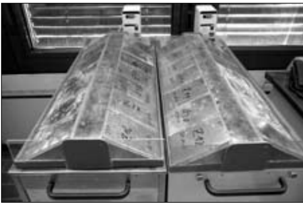
Bild 9: Versuchsdurchführung zur Bestimmung der Beständigkeit gegen Feuchtigkeit
