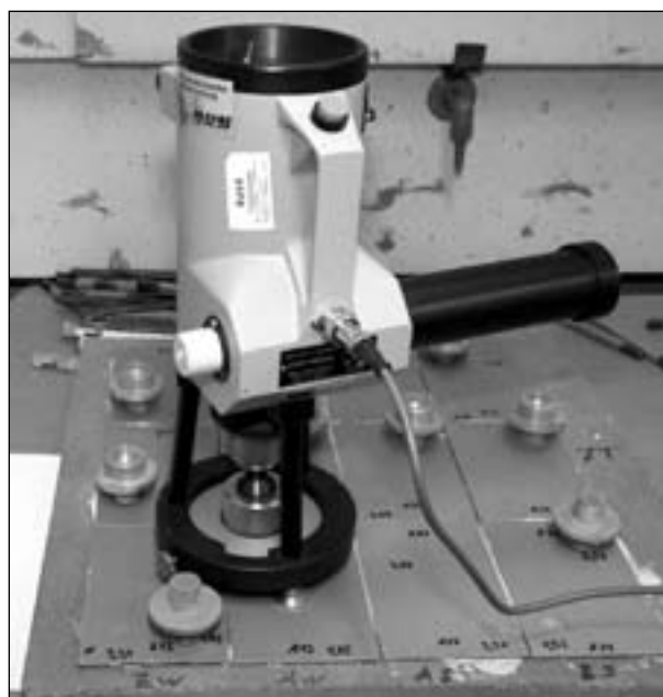
Bild 12: Aufgeklebte Probekörper und Zugprüfgerät
