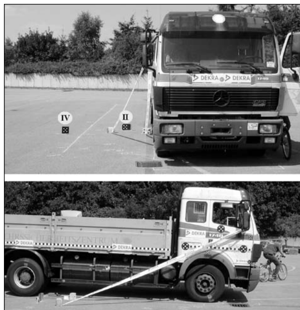
Bild 75: Aufnahme zur Darstellung des indirekten Sichtfeldes über den Hauptaußenspiegel eines Lkw (Mercedes Benz 1748), die Markierungsbänder kennzeichnen die Untergrenze der Abbildung im Spiegel und die Eckpunkte des realen Sichtfeldes am Boden, schwarze Markierungstafeln (5-Punkt-Targets) auf dem Boden kennzeichnen die vorderen Eckpunkte des Soll-sichtfeldes entsprechend ECE-R 46 (links Gruppe IV (s. Bild 3) und rechts Gruppe II (s. Bild 2))
