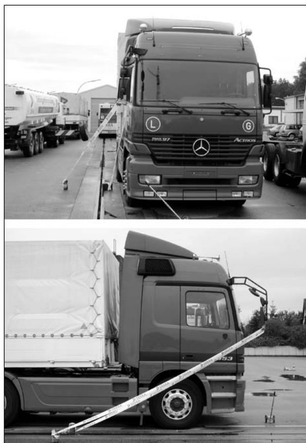
Bild 76: Aufnahme zur Darstellung des indirekten Sichtfeldes über den Hauptaußenspiegel des Mercedes Benz MIM-Fahrzeugs, die Markierungsbänder kennzeichnen die Untergrenze der Abbildung im Spiegel und die Eckpunkte des realen Sichtfeldes am Boden
