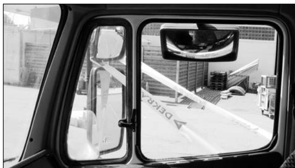
Bild 81: Innenraumaufnahme zur Darstellung des indirekten Sichtfeldes aus Fahrersicht (Mercedes Benz 1748) über den Weitwinkelspiegel, die Markierungsbänder kennzeichnen die Untergrenze der Abbildung im Spiegel
