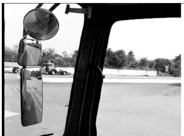
Bild 105: Darstellung der Fahrersicht des Mercedes Benz MIM-Fahrzeugs bei erstem Auftauchen des Radfahrers im direkten Sichtfeld des Fahrers des Mercedes Benz 1748, s = 5,9 m vor Anstoß, Abstand Fahrrad Lkw a = 2,5 m, Versuch 8
