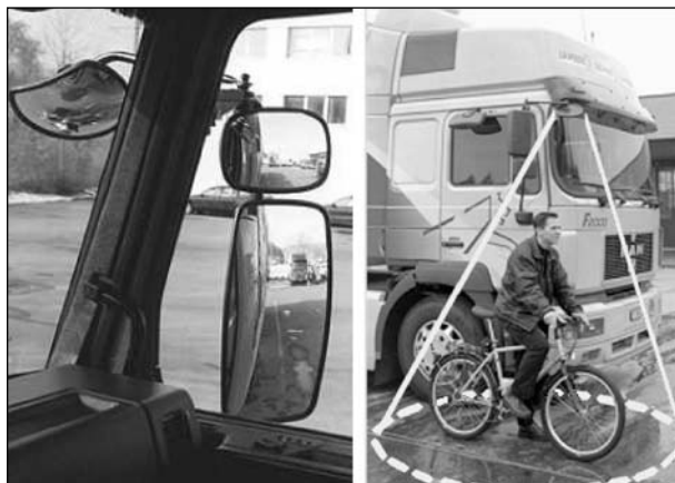
Bild 18: Anbau und Sichtfeld TOWISPICK ® -Spiegel [23]
