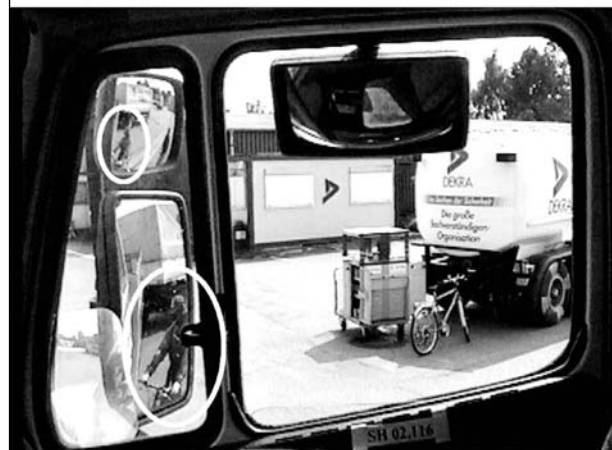
Bild 101: Darstellung der Fahrersicht des Mercedes Benz 1748 auf den Radfahrer für die Situation des Seitenanstoßes, s = 16,5 m vor Anstoß (Bild oben), Anstoßsituation (Bild unten), Versuch 7
