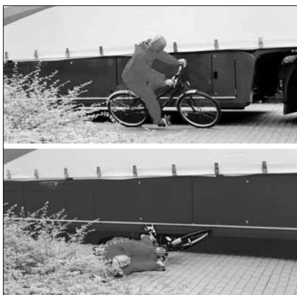
Bild 15: Simulierte seitliche Kollisionsposition zwischen Fahrrad und Nutzfahrzeug mit tief heruntergezogenem Seitenschutz (Safeliner von Krone [16])
