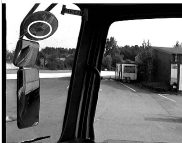
Bild 104: Darstellung der Fahrersicht des Mercedes Benz MIM-Fahrzeuges auf den Radfahrer für die Situation des Eckanstoßes, s = 18,5 m vor Anstoß, Abstand Fahrrad Lkw a = 1,6 m (Bild oben), Anstoßsituation (Bild unten), Versuch 8
