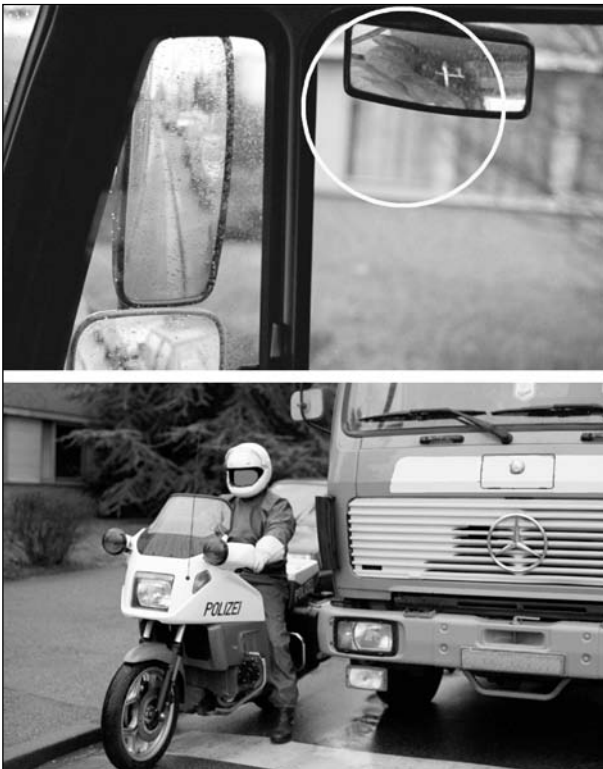
Bild 63: Stehendes Motorrad vor der rechten vorderen Ecke eines Lkw, Bekleidung im Rampenspiegel eventuell erkennbar (oben), Originalverhältnisse (unten)
