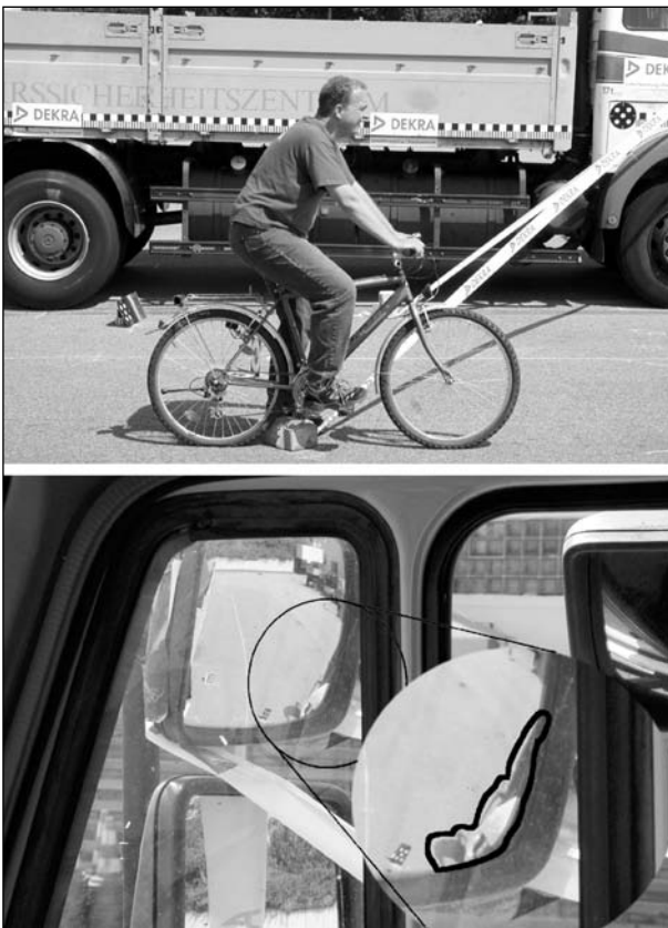
Bild 89: Erkennbarkeit des Objektes am Rand des Spiegels, Radfahrer befindet sich genau über der vorderen Begrenzung des indirekten Sichtfeldes (4,2 m rechts neben dem Lkw bzw. 2,8 m hinter Mitte Vorderachse)
