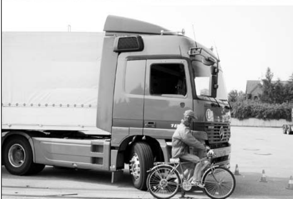
Bild 99: Nachgestellte Anstoßsituation der dynamischen Versuche für Mercedes Benz 1748 (Versuch 6, oben) und Mercedes Benz Actros (Versuch 8, unten) (entsprechend Bild 90)
