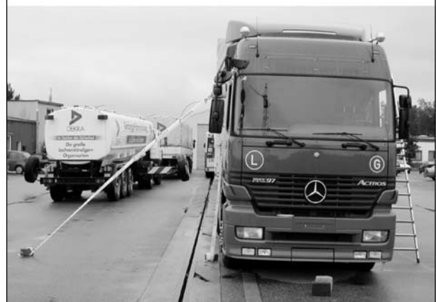
Bild 80: Aufnahme zur Darstellung des indirekten Sichtfeldes aus Fahrersicht (Mercedes Benz MIM-Fahrzeug) über den Weitwinkelspiegel, die Markierungsbänder kennzeichnen die Untergrenze der Abbildung im Spiegel und die Eckpunkte des realen Sichtfeldes am Boden
