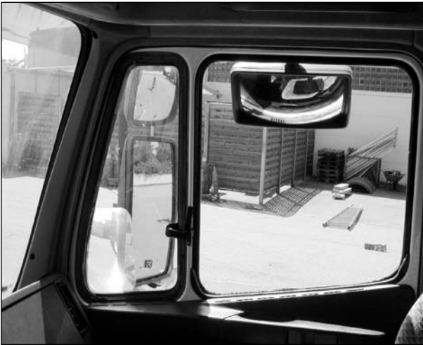
Bild 77: Innenraumaufnahme zur Darstellung des indirekten Sichtfeldes aus Fahrersicht (Mercedes Benz 1748) über den Hauptaußenspiegel
