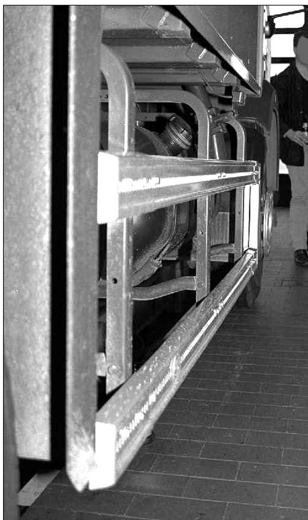
Bild 8: Typischer europäischer seitlicher Unterfahrerschutz in offener Ausführung [49]
