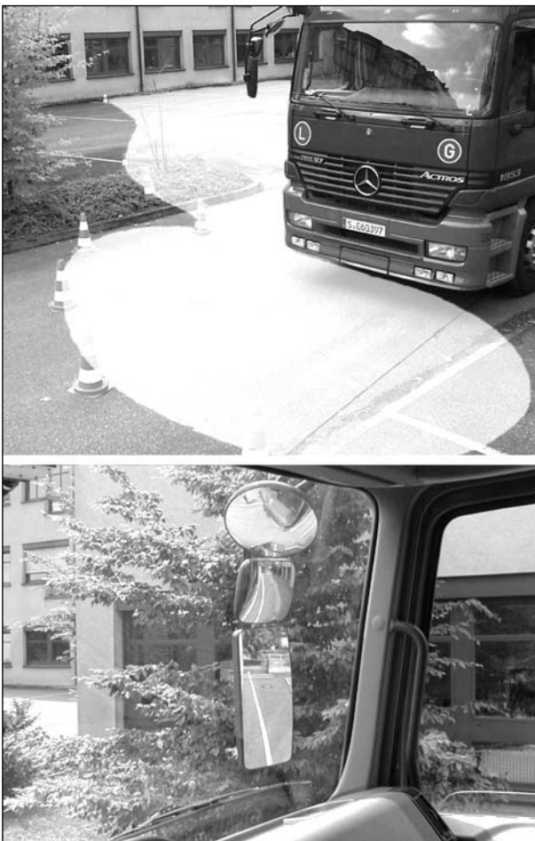
Bild 16: Sichtfeld über die Flügelspiegel im MIM-Fahrzeug von DaimlerChrysler [9]
