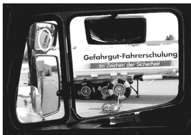
Bild 100: Nachgestellte Anstoßsituation der dynamischen Versuche für Mercedes Benz 1748 (Versuch 7, entsprechend Bild 94)
