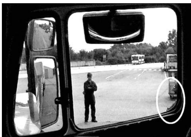
Bild 103: Darstellung der Fahrersicht des Mercedes Benz 1748 bei erstem Auftauchen des Radfahrers im Blickfeld des Fahrers des Mercedes Benz 1748, s = 5,9 m vor Anstoß, Abstand Fahrrad Lkw a = 2,5 m, Versuch 6
