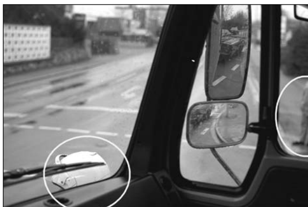
Bild 60: Sichtfeldverbesserung durch eine in das seitliche Zusatzfenster eingelassene Fresnellinse [60]
