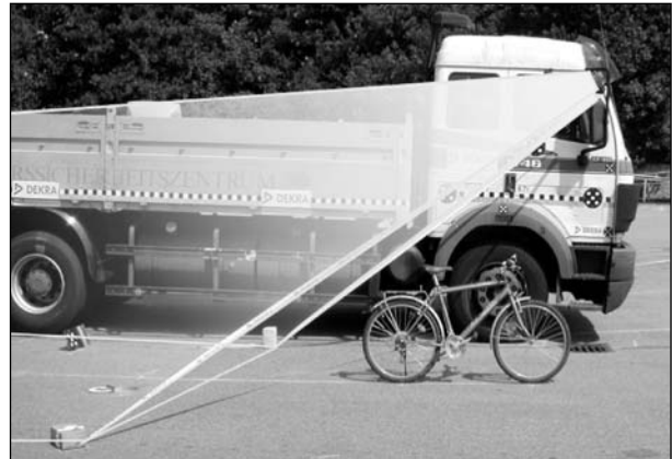
Bild 79: Aufnahme zur Darstellung des indirekten Sichtfeldes aus Fahrersicht (Mercedes Benz 1748) über den Weitwinkelspiegel (der eingblendete Pyramidenstumpf kennzeichnet den Abbildungsbereich des Weitwinkelspiegels, das Fahrrad steht 2,0 m neben dem Lkw)
