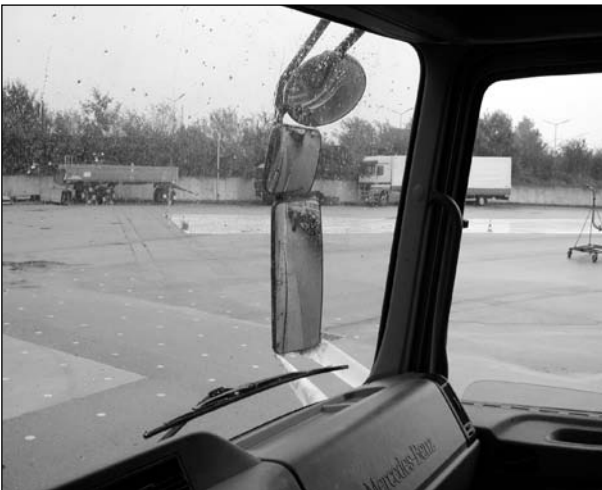
Bild 78: Innenraumaufnahme zur Darstellung des indirekten Sichtfeldes aus Fahrersicht (Mercedes Benz MIM-Fahrzeug) über den Hauptaußenspiegel
