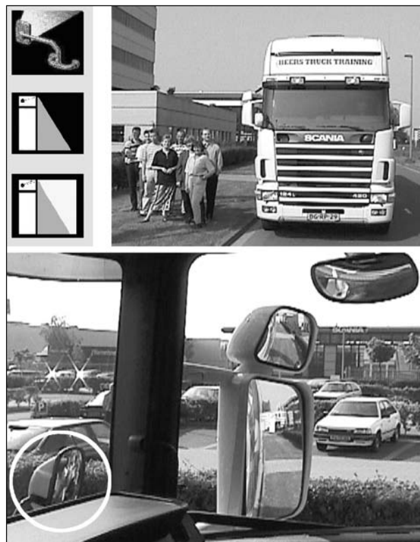
Bild 17: Vergleich Sichtfeld Standard zu Dobl ® -Spiegel, vorgeschriebener Standardspiegel (dunkles Dreieck im Piktogramm), Sichtfeld im Dobl ® -Spiegel (helles Dreieck) dargestellt [46]
