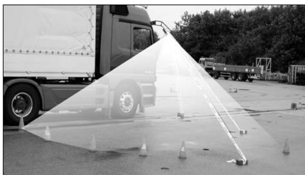
Bild 84: Darstellung des aus dem Frontspiegel resultierenden Sichtkegels (Mercedes Benz MIM-Fahrzeug)
