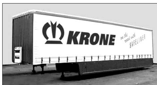
Bild 11: Integrierter Seitenschutz in geschlossener Ausführung (Safeliner von Krone [15])
