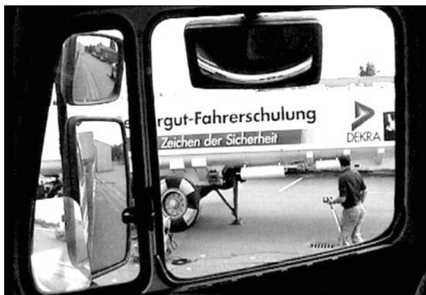
Bild 102: Darstellung der Fahrersicht des Mercedes Benz 1748 auf den (nicht sichtbaren) Radfahrer für die Situation des Eckanstoßes, s = 17,1 m vor Anstoß, Abstand Fahrrad Lkw a = 3,15 m, Versuch 6
