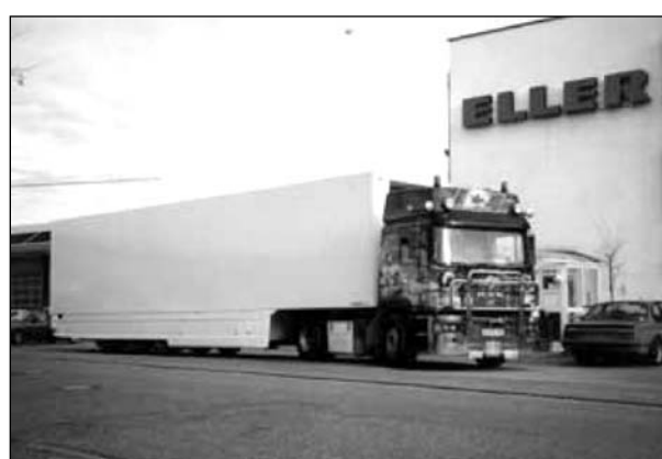
Bild 10: Seitenschutz in geschlossener Ausführung (Eller)
