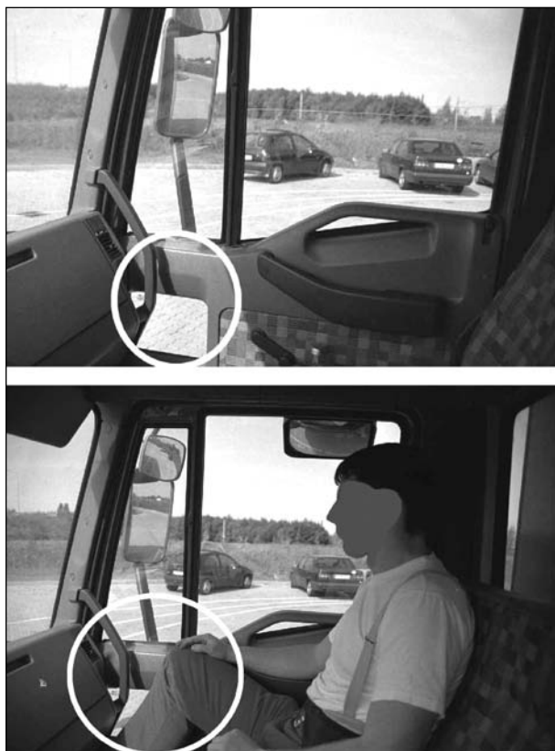
Bild 59: Sichtfeldverbesserung durch zusätzliches Seitenfenster und Sichteinschränkung durch Mitfahrer im Lkw
