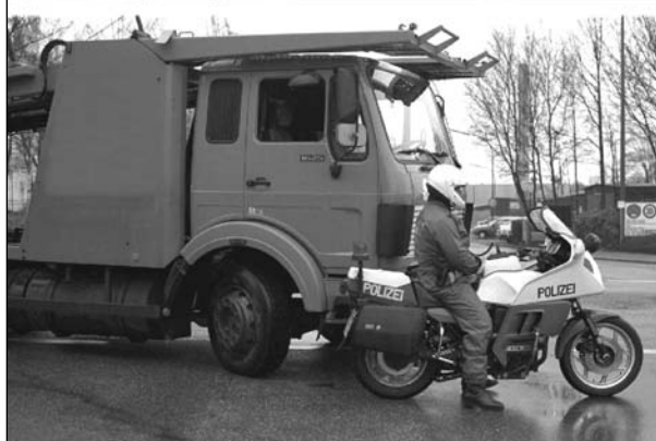
Bild 61: Nachgestellte Kollisionssituation, Helm gerade sichtbar (oben), Originalverhältnisse (unten)
