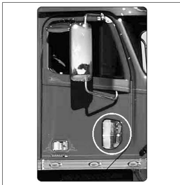
Bild 60: Sichtfeldverbesserung durch eine in das seitliche Zusatzfenster eingelassene Fresnellinse [60]
