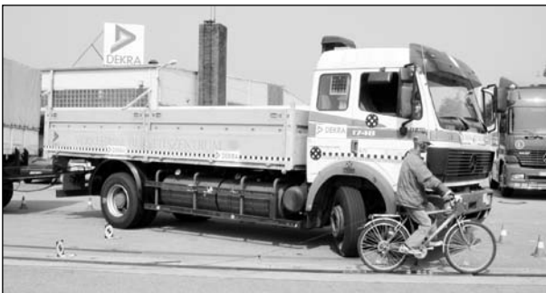
Bild 98: Ausgangssituation der dynamischen Sichtversuche für Mercedes Benz 1748 (oben) und Mercedes Benz Actros (unten)
