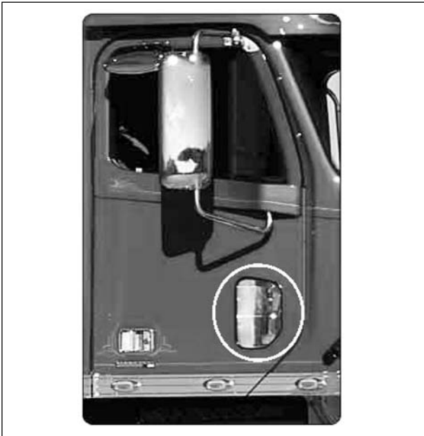
Bild 120: Seitentür rechts mit in Zusatzfenster integrierter Fresnellinse, Quelle: Freightliner (siehe auch Kapitel 5.2, Bild 60)
