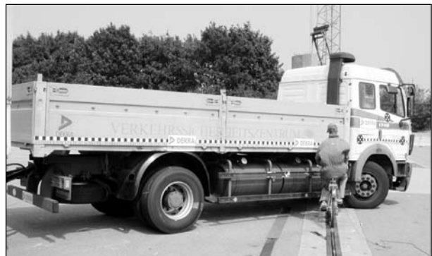
Bild 100: Nachgestellte Anstoßsituation der dynamischen Versuche für Mercedes Benz 1748 (Versuch 7, entsprechend Bild 94)
