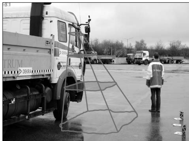
Bild 107: Räumlicher Sichtbereich (Pyramidenstumpf) am Beispiel des Rampenspiegels
