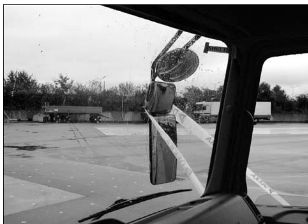
Bild 82: Innenraumaufnahme zur Darstellung des indirekten Sichtfeldes aus Fahrersicht (Mercedes Benz MIM-Fahrzeug) über den Weitwinkelspiegel, die Markierungsbänder kennzeichnen die Untergrenze der Abbildung im Spiegel
