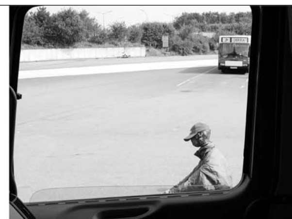
Bild 105: Darstellung der Fahrersicht des Mercedes Benz MIM-Fahrzeugs bei erstem Auftauchen des Radfahrers im direkten Sichtfeld des Fahrers des Mercedes Benz 1748, s = 5,9 m vor Anstoß, Abstand Fahrrad Lkw a = 2,5 m, Versuch 8
