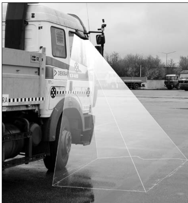
Bild 83: Darstellung der aus dem Rampenspiegel resultierenden Sichtpyramide, die vom Spiegel zum Boden verlaufenden Linien markieren die über die Spiegelecken entstehenden Begrenzungen (Mercedes Benz 1748)
