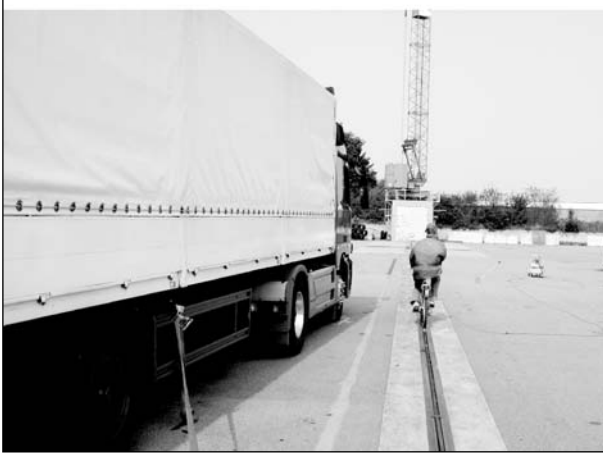
Bild 98: Ausgangssituation der dynamischen Sichtversuche für Mercedes Benz 1748 (oben) und Mercedes Benz Actros (unten)
