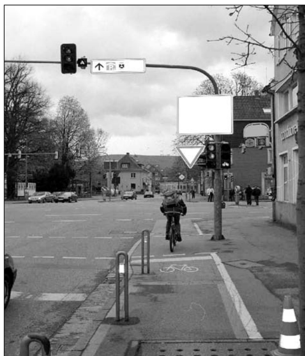
Bild 126: Knotenpunkt mit Versatz der Haltelinien und Vorlaufzeit der Ampelschaltung für Radfahrer (siehe auch Kapitel 9.2, Bild 113)
