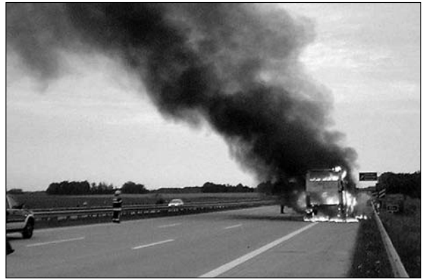
Bild 2.16: Selbstständiges Nachlassen der Branderscheinung mangels zur Verfügung stehender Brandlast, Rückgang bei der Rauchentwicklung
