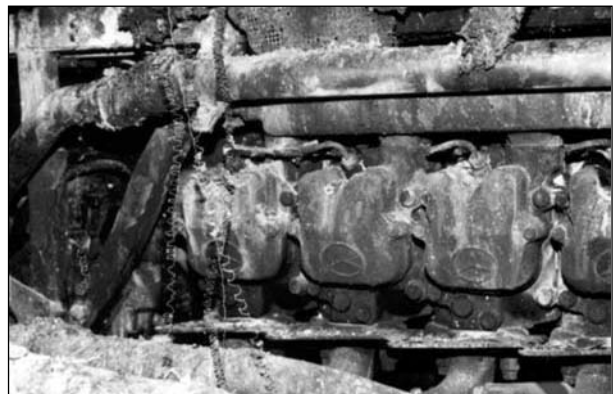
Bild 2.6: Motorraum nach Brandeinwirkung
