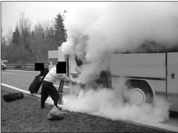
Bild 2.25: Löschmitteleintrag von der Seite in den Motorraum, Räumung des Gepäckfachs, Zeit: 00:03
