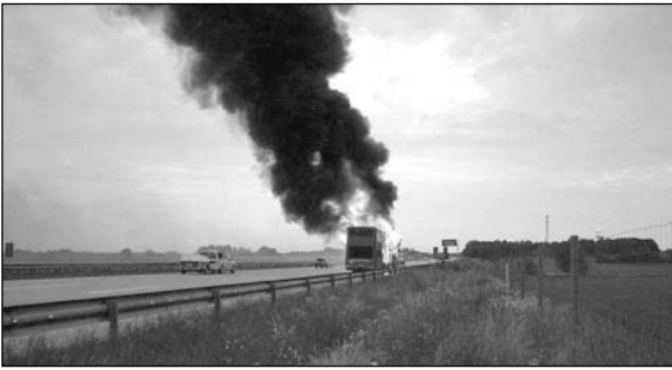
Bild 2.12: Vollbrandphase mit verstärkter Rauchbildung, Flammenbildung in der Rauchwolke als Zeichen großer Mengen unverbrannter Pyrolysegase bei gleichzeitig großer Hitze
