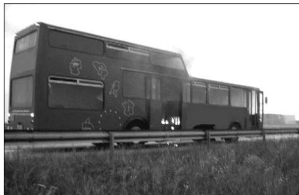
Bild 2.9: Brand des kompletten Treppenbereichs der hinteren Türe, brennendes Abtropfen von Kunststoffen auf die Fahrbahn, stark eingeschränkte Sicht in Bodennähe
