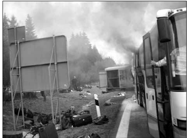
Bild 2.27: Rauchentwicklung im Innenraum, Rauchaustritt aus zwischenzeitlich geöffnete hinterer Betriebstüre, Zeit: 00:08
