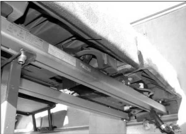
Bild 12.14: Unterseite des beflamten Sitzes
