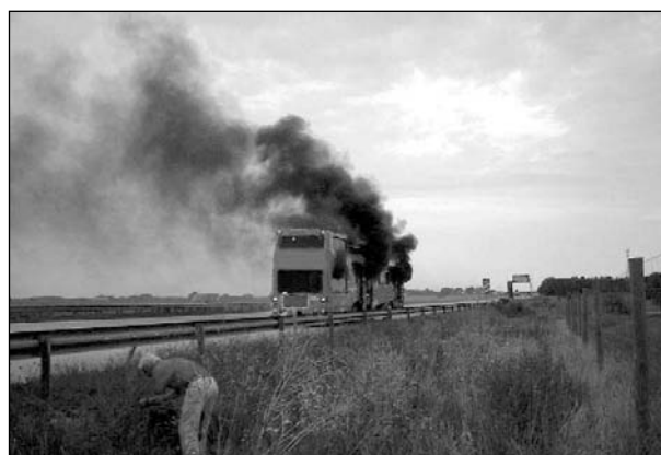
Bild 2.10: Thermische Aufbereitung der Innenraumkomponenten mit Bildung stark rußhaltigen Rauchs, vollständige Verrauchung des Innenraums, auch in Bodennähe keine Sicht
