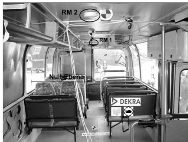
Bild 12.5: Null-Ebene und Rauchmelderanordnung
