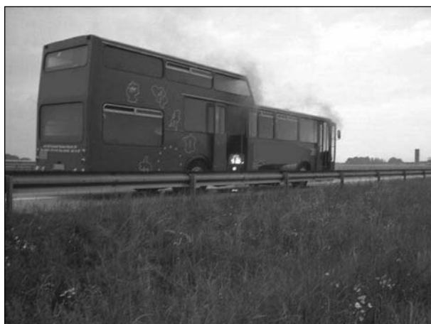
Bild 2.8: Nach Brandentstehung im Motorraum Branddurchbruch im Bereich des hinteren Ausgangs, erste Flammerscheinungen, komplette Verrauchung des Innenraums beider Geschosse mit hellem Rauch, Sicht in Bodennähe zur Flucht vorhanden
