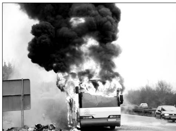
Bild 2.33: Durchbrand der Windschutzscheibe, Erlöschen der Scheinwerfer des Busses, Zeit: 00:13
