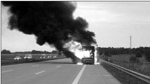
Bild 2.13: Durchbruch der Heckscheibe im Untergeschoss, weitere Verstärkung der Rauchentwicklung, Brandübergriff auf die Reifen
