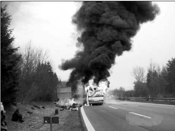
Bild 2.35: Flashover im Bereich der Gepäckstücke, Zündung ohne direkte Beflammung, Zeit: 00:15
