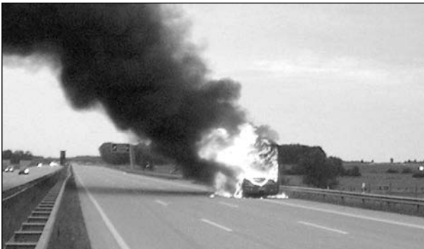
Bild 2.14: Durchbruch der Heckscheibe im Obergeschoss
