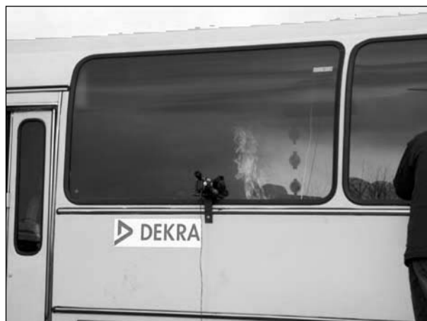
Bild 12.20: Deutliche Rauchsichtenbildung im Bus
