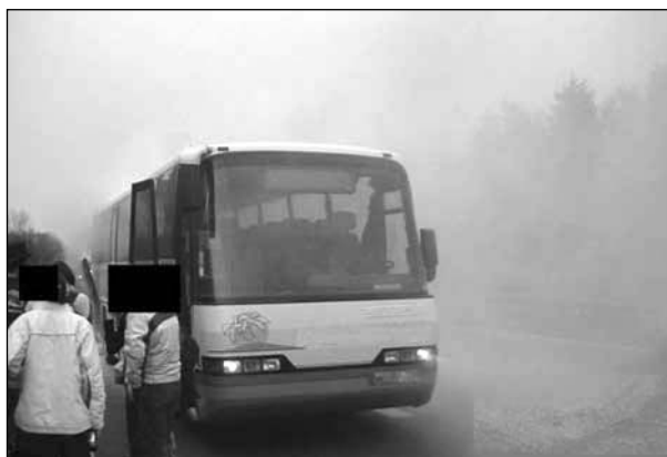
Bild 2.23: Kurzzeitige Bildung von hellem Rauch-Löschpulvergemisch, Zeit: 00:02
