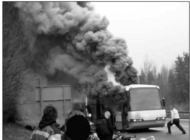
Bild 2.28: Brandeintritt in den Innenraum, Flashover im hinteren Busbereich, starke Rauchentwicklung im Frontbereich, Zeit: 00:10
