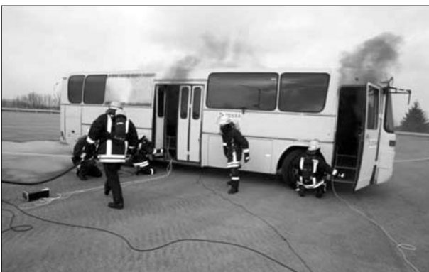
Bild 12.23: Leichter Rauchaustritt nach Öffnen der Türen in der 530. Sekunde
