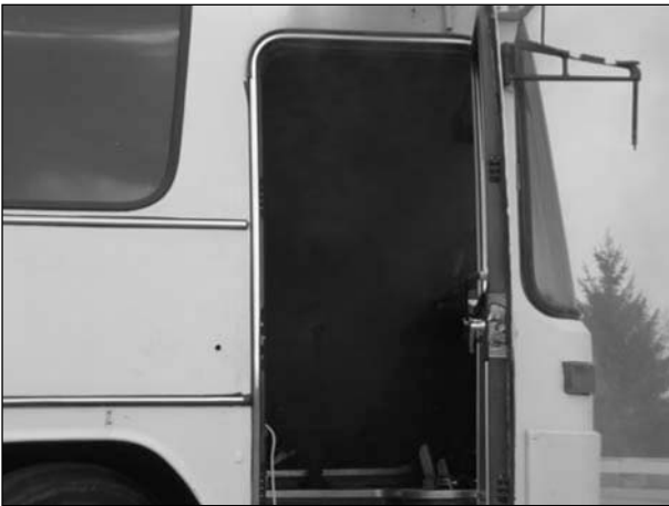
Bild 12.21: Komplette Verrauchung im Bereich der Fronttüre
