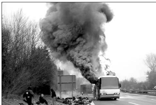
Bild 2.30: Durchzündung des Busses, thermische Aufbereitung der neben dem Bus gelagerten Gepäckstücke mit sichtbarer Bildung von Pyrolysegasen, Zeit: 00:11
