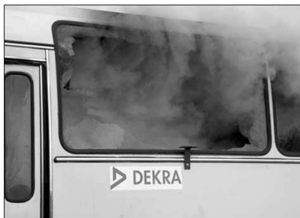
Bild 12.28: Durch Flashover zerstörte Seitenscheibe
