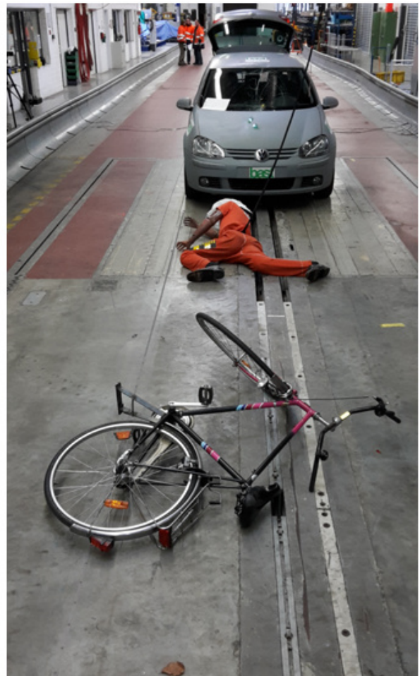
Abbildung 11: Endlagen nach den Vollfahrzeugversuchen mit 40 km/h (links) und 20 km/h (rechts)
