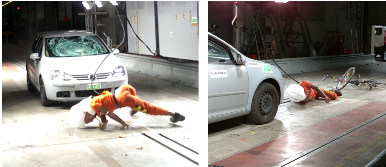
Abbildung 10: Sekundäraufprall auf der Fahrbahn (Standbilder aus Hochgeschwindigkeitsfilmen)
