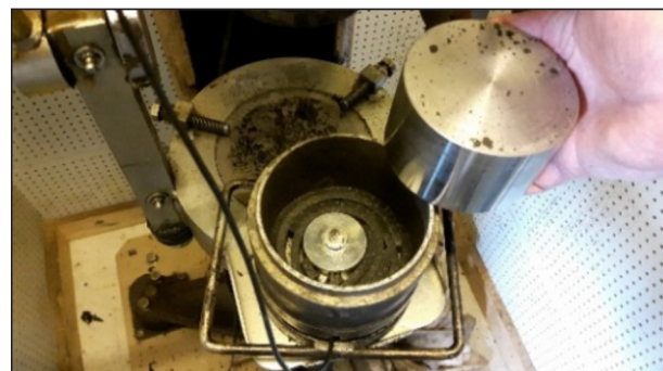
Bild 10: Kraftmessdose zur Bestimmung der aufgebrauchten Aufprallkraft
