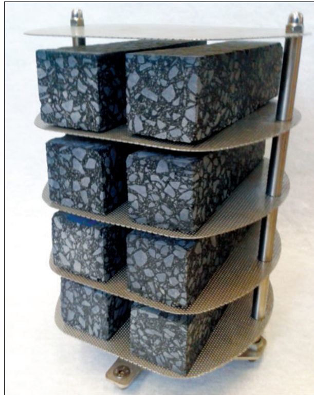
Bild 19: Gestell mit Asphalt-Probekörpern für die Konditionierung im Druckalterungsbehälter
