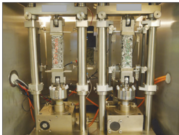
Bild 11: Prüfvorrichtung mit eingebauten Probekörpern für Zug- bzw. Abkühlversuche
