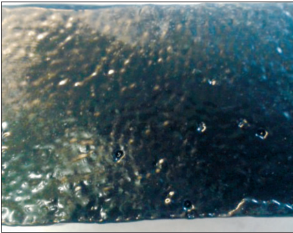
Bild 37: Probekörperoberfläche vor Beanspruchung durch PAV-A-Konditionierung
