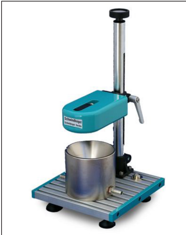
Bild 3-1: Schwindkegel von Schleibinger [54]
