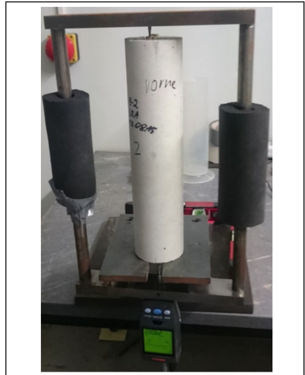
Bild 3-2: Messrahmen zur Bestimmung der Längenänderung infolge Trocknungsschwinden
