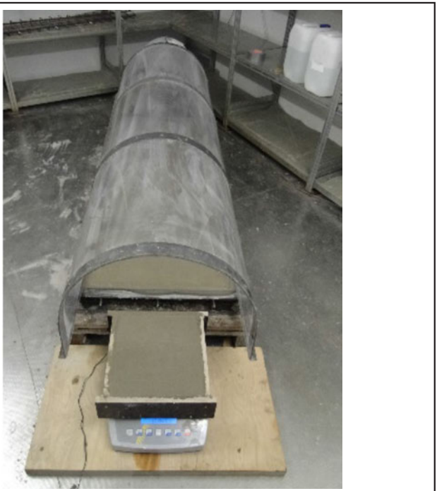
Bild 3-3: Untersuchung der Schrupfrissneigung (links: Schwindrahmen, rechts: betonierte Platte im Windkanal)
