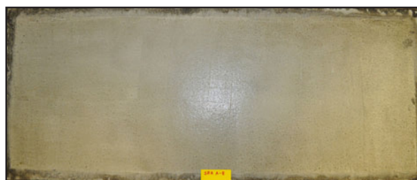
Bild 4–19: Behinderte Fröhschwindplatte mit Beton A-8 (mit SAP) – keine Risse festzustellen
