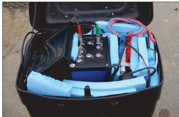
Bild 25: Kreiselsystem im Motorradkoffer
