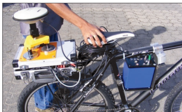
Bild 26: Ansicht des Kreiselsystems und des Messkoffers mit GPS-Antenne
