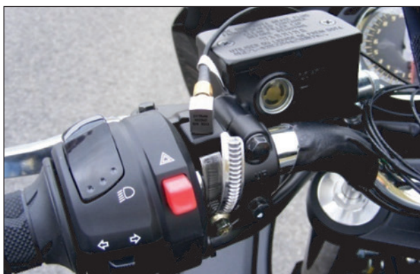
Bild 24: Triaxialer Schwingungsaufnehmer am Motorrad
