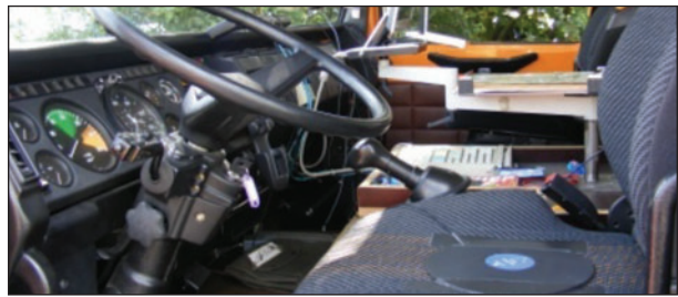
Bild 4: Sitzkissen mit Triaxialsensor
