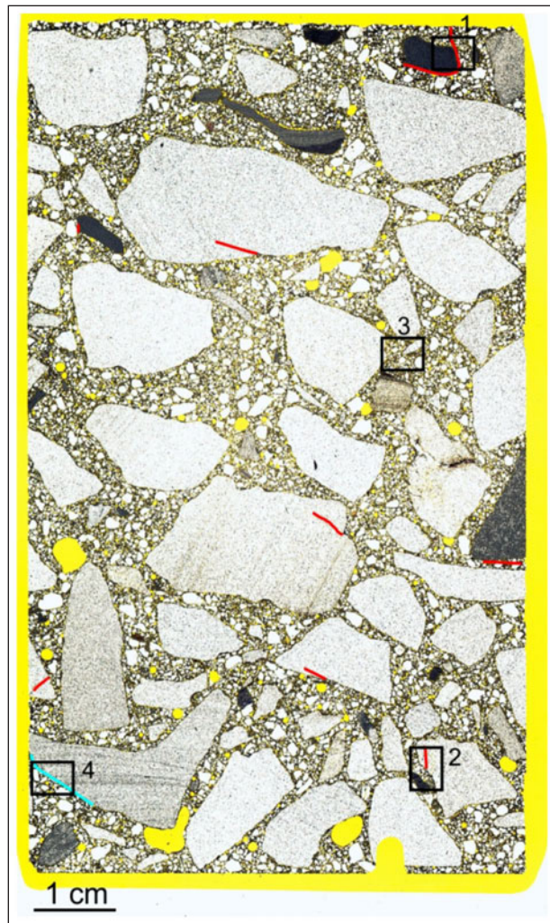
Bild 51: Übersicht Dünnschliff des Grauwacke-Unterbetons mit CEM I 42,5 N ohne Flugasche nach 12 Zyklen in der FIB-KWL – Beaufschlagung mit Wasser
