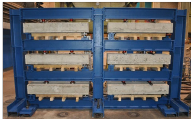
Bild 26: Mehrfach-Prüfstand für zyklische Beanspruchung von Großbalken
