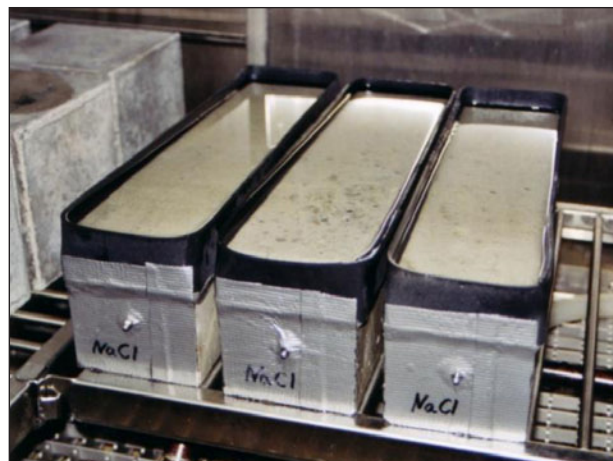
Bild 22: Probekörper für die AKR-Performance-Prüfung
