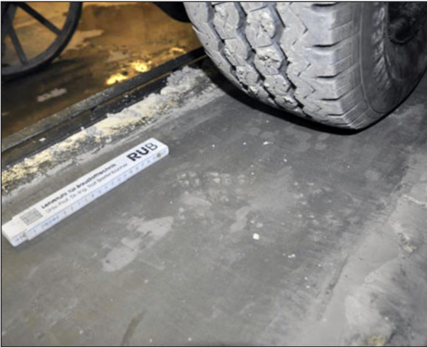
Bild 135: Mech. Erstbelastung: Rollender Reifen bei Verbundkörper B1 (nach der 1. Überrollung)
