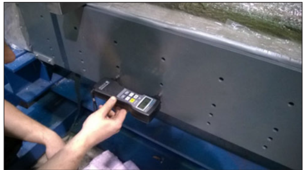
Bild 30: Ultraschalllaufzeitmessungen (Serie 2) in Höhe der Fuge an der Seitenfläche eines Verbundkörpers
