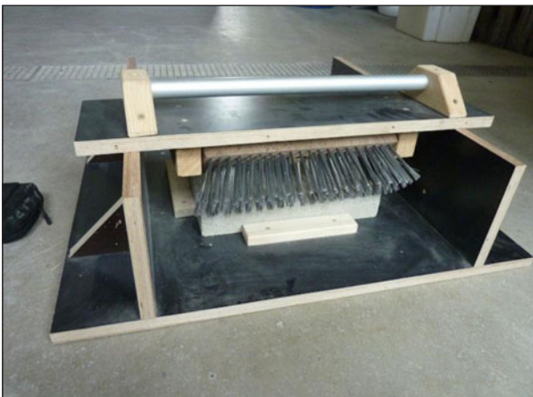
Bild 19: Ausbürstvorrichtung für Waschbetonplatten [72]
