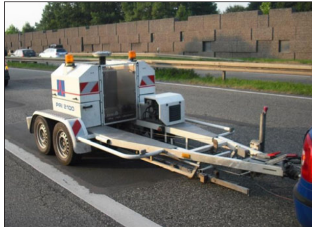
Bild 38: Heavy Weight Deflectometer
