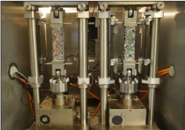
Bild 25: Prüfvorrichtung mit eingebaute Probekörpern für Abkühl- bzw. Zugversuche
