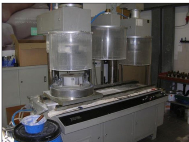
Bild 30: Prüfgerät für das Verfahren Wehner/Schulze (Polierstation und Griffigkeitsmessstation)
