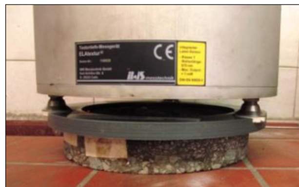
Bild 37: Detail ELAtextur®, Messvorgang
