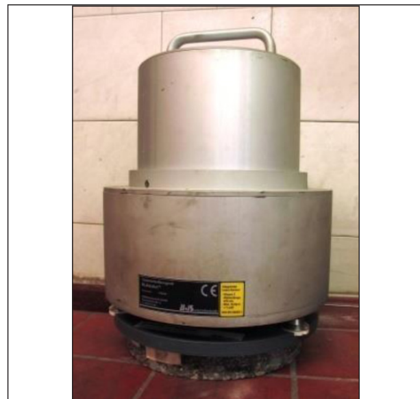
Bild 36: Modifiziertes ELAtextur® Messgerät
