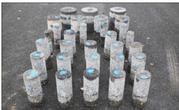
Bild 6: Bohrkern einer Untersuchungsstrecke
