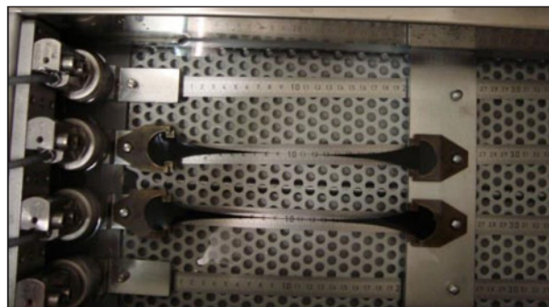
Bild 17: Bindemittelproben im temperierten Duktilitätsbad
