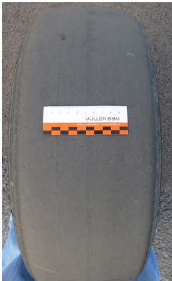
Bild 5.3-11: Messreifen für die Kontrollierten Vorbeifahrtmessungen
