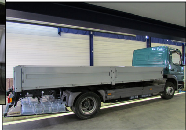
Bild 4.4-34: Aufbau des Fahrzeugs mit absorbierender Unterbodenverkleidung und aufgesetzten Kunststoffresonatoren (20 L oben und 5 L unten)
