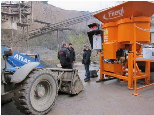
Bild 5.5-58: Aufbau der mobilen Mischanlage (links) und Einrichtung des Baustellenlabors (rechts)
