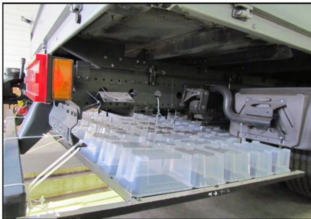
Bild 4.4-34: Aufbau des Fahrzeugs mit absorbierender Unterbodenverkleidung und aufgesetzten Kunststoffresonatoren (20 L oben und 5 L unten)
