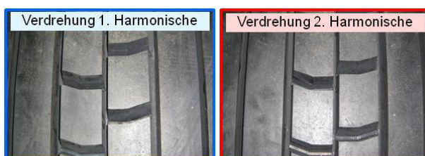
Bild 4.2-30: Reifen mit zwei Profilsuren und unterschiedlicher Verdrehung
