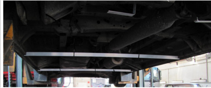
Bild 4.4-94: Anbau des absorbierenden Unterbodens an das Fahrzeug
