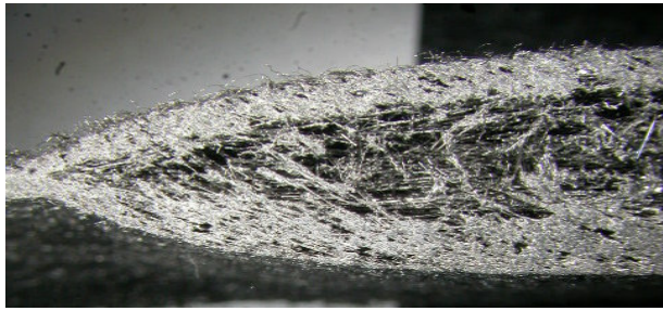
Bild 4.4-2: Materialaufbau (Polypropylen-Glasfaser) einer Fahrzeugunterbodenverkleidung
