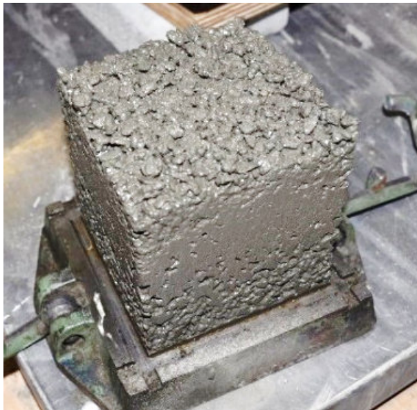
Bild 5.5-24: Unmittelbar nach Verdichtung entformter COPS - Mischung V4/1
