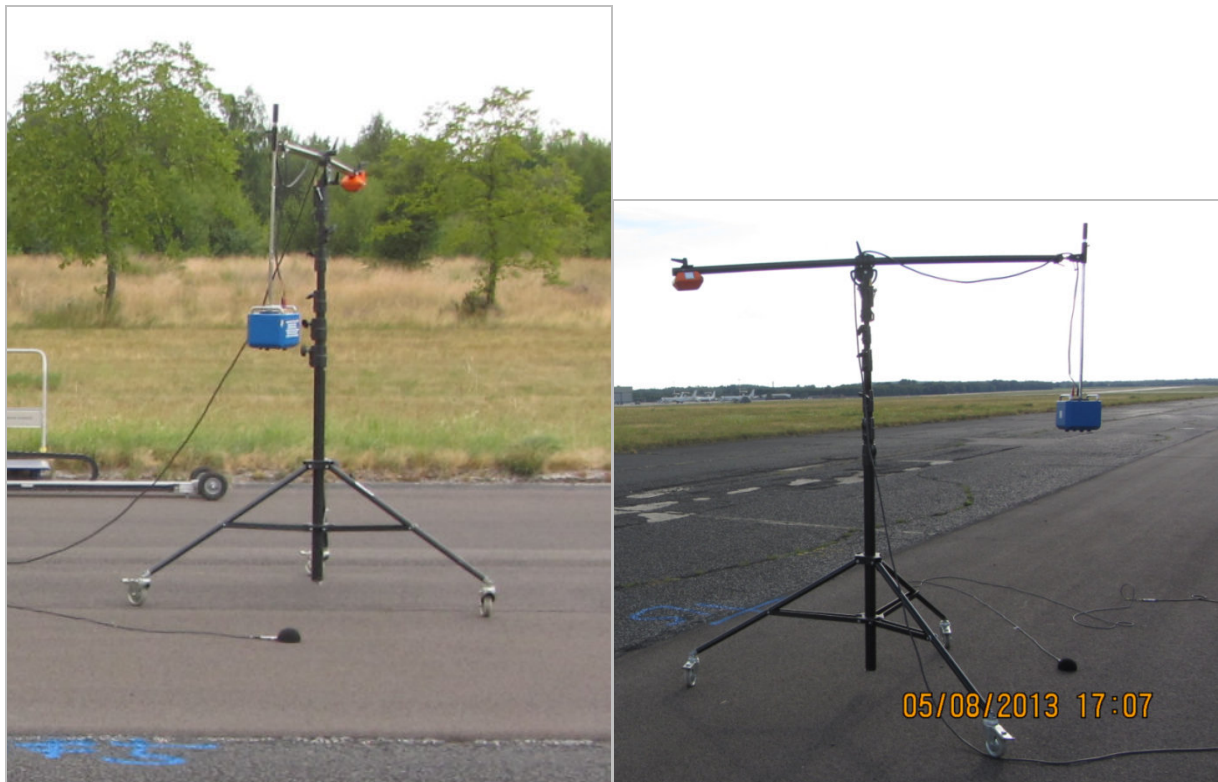
Bild 5.3-3: Praktischer Messaufbau für die Messung des Schallabsorptionsgrads in situ an Testfeld MF5 auf dem Versuchsgelände Geilenkirchen.
