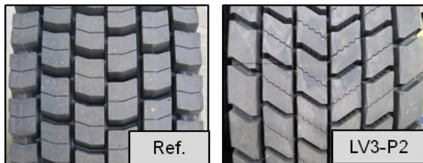
Bild 4.2-48: Serienprofil (links) und Konzeptprofil „LV3-P2“ (rechts) im Vergleich
