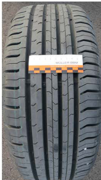
Bild 5.3-11: Messreifen für die Kontrollierten Vorbeifahrtmessungen
