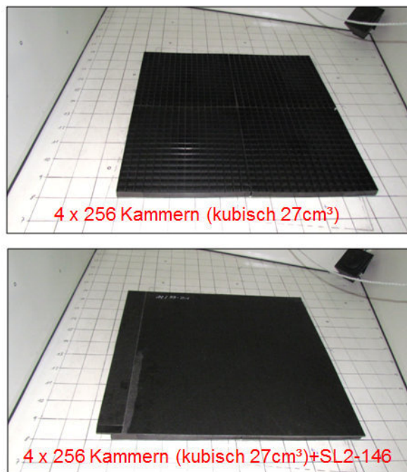
Bild 4.4-44: Resonatorstegplatten abgedeckt mit absorbierendem LWRT in der Alpha-Kabine
