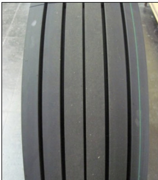
Bild 4.2-13: Basisreifen 315/80 R22.5 mit fünf Umfangsrillen
