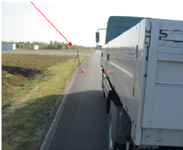
Bild 4.4-52: Anordnung der Lichtschranken im Abstand von 30 m vor der Messpunktlinie
