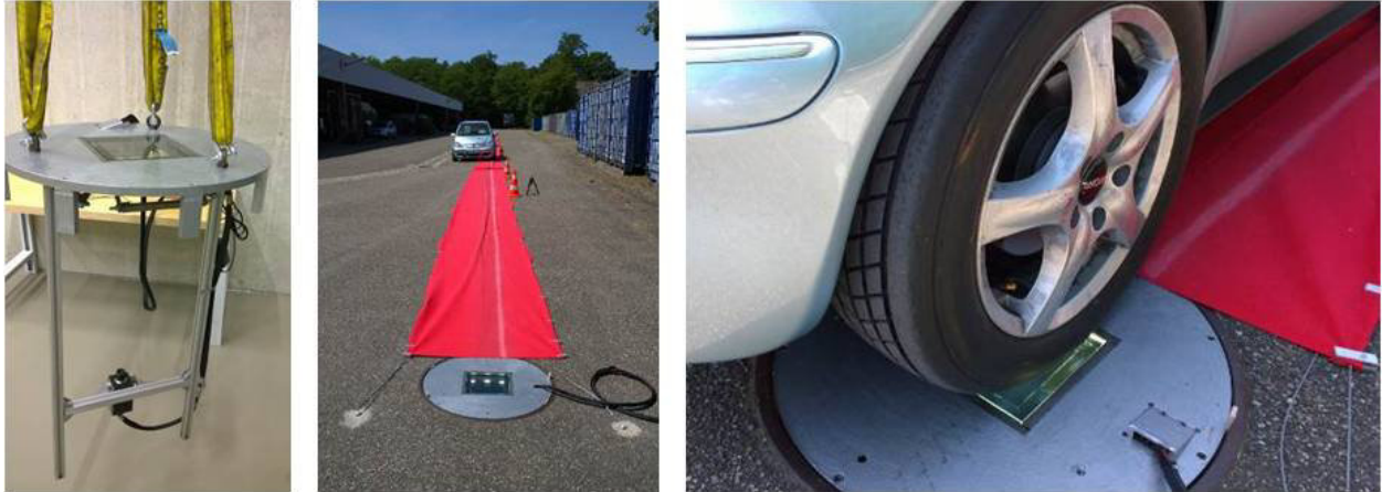
Bild 4.3-18: Unterflurlabor vor dem Einsetzen in einen genormten Abwasserschacht, Anfahrteppich mit eingesetztem Unterflurlabor, Überfahrt mit Elektrofahrzeug
