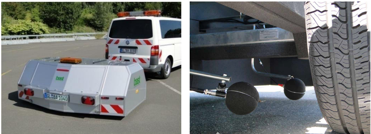
Bild 5.3-12: CPX-Messanhänger der BAST (links), Messrad und Mikrophone (rechts)
