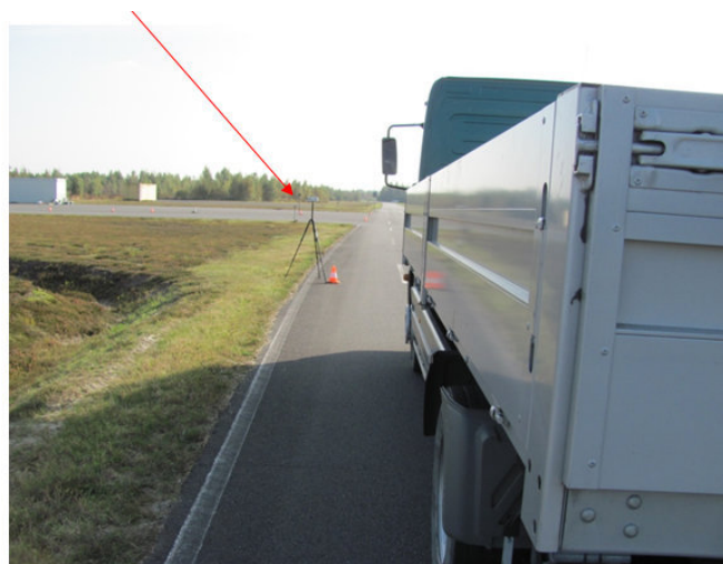
Bild 4.4-21: Anordnung der Lichtschranke
