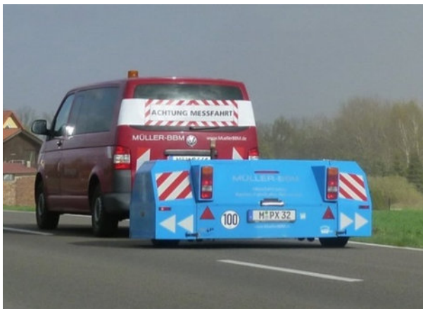
Bild 5.2-40: CPX-Messung. Links: geschlossener Messanhänger nach ISO/DIS 11819-2; rechts: Anordnung der Mikrofone in Relation zum Messreifen.
