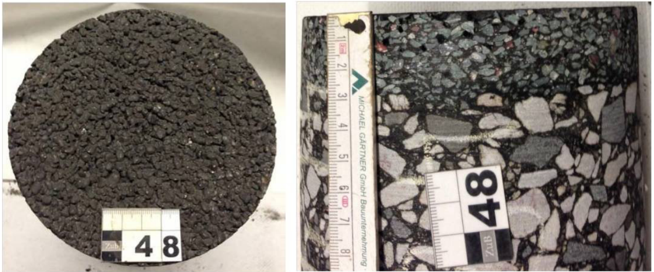
Bild 5.3-67: Beschaffenheit der Asphaltdeckschicht PMA 5 des Bohrkerns BK8 (im Bild 48) bei einem Hohlraumgehalt von 8,4 Vol.-%
