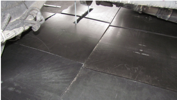
Bild 4.4-49: Absorbierende Unterbodenplatte, abgedeckt mit den Kammerplatten im mittleren Fahrzeugbereich
