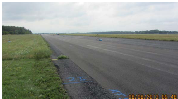
Bild 5.3-9: Aufbau für die Messung der Kontrollierten Vorbeifahrt mit drei Messreifensätzen. Links: Blick von West nach Ost mit Aufstellung der beiden Mikrofone an Testfeld 5, rechts: Blick in Querrichtung mit dem nördlichen Mikrofon in der angrenzenden Wiesenfläche und dem südlichen Mikrofon auf der Asphaltfläche.
