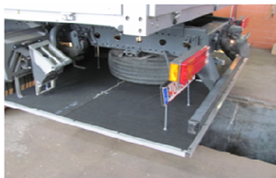
Bild 4.4-12: Aufbau eines absorbierenden Unterbodens auf Basis von LWRT-Sandwichplatten
