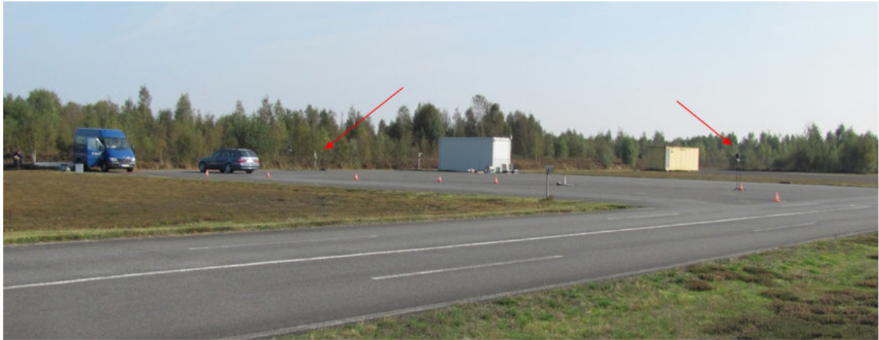
Bild 4.4-51: Anordnung der Messmikrofone, Kunstköpfe (rote Pfeile) bei der konstanten Vorbeifahrtmessung: 10 m und 40 m zur Streckenmitte auf 1,65 m Höhe
