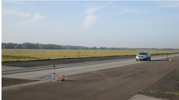
Bild 3.2-51: Aufstellung der Messgeräte zur Messung der Kontrollierten Vorbeifahrt
