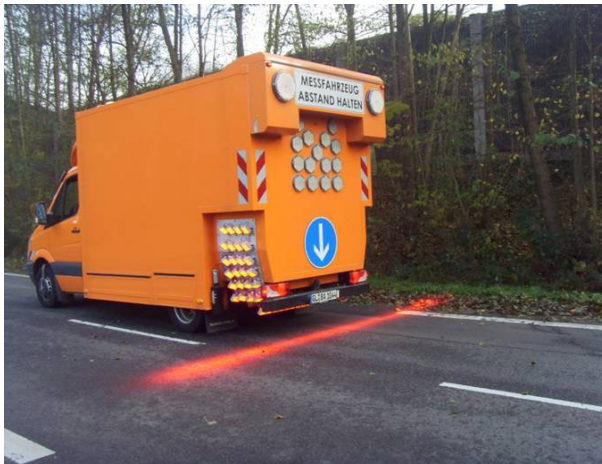
Bild 5.3-15: MEFA - Multifunktionales Erfassungssystem zur Fahrbahnoberflächenanalyse MEFA (links) Laserscanner hinter der am Kofferaufbau befindlichen Heckabdeckung (rechts)
