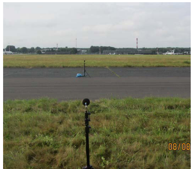
Bild 5.3-9: Aufbau für die Messung der Kontrollierten Vorbeifahrt mit drei Messreifensätzen. Links: Blick von West nach Ost mit Aufstellung der beiden Mikrofone an Testfeld 5, rechts: Blick in Querrichtung mit dem nördlichen Mikrofon in der angrenzenden Wiesenfläche und dem südlichen Mikrofon auf der Asphaltfläche.
