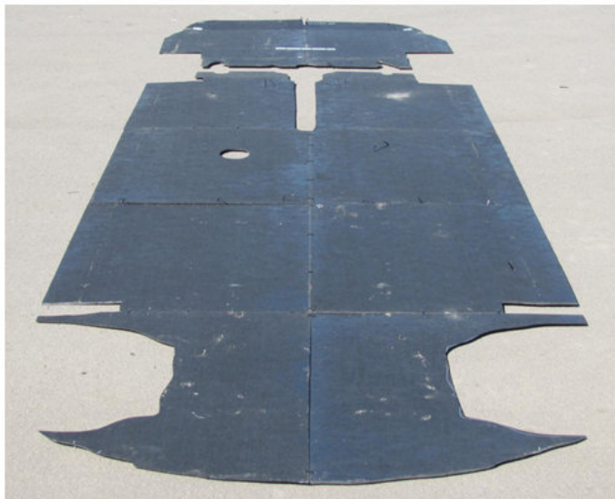
Bild 4.4-93: Prototyp des absorbierenden Unterbodens
