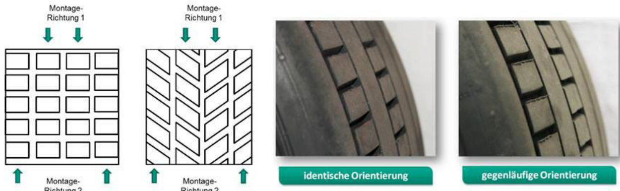
Bild 4.3-9: Montagerichtungen am R4
