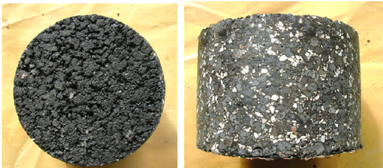
Bild 5.2-18: Beispiel der aus Erstprüfungen gewonnen Asphaltprobekörper – SMA 5 S (2/5 Material) (Quelle: TU München)
