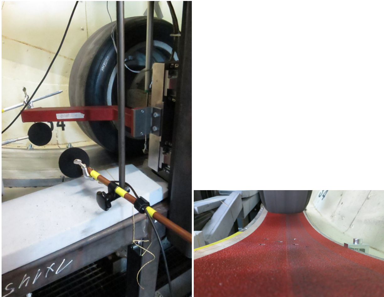
Bild 3.2-59: Fahrbahn im Innentrommelprüfstand. Links: Versuchsfahrt mit Glattreifen auf gelochter Aluminiumfahrbahn, rechts: Glattreifen und texturierte Fahrbahn mit fünf Bohrungen.
