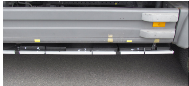
Bild 4.4-49: Absorbierende Unterbodenplatte, abgedeckt mit den Kammerplatten im mittleren Fahrzeugbereich
