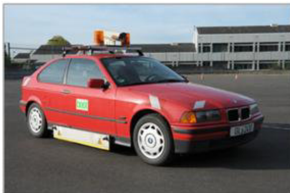
Bild 5.3-13: Textur-Laserprofilometer TMF der BASt (links), Auswerteprotokoll (rechts)
