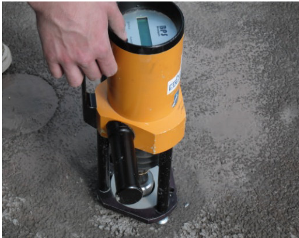
Bild 5.5-62: Ermittlung der Haftzugfestigkeit an der Teststrecke
