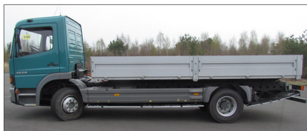
Bild 4.4-47: Klein-Lkw Daimler ATEGO mit absorbierender Unterbodenplatte und fahrzeugseitig aufgelegten Kammerplatten (Kammeröffnungen der absorbierenden Platte zugewandt)
