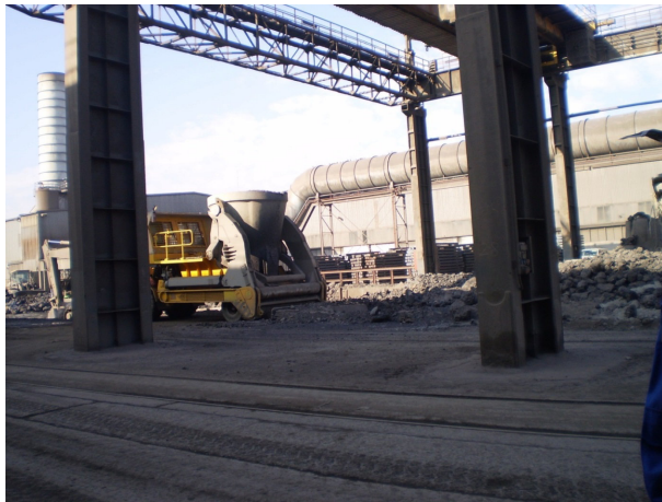
Bild 5.2-3: Langsame Erstarrung der Elektroofenschlacke im Schlackenkübel (Quelle: Max Aicher Umwelt)
