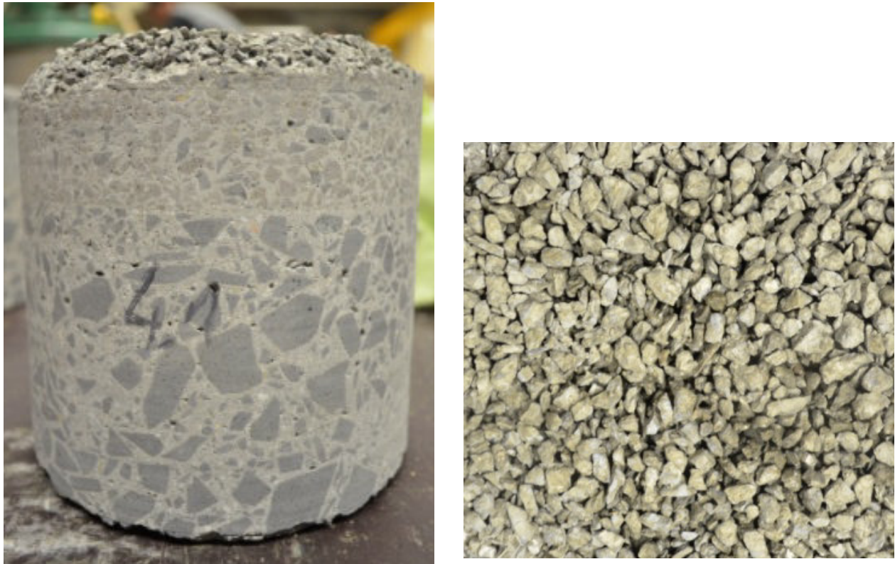
Bild 5.5-30: COPS-Testplatte: Methode: „Selbstständiges Absinken des Leimes“
