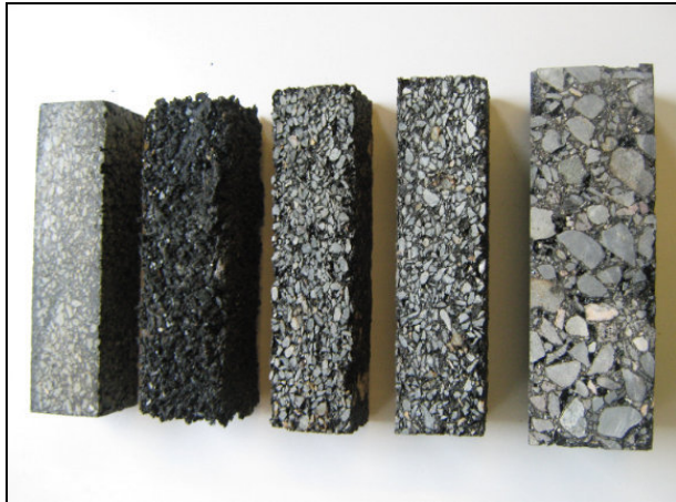
Bild 5.4-35: Prüfkörper SMA 5 S, Sonderasphalt 26 % GG, Sonderasphalt IA 5 - dicht, Sonderasphalt IA 5 - offen, AC 16 B S (von links)
