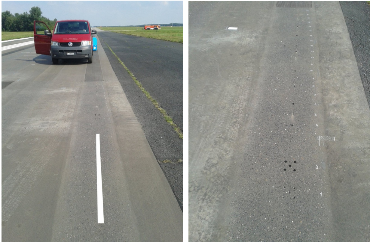
Bild 3.2-64: Versuchsanordnung. Links: Glattfeld auf dem Versuchsgelände in Geilenkirchen mit Markierung der Rollspur für die Nahfeldmessungen mit dem CPX-Messsystem; rechts: Nahaufnahme einzelner Lochvarianten auf dem Glattfeld.
