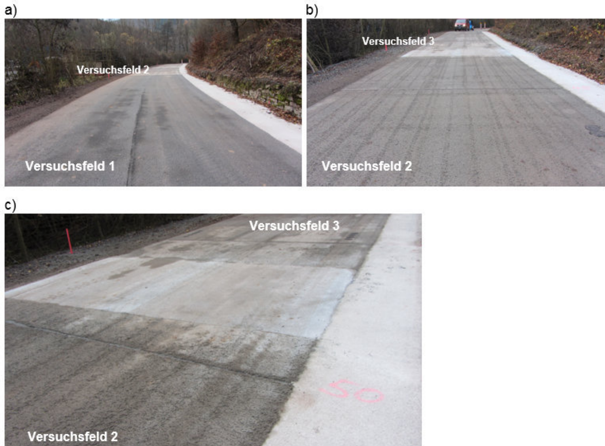
Bild 5.5-50: Fotos der Oberflächen der Versuchsfelder. a) Versuchsfeld 1 (Bauweise PMA), b) Versuchsfeld 2 (Bauweise COPS), c) Versuchsfeld 3 (Bauweise COPS)
