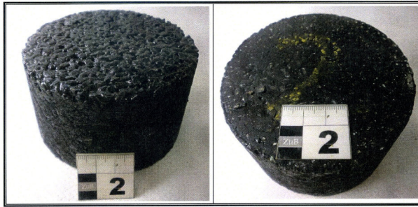
Bild 5.3-27: Beschaffenheit der Oberflächentextur und der Unterseite eines mod. MPK aus Asphaltmischgut PMA 5 der Variante 1 (BS : NS = > 0 : 1)
