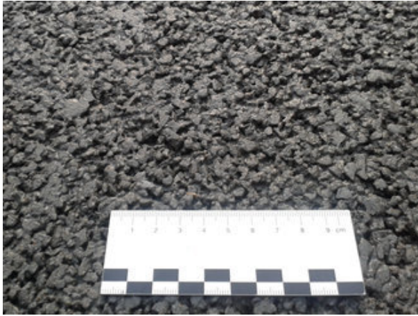
Bild 5.5-67: Fotos der Oberflächen der Versuchsfelder an ausgewählten Stellen. a) b) Versuchsfeld mit Mischgutvariante V3/8 bei m +25,0; c) d) Versuchsfeld mit Mischgutvariante V4/1 bei m 65,0.
