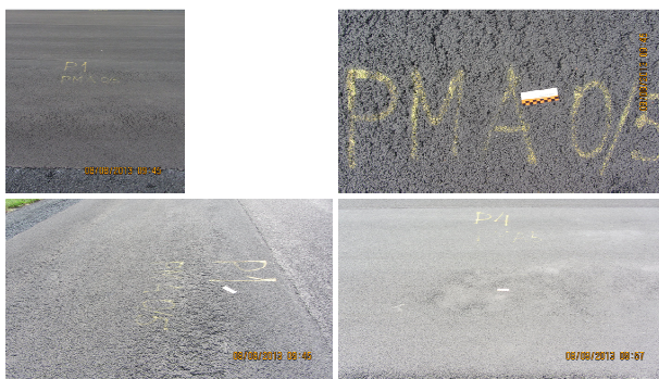
Bild 5.3-41: Fotografien der Oberflächentextur an ausgewählten Stellen der PMA-Testfelder.
