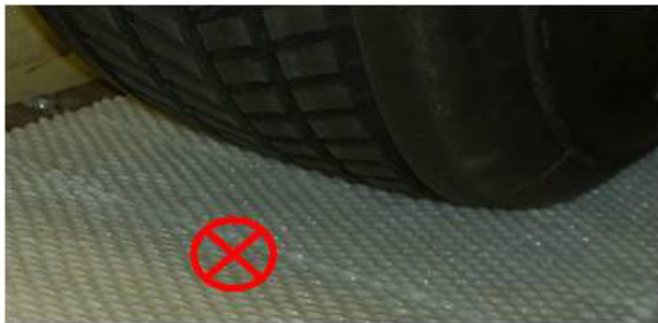
Bild 4.3-28: Anisotrope Fahrbahn mit nach vorne gerichteter Textur und Mikrofonposition
