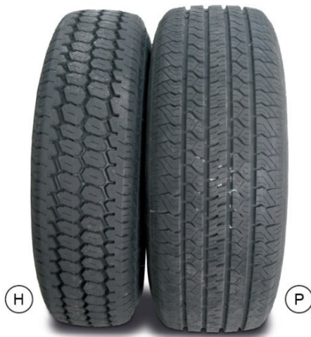
Bild 5.2-39: Verwendete Messreifentypen nach ISO/DIS 11819-2.
