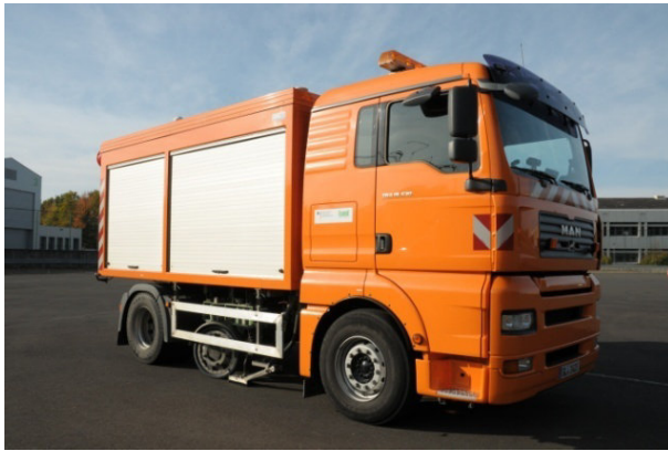
Bild 5.3-14: Seitenkraft-Messverfahren (SKM) der BAST
