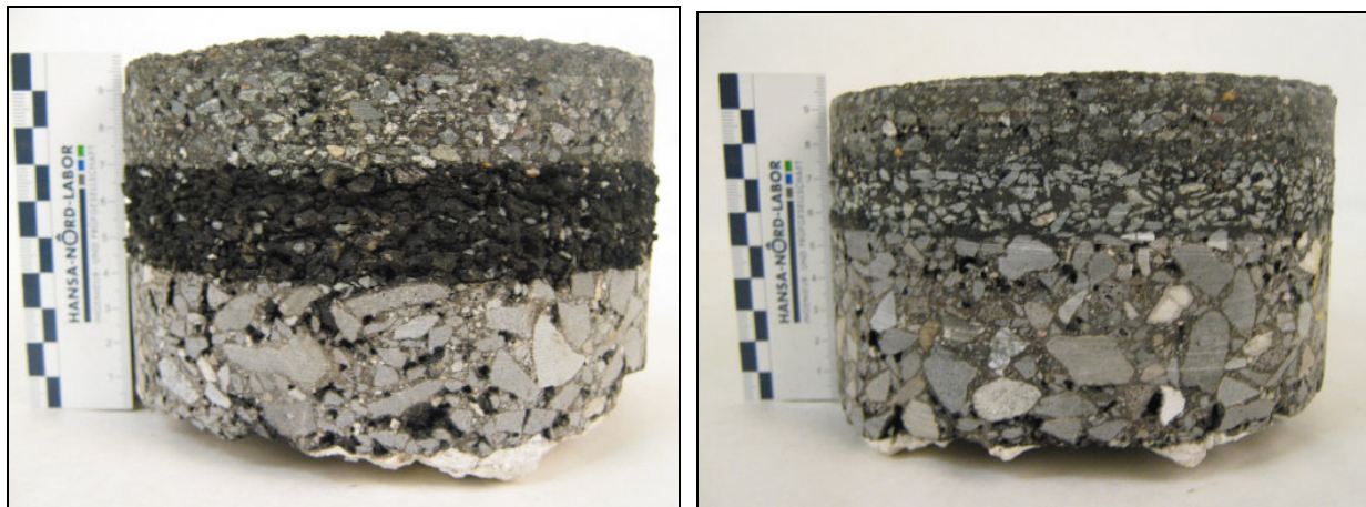
Bild 5.4-31: Bohrkern mit Dämpfungsschicht - Sonderasphalt 26 M.-% GG, Sonderasphalt IA 5 – dicht, (von links)
