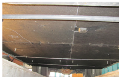
Bild 4.4-12: Aufbau eines absorbierenden Unterbodens auf Basis von LWRT-Sandwichplatten
