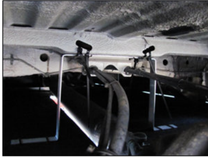
Bild 4.4-94: Anbau des absorbierenden Unterbodens an das Fahrzeug
