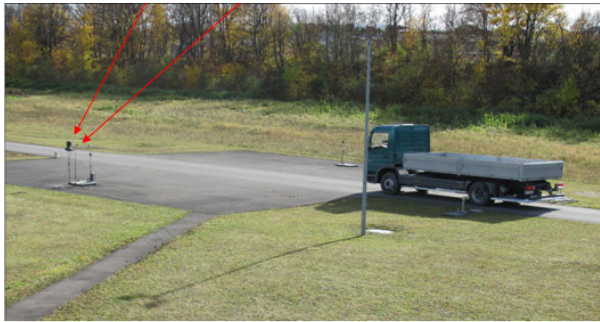
Bild 4.4-13: Messung der Vorbeifahrtspegel auf dem Testgelände TÜV Allach
