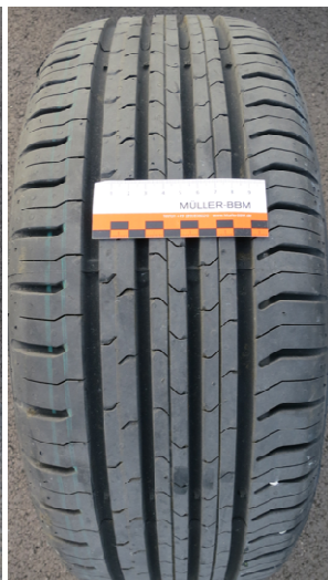
Bild 3.2-48: Fotos der in der ersten Messkampagne verwendeten Reifen für die Kontrollierten Vorbeifahrtmessungen
