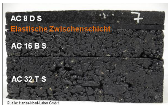
Bild 5.4-20: Schichtsystem mit elastischer Zwischenschicht
