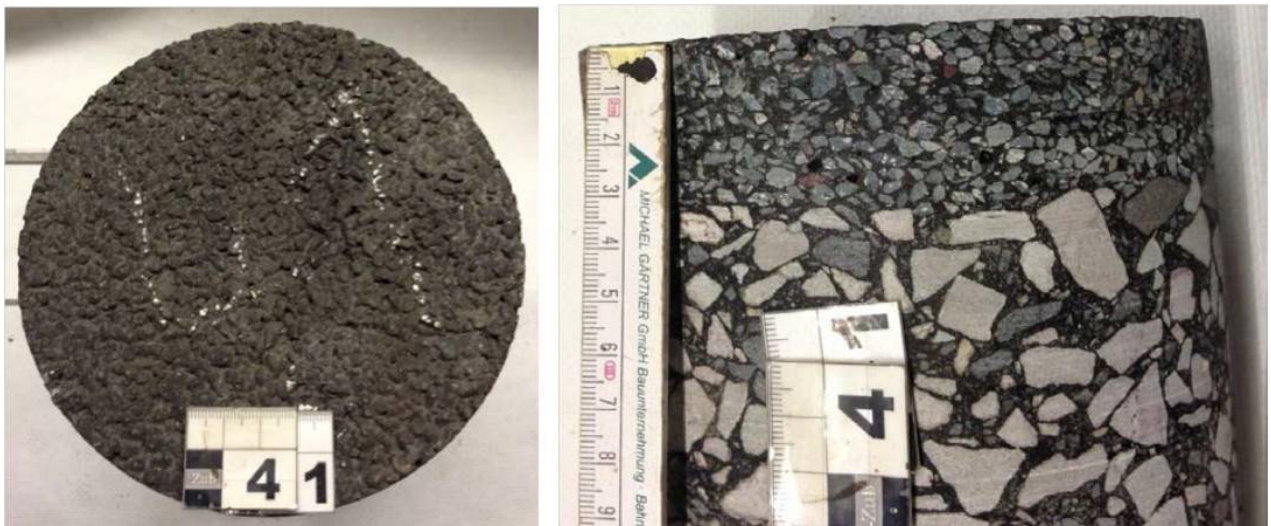
Bild 5.3-66: Beschaffenheit der Asphaltdeckschicht PMA 5 des Bohrkerns BK1 (im Bild 41) bei einem Hohlraumgehalt von 6,0 Vol.-%
