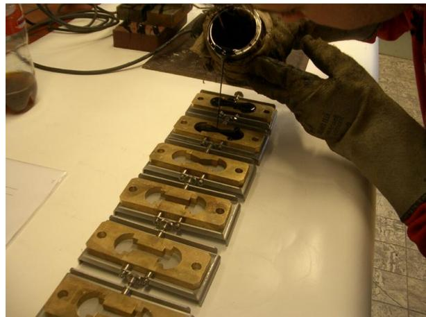
**Bild 15:** Herstellung der Proben für die Kraftduktilitätsprüfung
