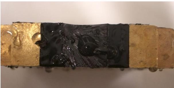
**Bild 92:** Brüche bei Verwendung der Probekörperform mit verjüngtem Steg und der Prüfung von PmB mit hoher Viskosität bei 5°C
