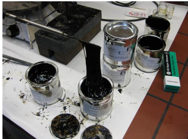
**Bild 93:** Ausvulkanisierte Probe einer PmOB
