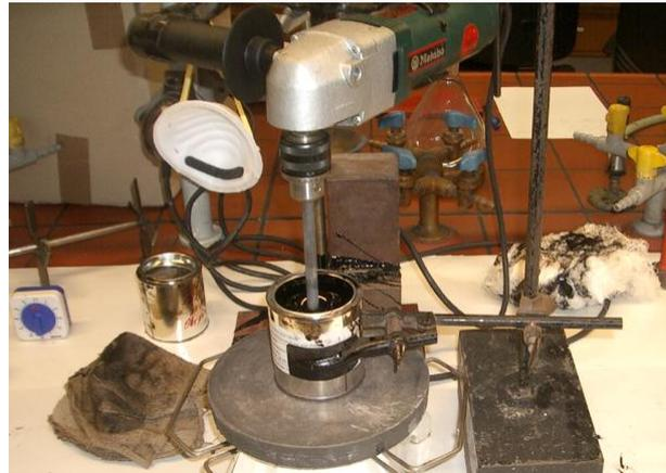
**Bild 14:** Homogenisierung der Proben – Dosen
