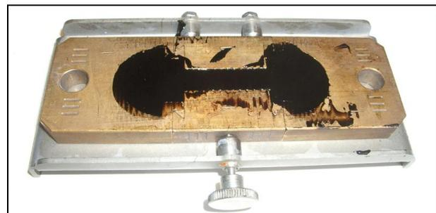
**Bild 9:** Fertig vorbereiteter Probekörper für die Prüfung (DIN EN 13589)
