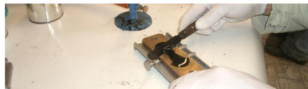
**Bild 8:** Entfernen der überschüssigen Bitumenmenge (Probekörperform gemäß DIN EN 13398 mit verjüngtem Steg)
