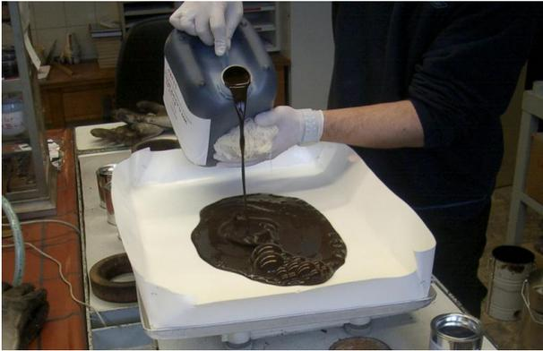
**Bild 20:** Aufgießen der Bitumenemulsion
