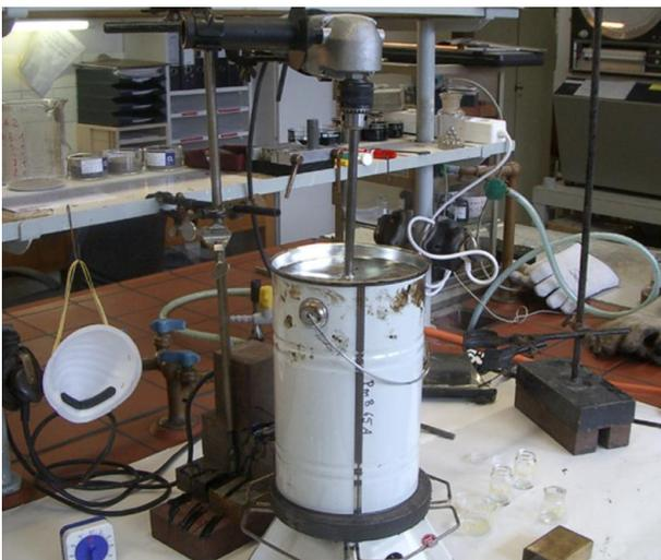
**Bild 13:** Homogenisierung der Proben – Bitumeneimer
