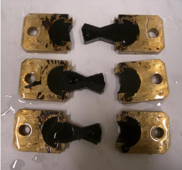
**Bild 91:** Brüche bei Verwendung der Probekörperform mit verjüngtem Steg und der Prüfung von PmB mit hoher Viskosität bei 5°C
