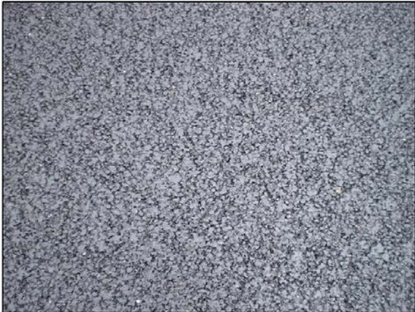
Abbildung 4-65: An der Oberfläche des SMA 8 Hmb. mit R1 sind kleine weiße Steine zu sehen.
