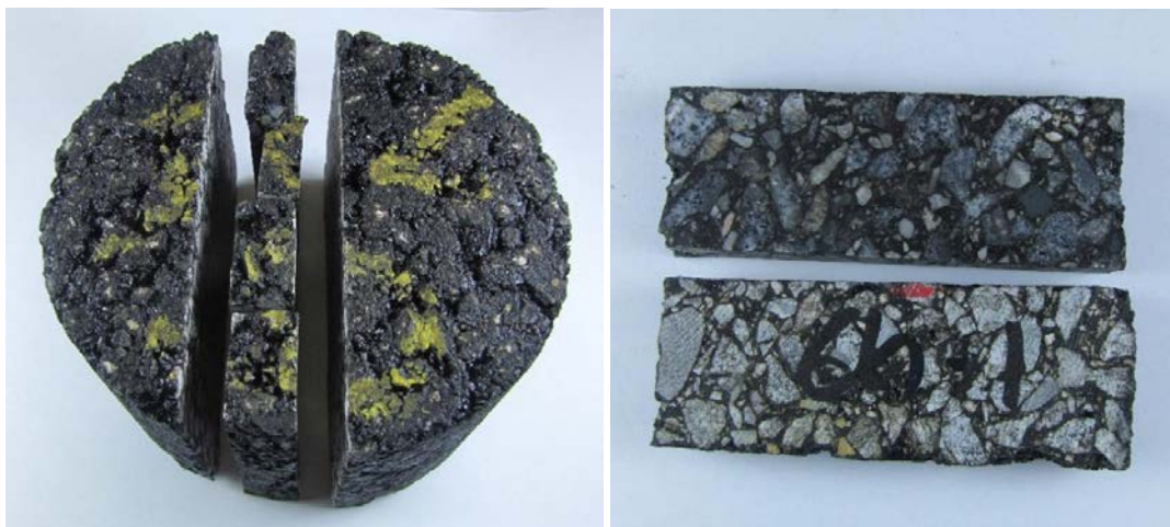
Bild 4-8: Marshall-Probekörper nach dem Sägen, rechts: Asphalt-Scheibe vor (unten) und nach (oben) dem Schleifen
