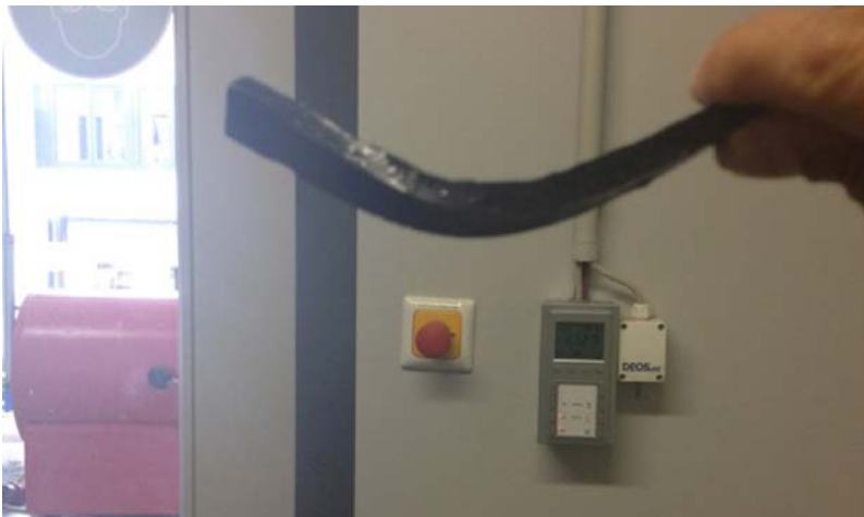
Bild 5-25: Biegebalken des Gemisches 4.1 unmittelbar nach Prüfung bei -25 °C
