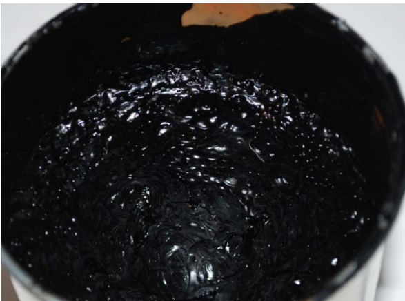
Bild 5-34: Oberfläche des rückgewonnenen AG 9
