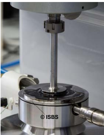
Abbildung 3-15: Dynamisches Scherrheometer (DSR) mit Prüfgeometrie eines Platte-Platte-Mess-Systems mit einem Plattendurchmesser von 25 mm für den Temperaturbereich von +20 °C bis +90 °C.
