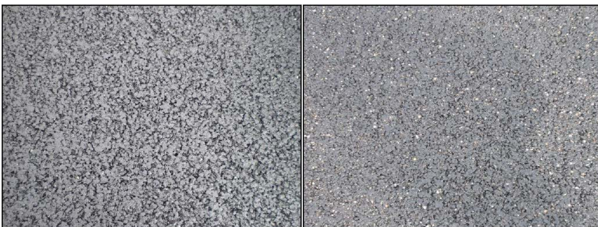
Abbildung 4-68: Oberfläche des SMA 8 Hmb. mit R8 nach Walzverdichtung.
