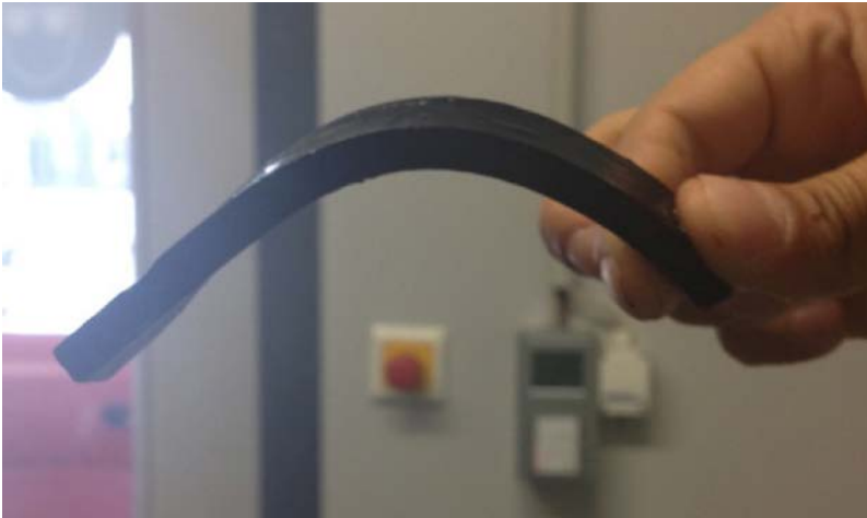
Bild 5-24: Biegebalken des Gemisches 4.2 unmittelbar nach Prüfung bei -25 °C
