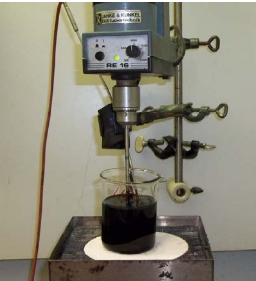
Bild 4-3: Rührvorgang beim Mischen des Straßenbaubitumens mit einem Additiv
