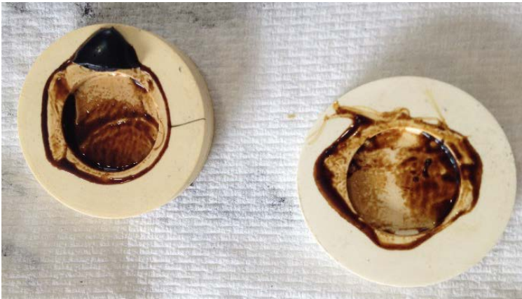
Bild 5-19: Zur Herstellung von DSR-Proben des Gemischs 4.7 genutzte Silikonformen
