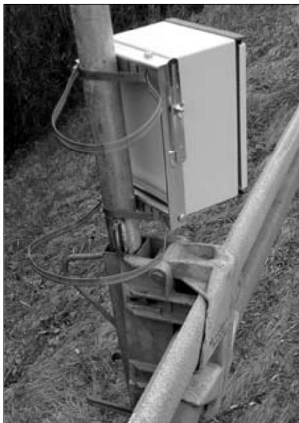
**Bild 16:** Montiertes Radargerät
