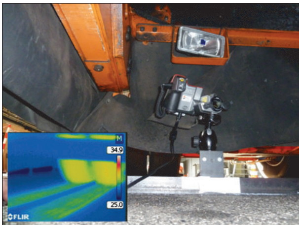
Bild 3-8: Position – Infrarotkamera (IR) auf Räder vorne
