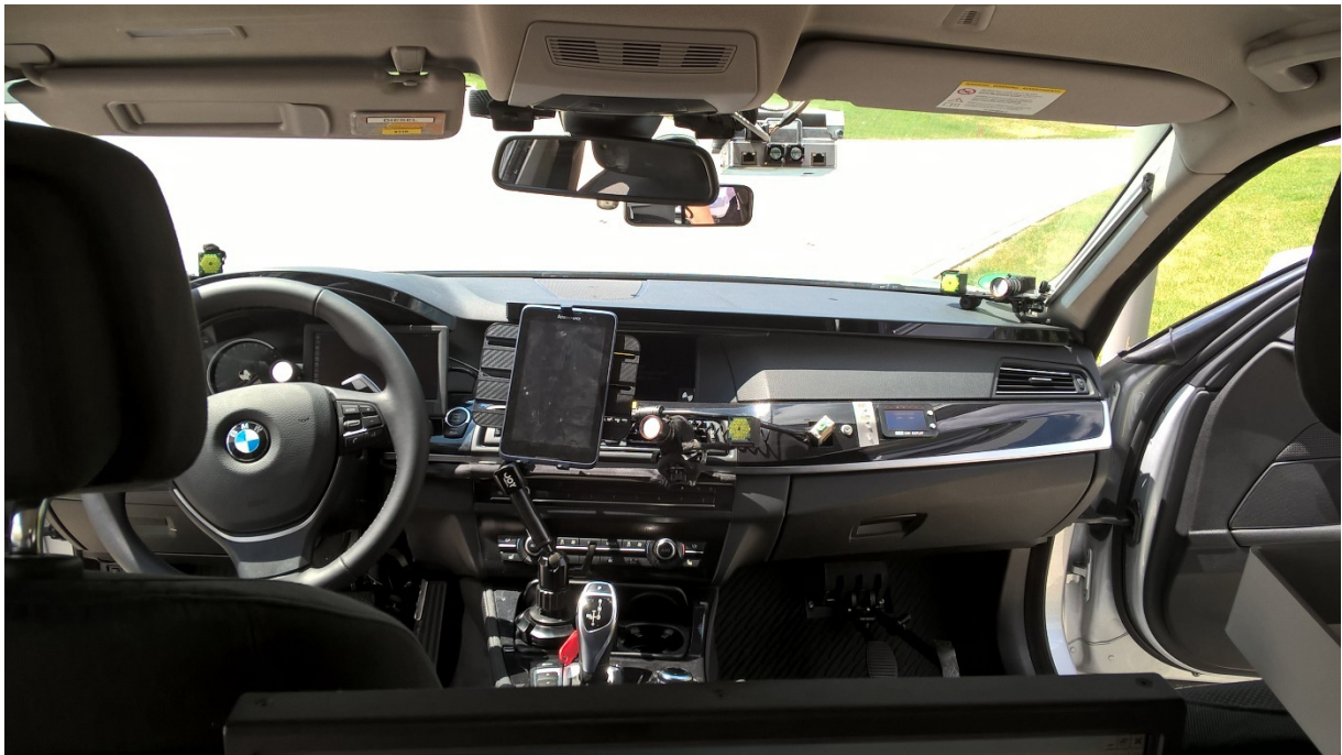
Abbildung 6-1: Innenraum des Wizard-of-Oz-Fahrzeugs mit vor dem CID montierten Tablet.
