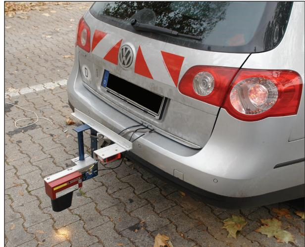
Bild 35: Messapparatur am Messfahrzeug
