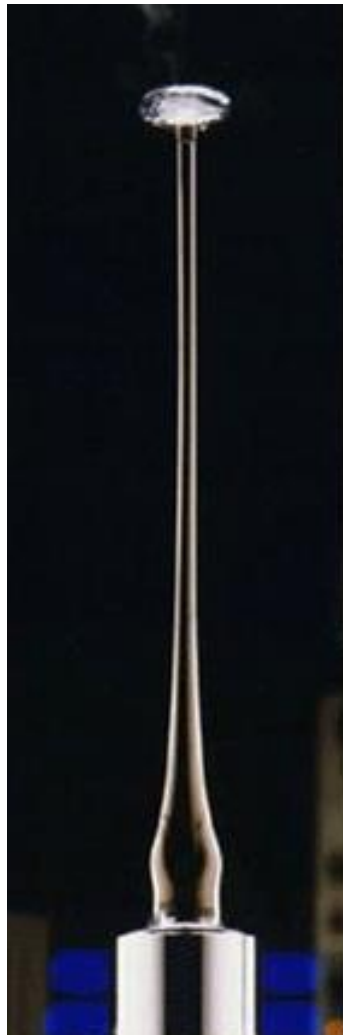
Abb. 4.9: TEOM Sensor mit Filter (Quelle: Ruprecht & Patashnik, Herstellerprospekt)
