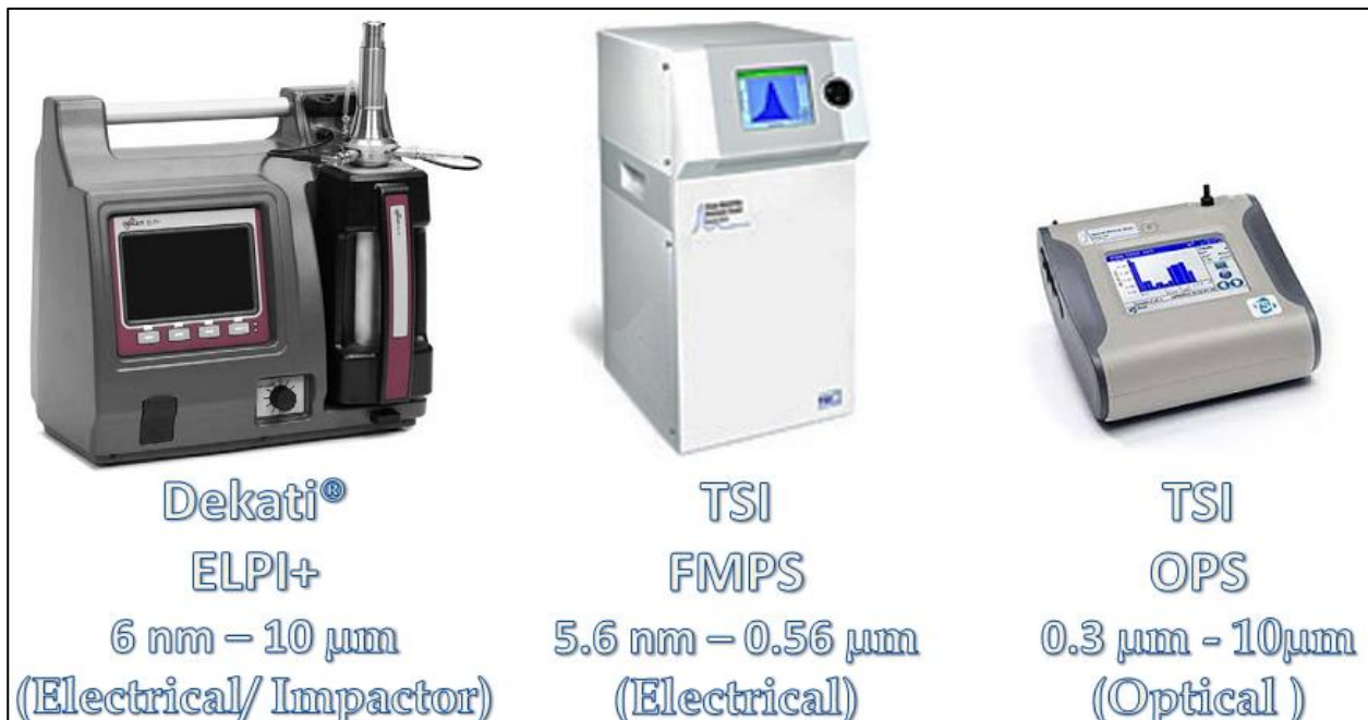
Abb. 5.2: Eingesetzte Messgeräte im REBRAKE-Projekt (Entnommen aus PMP-Dokument 33-07, 2014)
