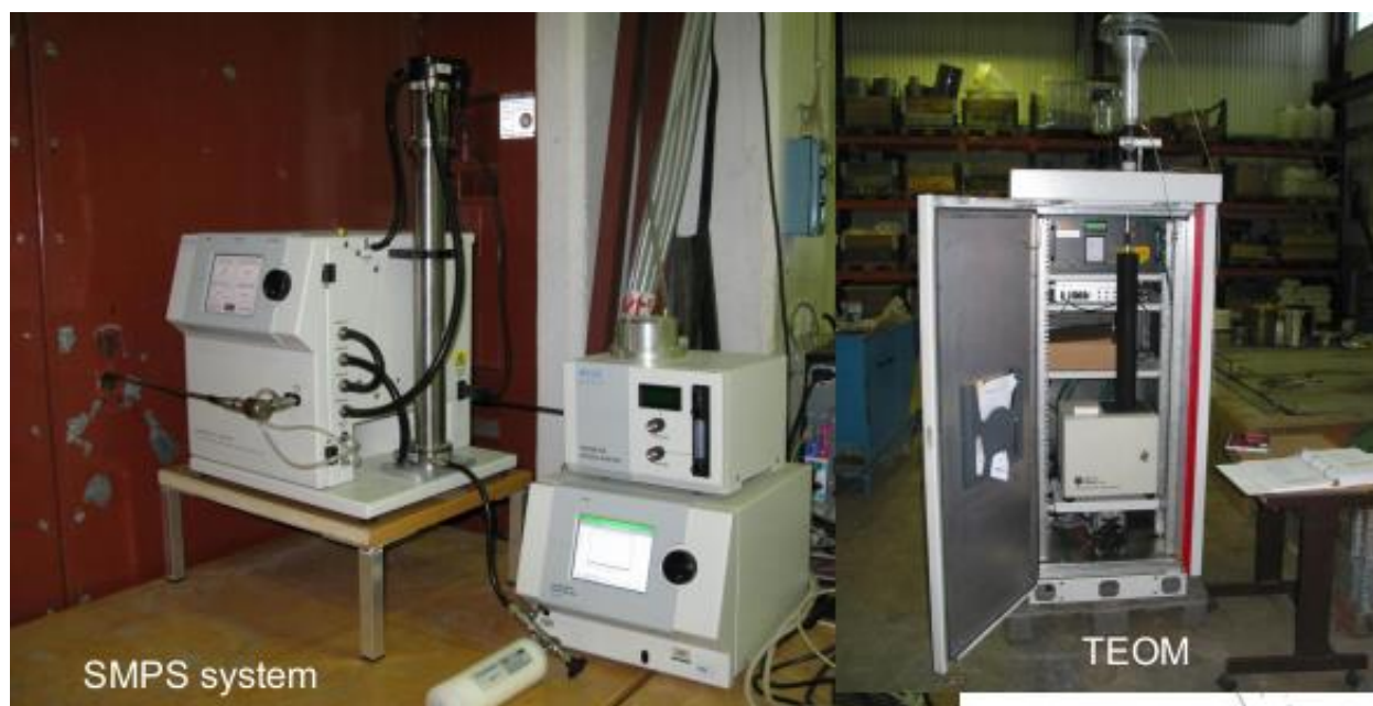
Abb. 3.5: Beispiel für Messtechnik im Road-Simulator (Entnommen aus Gustafsson et al., 2010)
