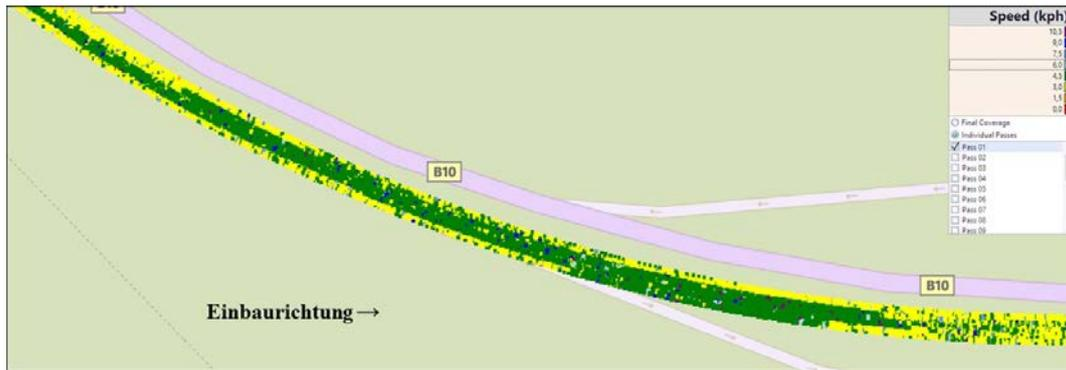
Abb. 9: Walzgeschwindigkeiten der führenden Walze während der ersten Überfahrt bei der Verdichtung der Asphaltdeckschicht im *Testfeld A* [2]
