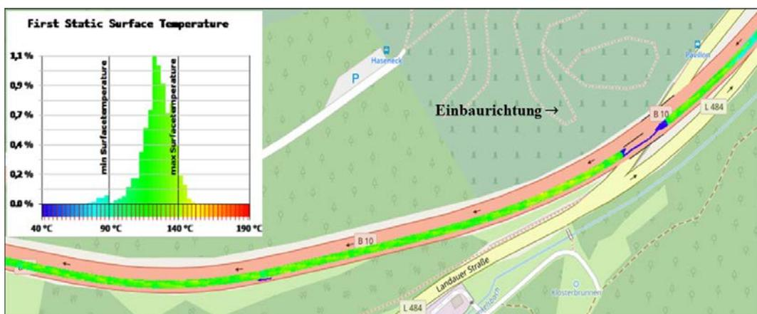
Abb. 18: Temperatur an der Oberfläche der zu verdichtenden Asphaltdeckschicht während des ersten Übergangs der führenden Walze im *Referenzabschnitt* [2]
