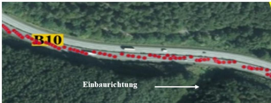
Abb. 22: querneigungsbedingte Änderung des Walzschemas bei der Verdichtung der Asphaltbinderschicht im *Testfeld C* [1]
