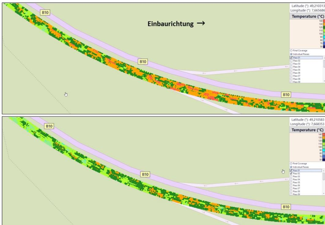
Abb. 20: Temperatur an der Oberfläche der Asphaltbinderschicht im *Testfeld A* während der ersten Fahrt der führenden Walze zum Fertiger hin (oben) und zurück (unten) [2]
