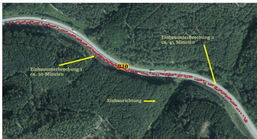
Abb. 23: logistisch bedingte Beeinflussungen des Walzschemas während der Verdichtung der Asphaltbinderschicht im *Testfeld C* [1]
