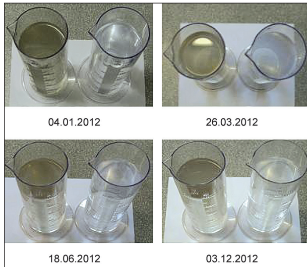
Bild 3-6: Standort Steinsfurt, BAB A 6 – optischer Vergleich des Überstandwassers mit Trinkwasser
