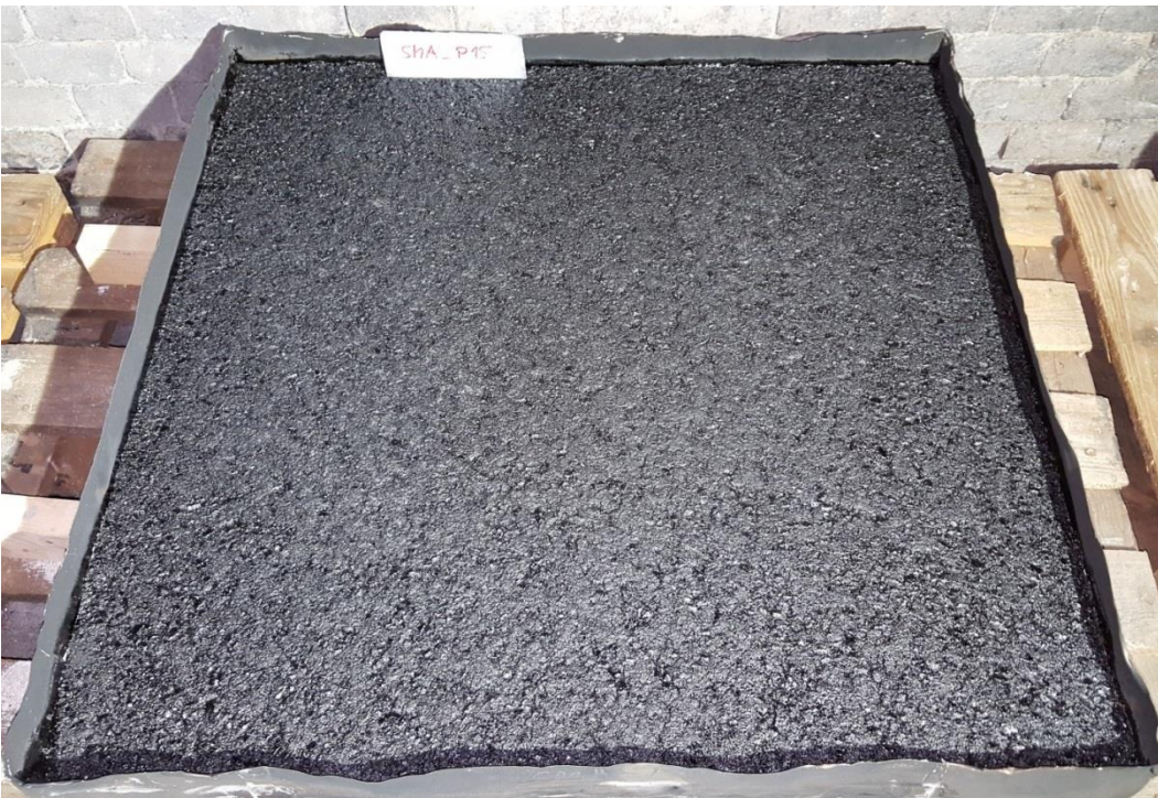
BV 1.2 – SMA - P15: Platte nach Versuchsende
