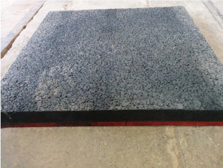
SMA - P11: Platte nach Versuchsende (links), Aufgabebereich (rechts)
