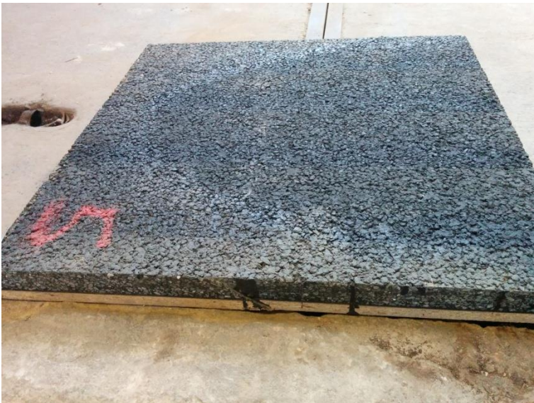
SMA - P5: Platte nach Versuchsende (links), Aufgabebereich (rechts)
