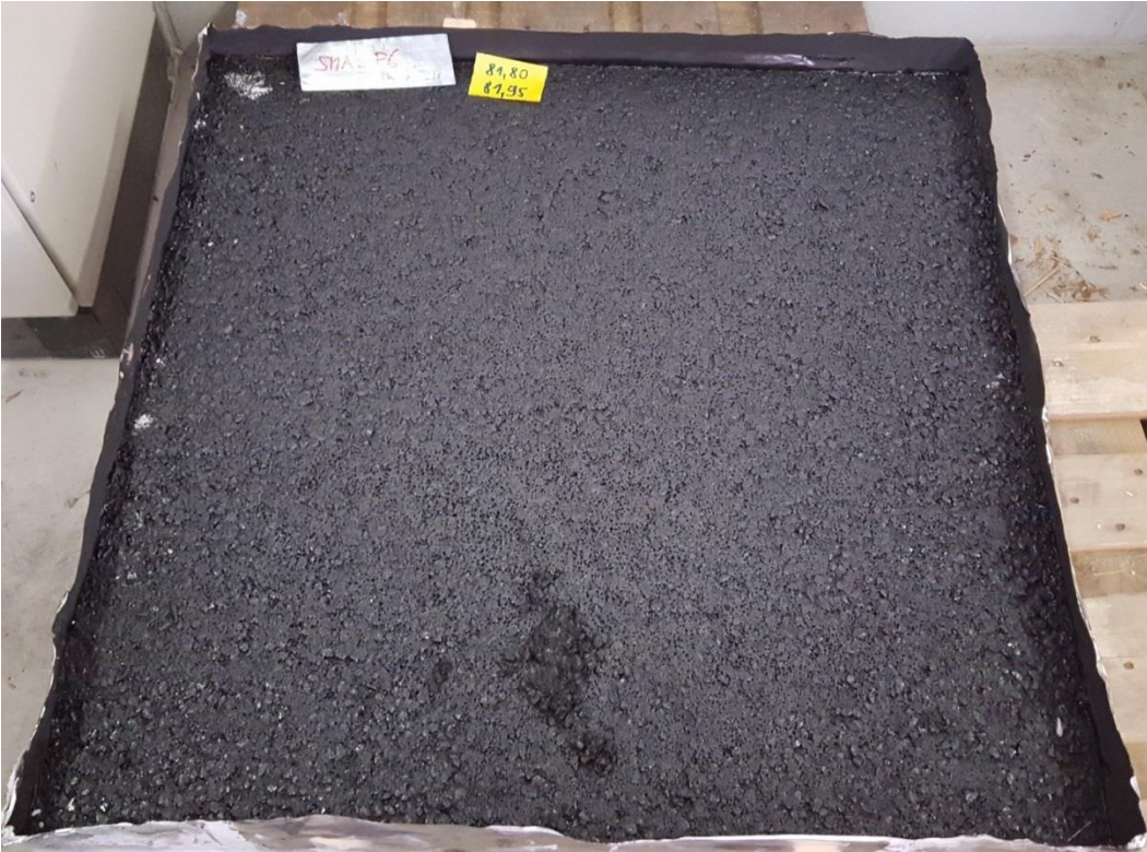
BV 1.1 – SMA - P6: Platte nach Versuchsende
