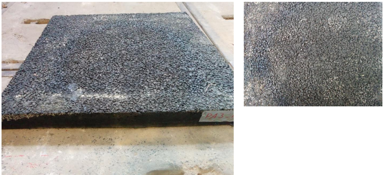
PA 3 - P2: Platte nach Versuchsende (links), Aufgabebereich (rechts)
