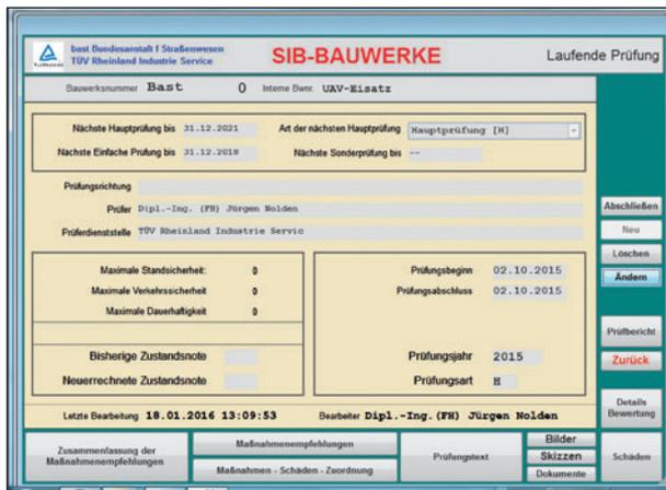
**Bild 69:** 7. Schadensskizzen Möglichkeit 2 – Hinterlegung der Schadensskizzen unter dem Button „Dokumente“ (Markierung). Es können Dateien im doc-, xls-, txt- und PDF-Format hinterlegt werden. Hier wird das 3D-PDF eingefügt
