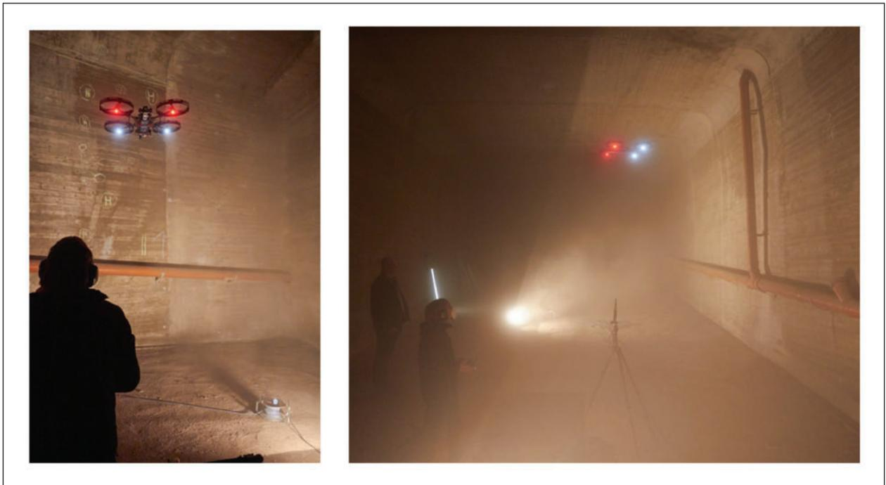
**Bild 55:** Hohlkasten – Enorme Staubentwicklung (ggf. zuvor Reinigung oder Befeuchtung erforderlich um Staubentwicklung entgegen zu wirken). Lärm: etwa 76 dB mit „Straßenverkehrslärm“ und etwa 92 dB bei UAS-Betrieb, Quelle: TÜV Rheinland
