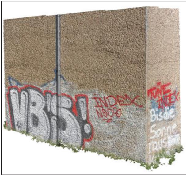
**Bild 22:** 3D-Visualisierung – freigestellte, eigene Ergebnisse aus den fotogrammetrischen Berechnungen der Bild-daten, Quelle: TÜV Rheinland 2015, Software: Agisoft PhotoScan Version 1.2
