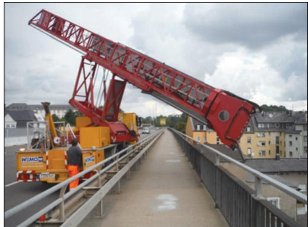
**Bild 58:** Aufbau eines Besichtigungsgerätes (Bühne/Steggerät) auf der Europabrücke. Eine von 4 Richtungsfahrbahnen wird als Aufstellfläche benötigt, Quelle: TÜV Rheinland
