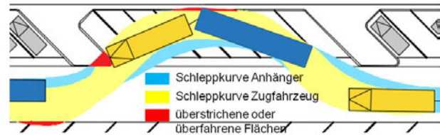
Bild 36: Geänderte Trenninsel bei Pkw-Parkständen (simulierter Parkstand mit gemessener Schleppkurve)
