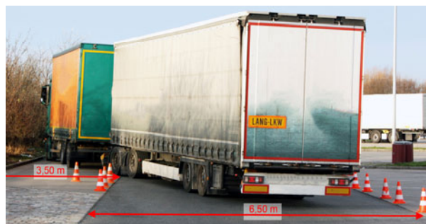
Bild 56: Typ 3 beim Einparken in einen B = 3,50 m breiten Längsparkstand
