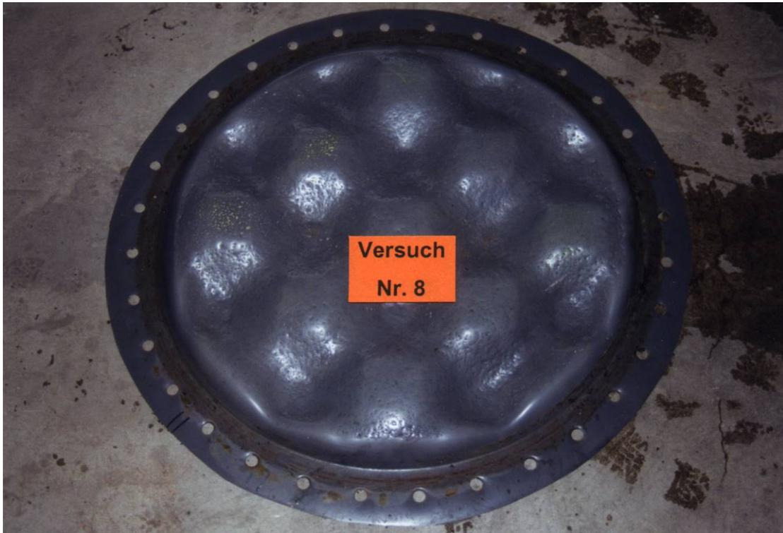
**Foto 5:** Verformte PVC-Bahn (KDB3-PVC-3) mit Eindrückungen nach dem Flächendruckversuch ohne Schutzschicht (Versuch Nr. 8)
