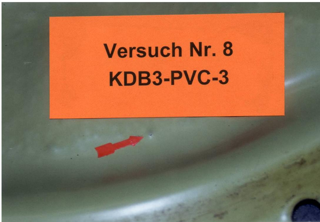
Foto 3: Perforation in der PVC-Bahn (KDB3-PVC-3) (Blick auf die Signalschicht) nach dem Flächendruckversuch ohne Schutzschicht (Versuch Nr. 8)
