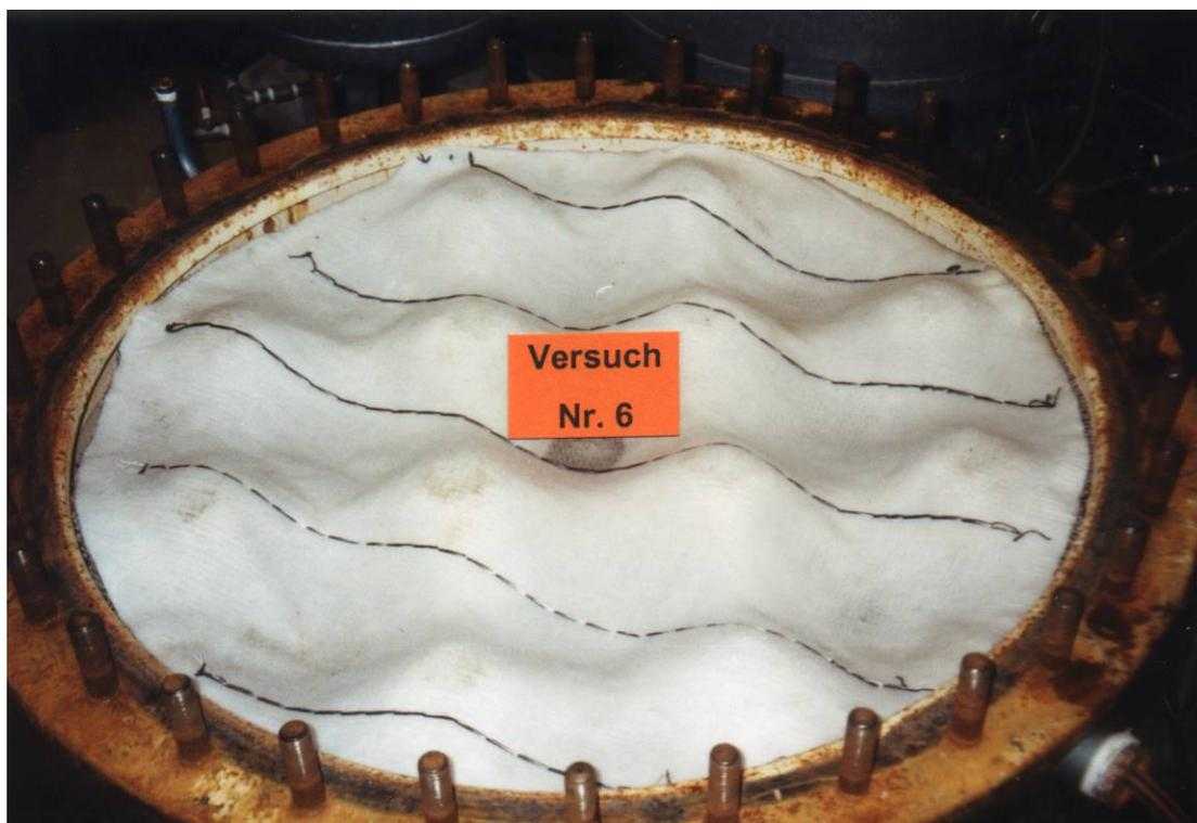
Foto 8: Verformte Dränmatte mit Wirrgelege und Vlieskaschierung (DM2-PP) (Versuch Nr. 6) nach der Flächendruckbelastung
