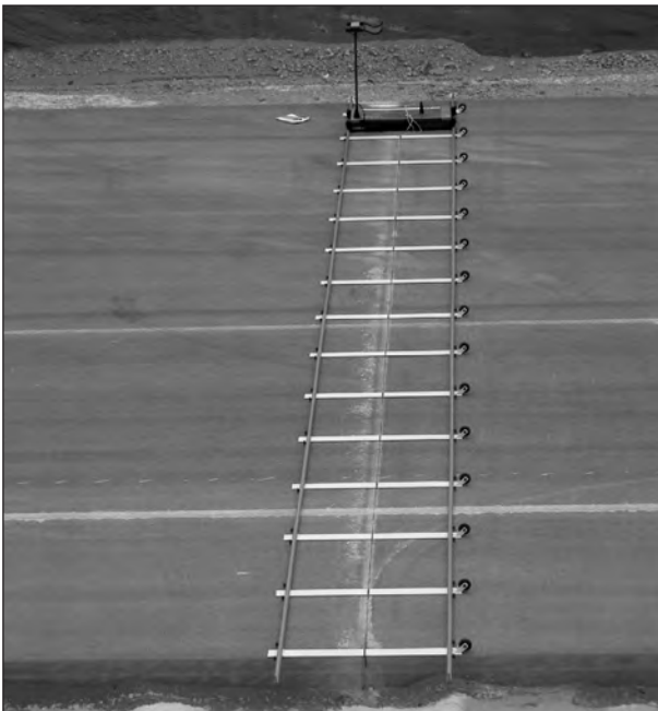
Bild 2: Messgerät zur Messung der Dübellege (Pulsinduktionsverfahren) 2008
