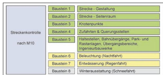
**Bild 33:** Bausteine für eine modulare Durchführung der erweiterten Streckenkontrolle
